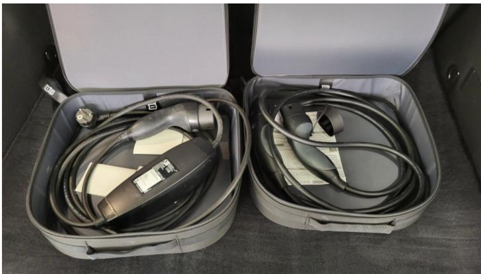
Fot. 37. Przewód ładowania baterii trakcyjnej
