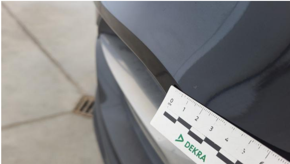
Fot. 43. Zderzak - Rysa/odprysk 1
