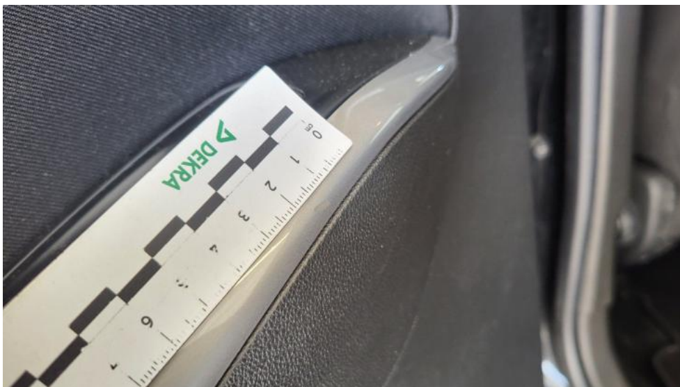
Fot. 65. Tapicerka drzwi tylnych L - Rysa/odprysk 1
