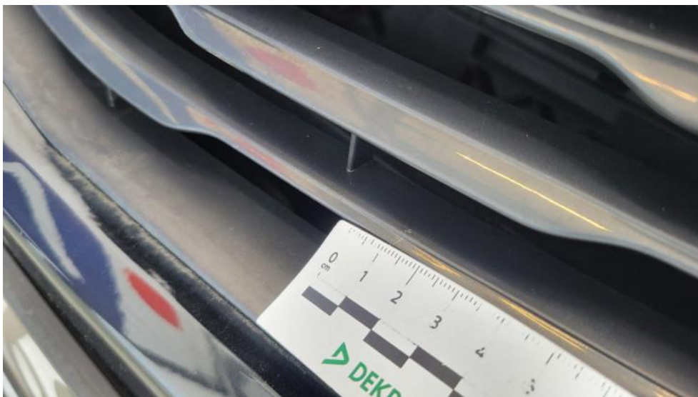
Fot. 39. Krata zderzaka prz. - Rysa/odprysk 1
