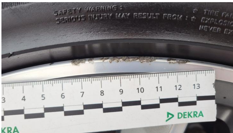
Fot. 60. Felga aluminiowa tylna P - Rysa/odprysk 1
