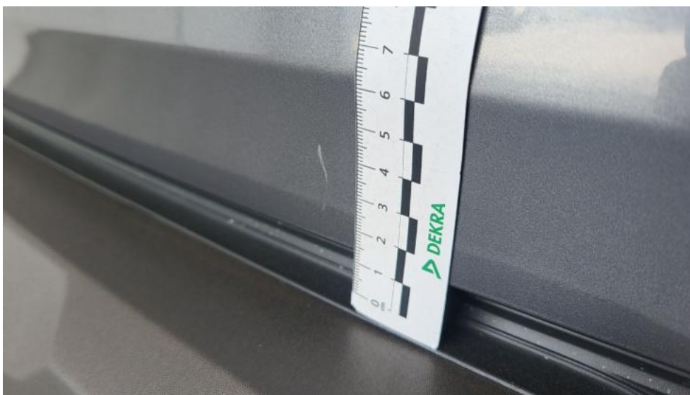
Photo 45. Pokrywy bagażnika - Rysa/odprysk 1
