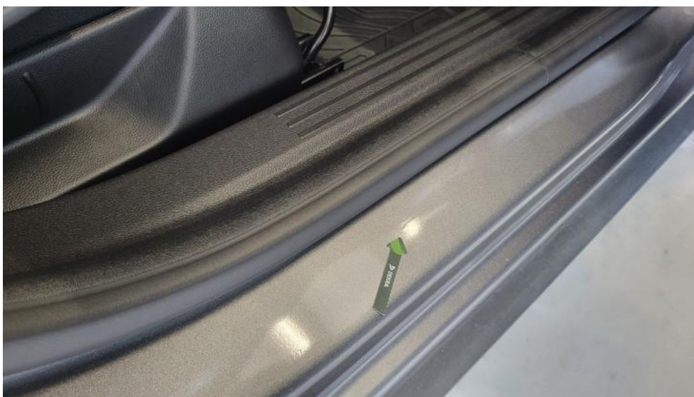
Photo 43. Próg P - Wgniecenie/odkształcenie 1
