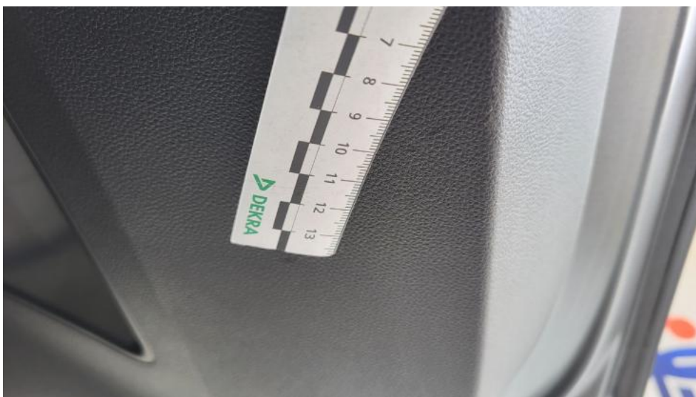
Photo 48. Wykładzina pokrywy tylnej - Rysa/odprysk 1
