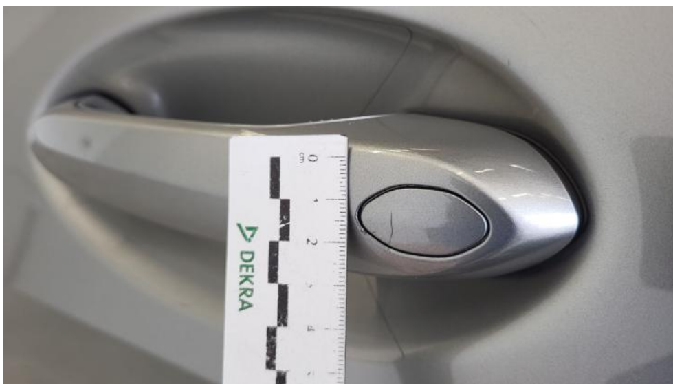
Fot. 68. Klamka drzwi prz L - Rysa/odprysk 1
