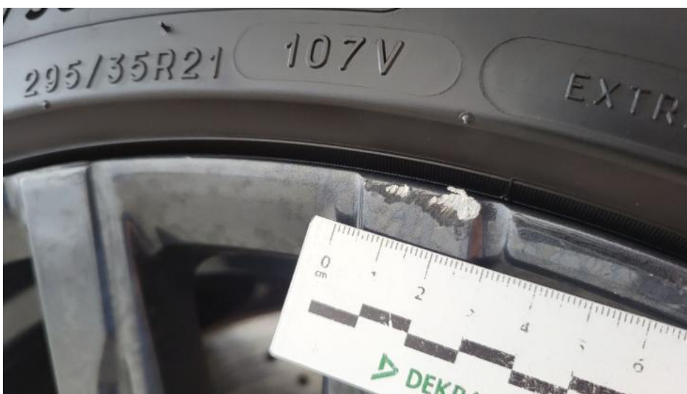
Fot. 50. Felga aluminiowa przednia P - Rysa/odprysk 1
