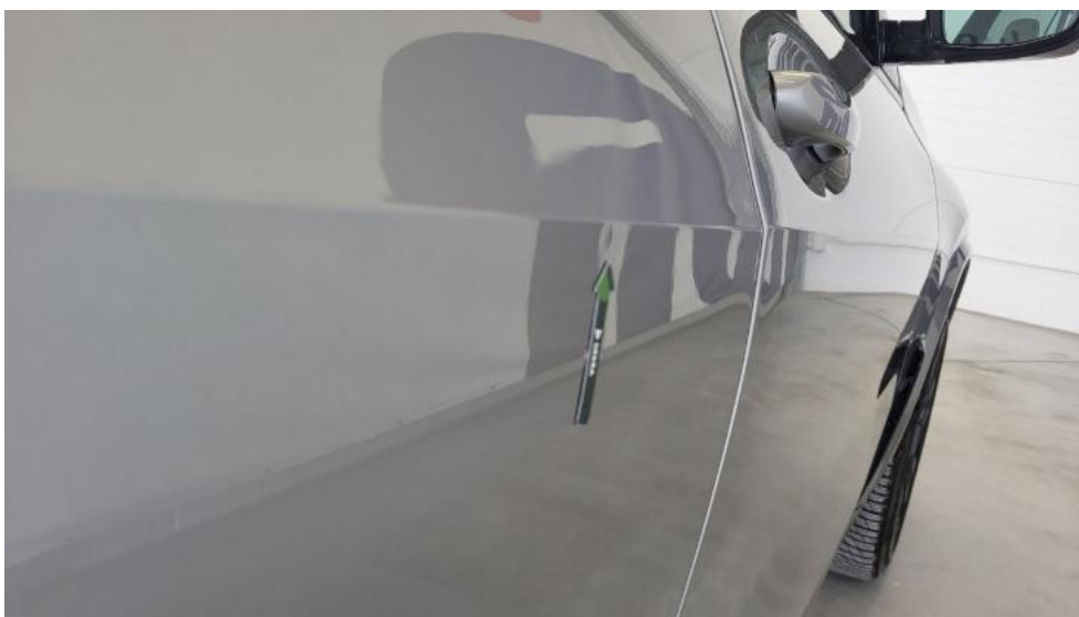
Fot. 53. Drzwi tylne P - Wgniecenie/odkształcenie 1
