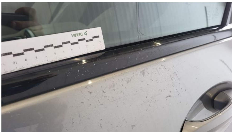
Fot. 69. Listwa drzwi przednich L - Rysa/odprysk 1
