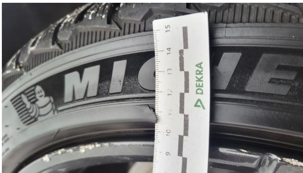
Fot. 57. Opona tylna P - Pęknięcie/rozerwanie 1
