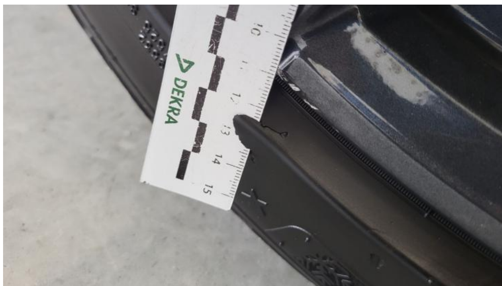
Fot. 51. Opona przednia P - Pęknięcie/rozerwanie 1
