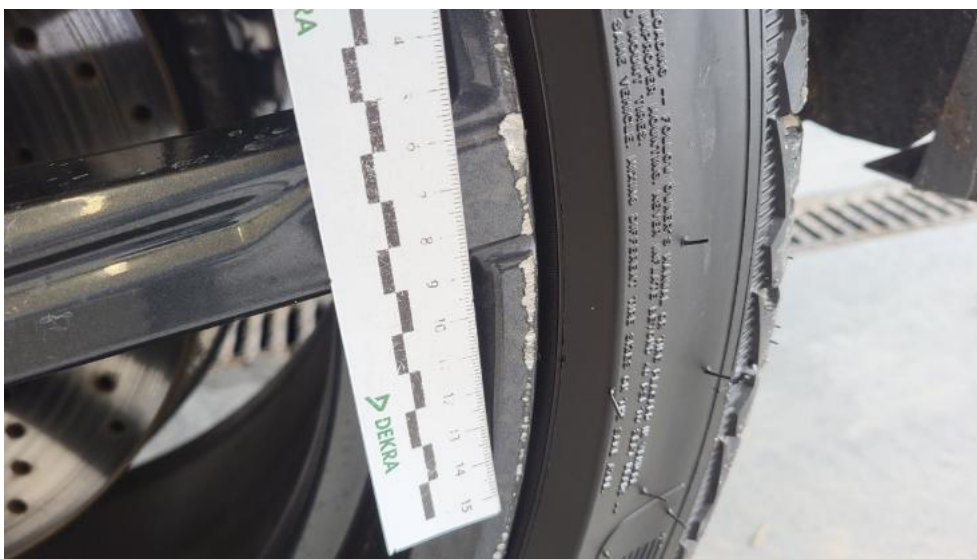
Fot. 59. Felga aluminiowa tylna L - Rysa/odprysk 1
