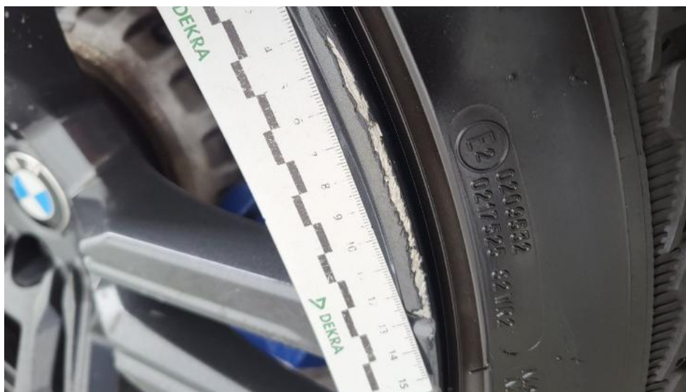
Fot. 55. Felga aluminiowa tylna P - Rysa/odprysk 1
