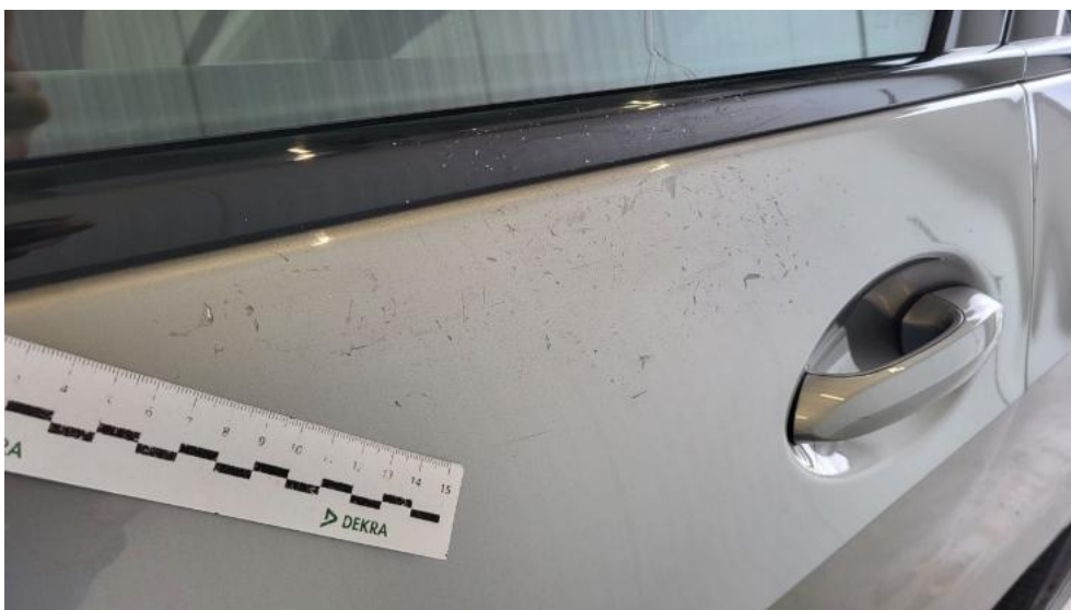
Fot. 62. Drzwi przed L - Rysa/odprysk 1
