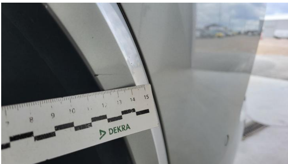
Fot. 60. Listwa krawędzi błotnika tył L - Rysa/odprysk 1
