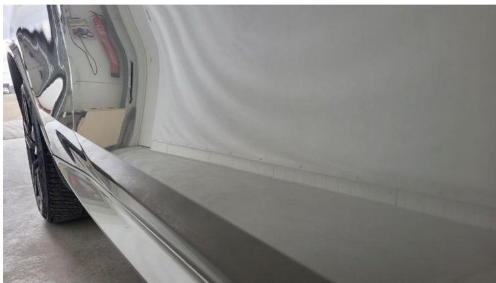
Fot. 52. Drzwi przednie P - Wgniecenie/odkształcenie 1
