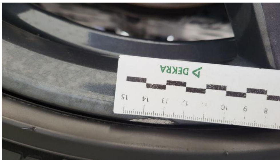
Fot. 73. Felga Aluminiowa przednia L - Rysa/odprysk 1
