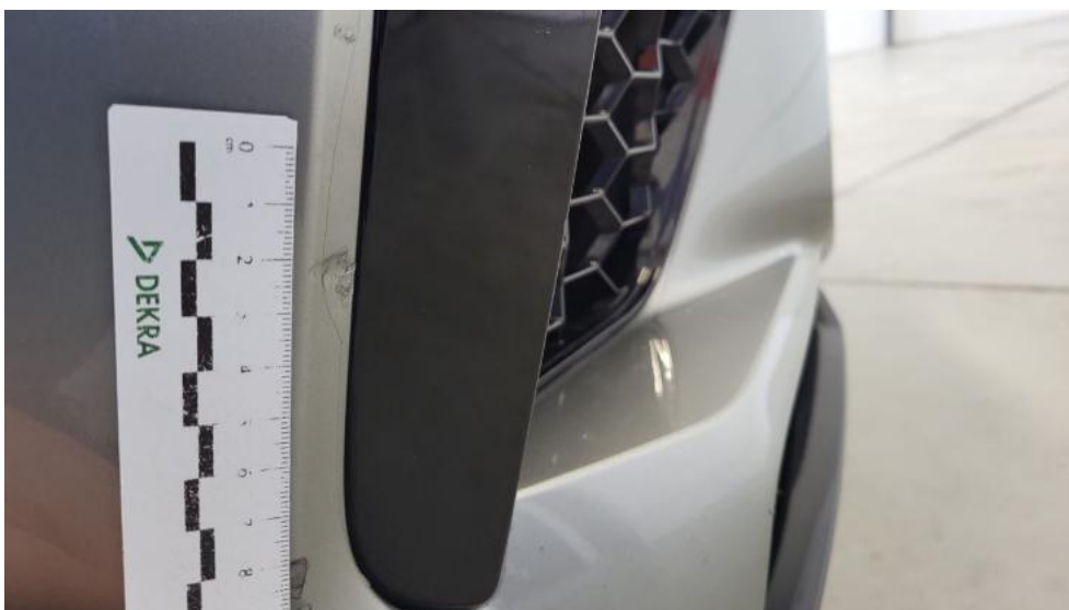
Fot. 48. Zderzak - Wgniecenie/odkształcenie 1
