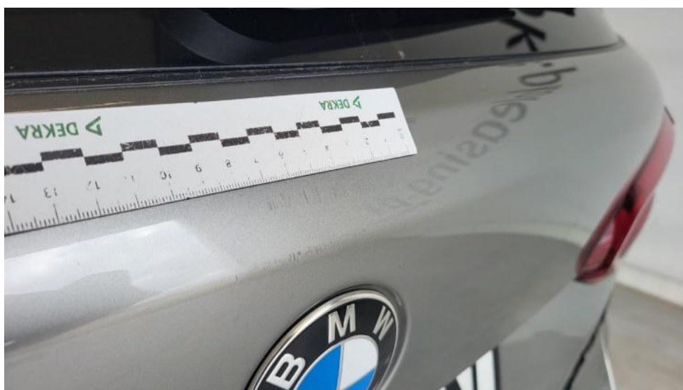
Fot. 58. Pokrywy bagażnika - Rysa/odprysk 1
