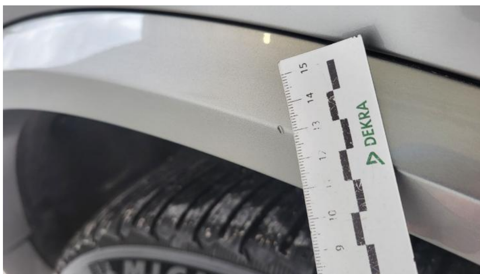
Fot. 56. Listwa krawędzi błotnika tył P - Rysa/odprysk 1
