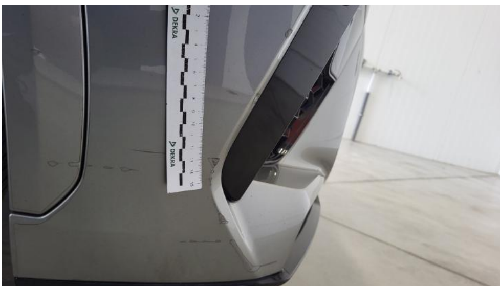
Fot. 47. Zderzak - Rysa/odprysk 1
