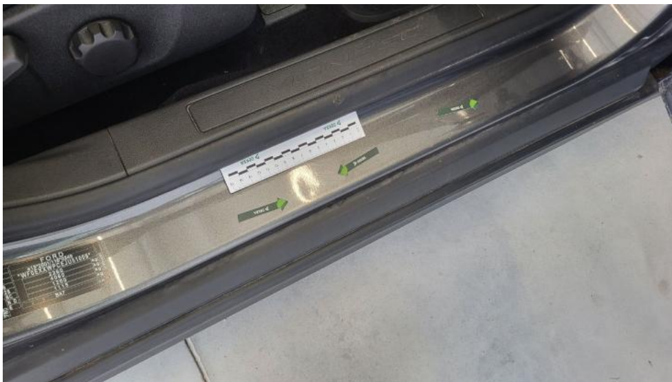
Photo 61. Próg P - Wgniecenie/odkształcenie 1
