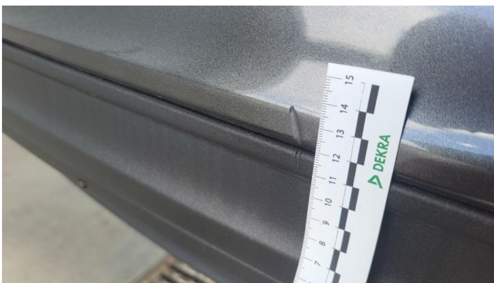
Photo 72. Zderzak tylny cz dolna - Rysa/odprysk 1
