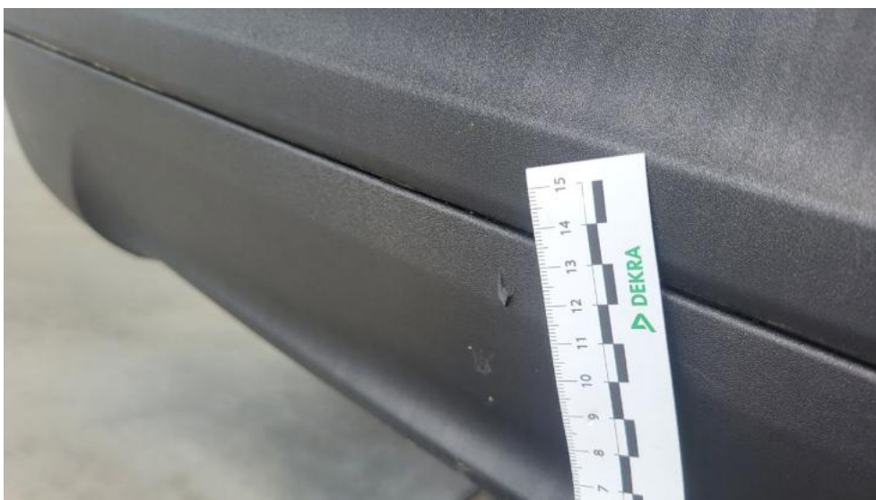
Photo 68. Spojler zderzaka tylnego - Rysa/odprysk 1
