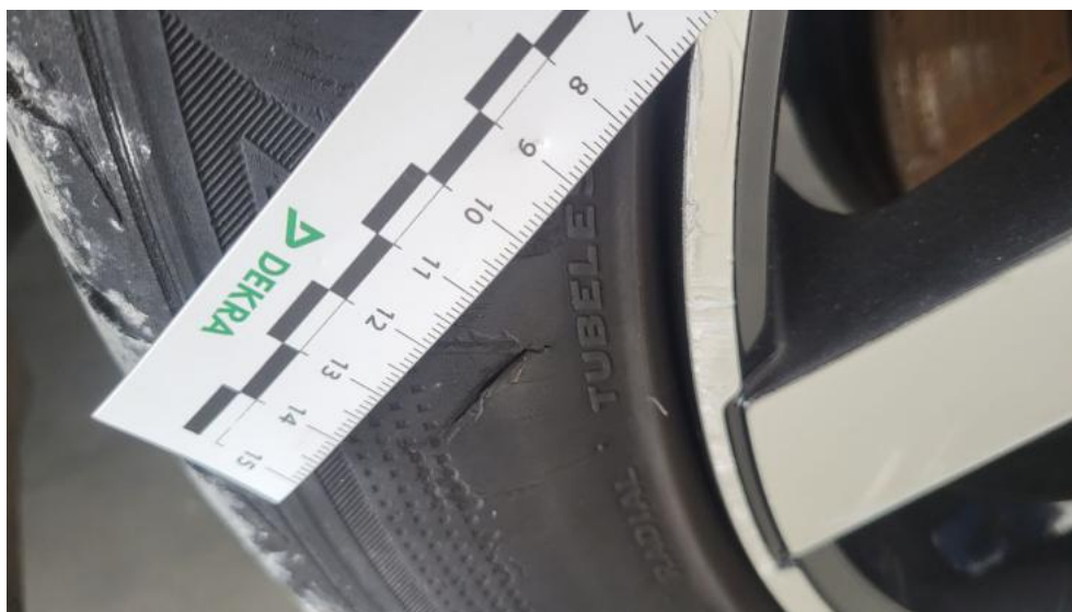
Photo 55. Opona przednia P - Pęknięcie/rozerwanie 1
