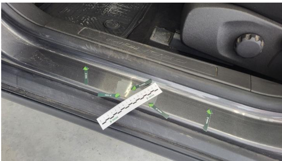
Photo 85. Próg L - Wgniecenie/odkształcenie 2
