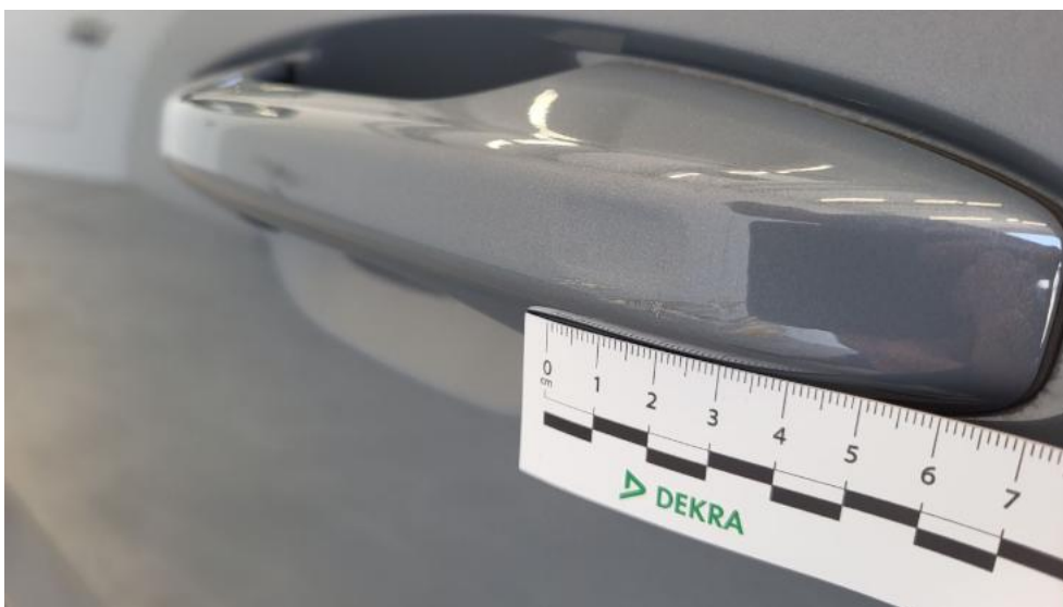
Fot. 56. Klamka drzwi prz L - Rysa/odprysk 1
