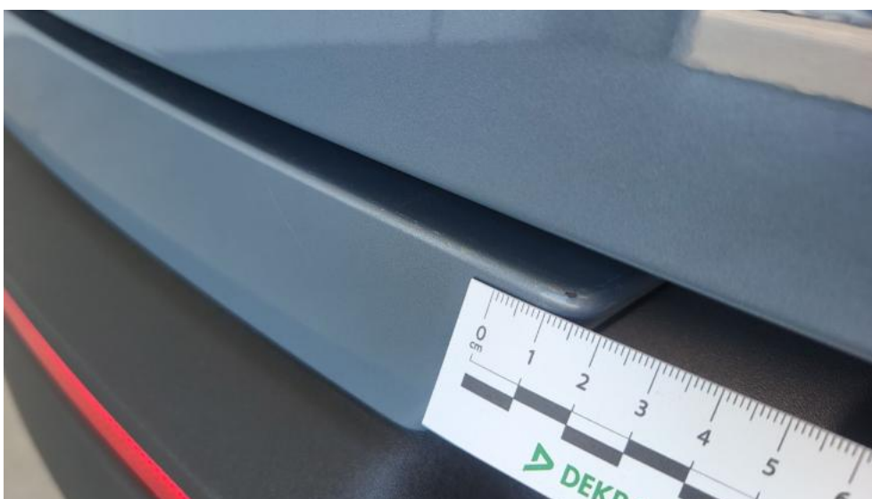
Fot. 50. Zderzak tylny cz L - Rysa/odprysk 1
