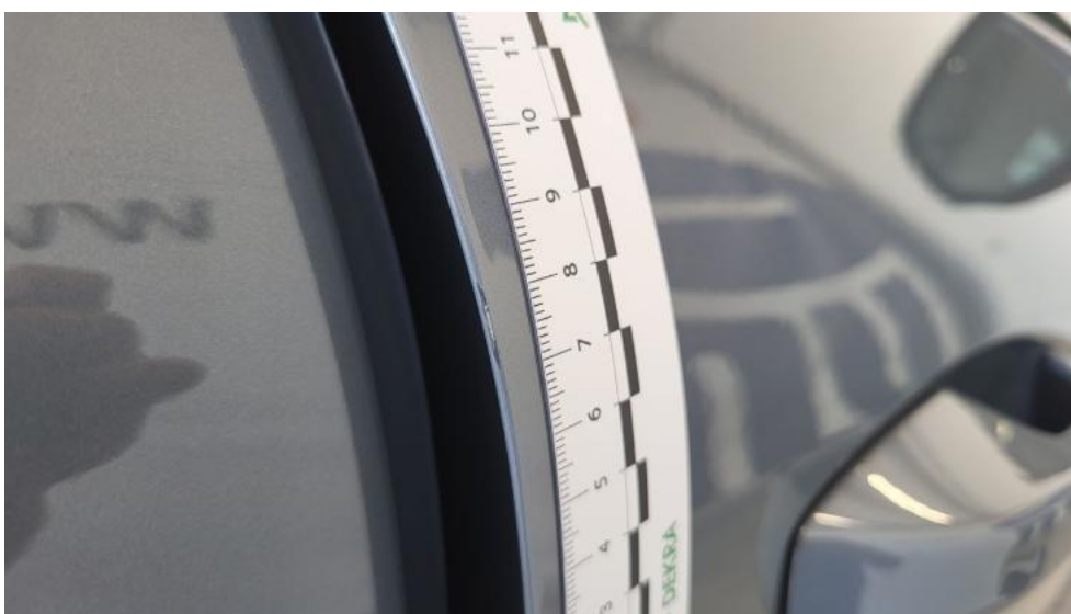
Fot. 46. Drzwi przednie P - Rysa/odprysk 1
