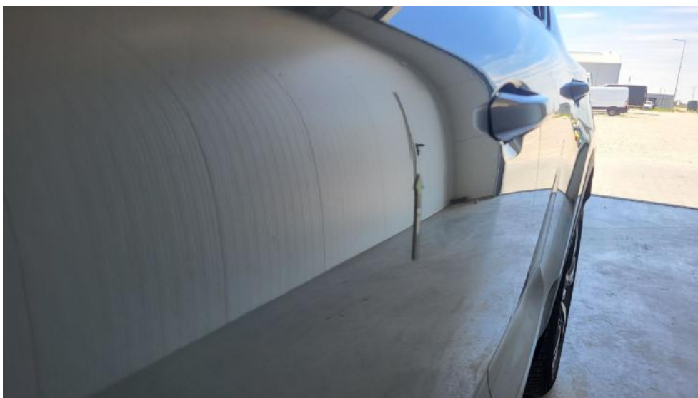
Fot. 54. Drzwi przed L - Wgniecenie/odkształcenie 1
