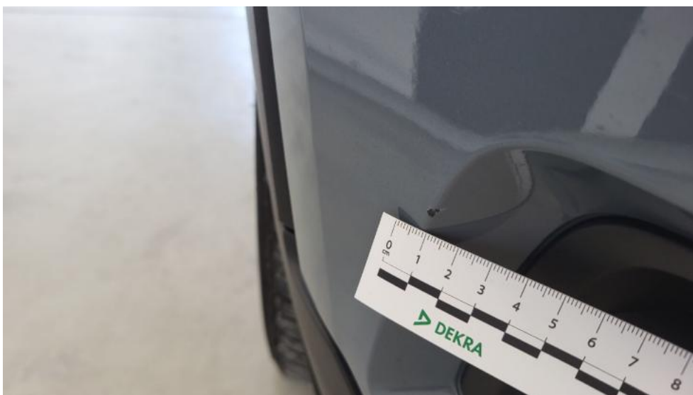
Fot. 44. Zderzak - Rysa/odprysk 1
