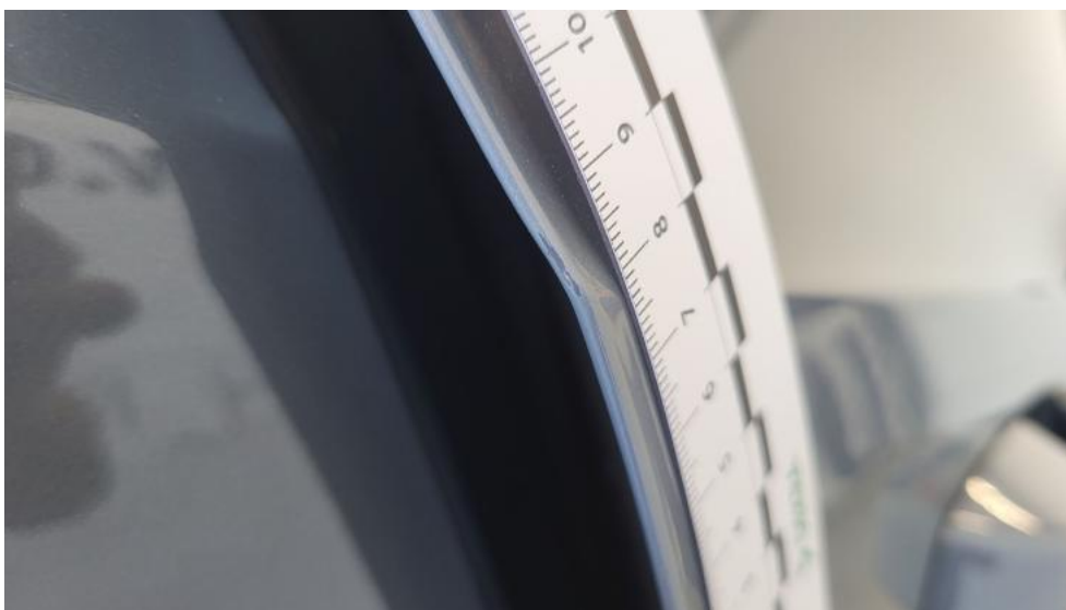
Fot. 47. Drzwi tylne P - Rysa/odprysk 1
