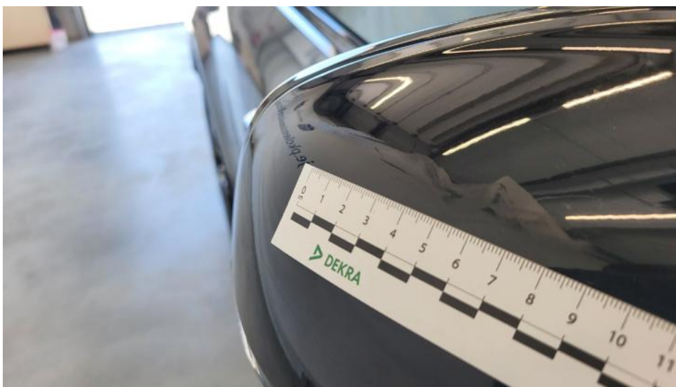
Fot. 49. Lusterko zew P - Rysa/odprysk 1
