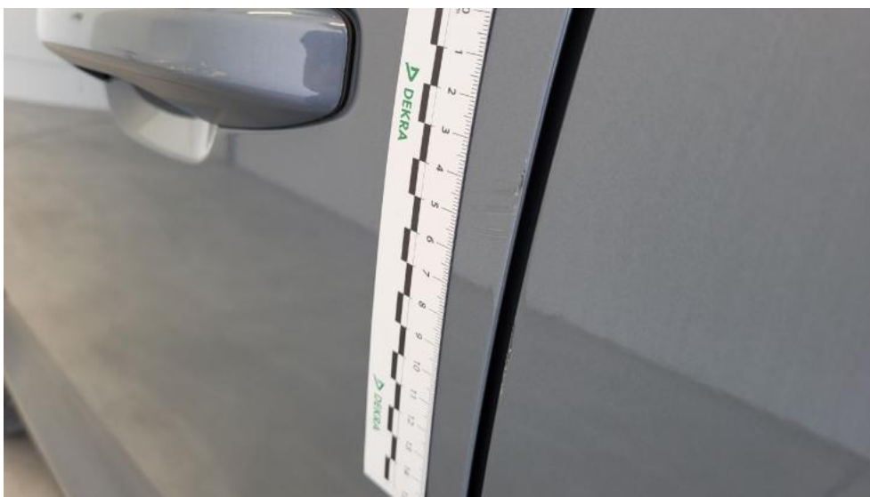
Fot. 53. Drzwi przed L - Rysa/odprysk 1
