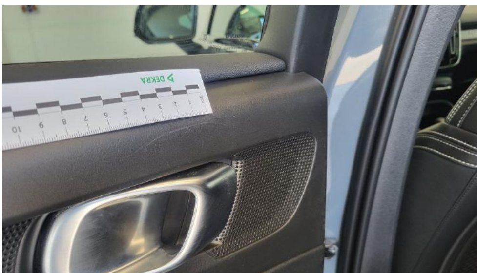
Fot. 64. Tapicerka drzwi tylnych L - Rysa/odprysk 1
