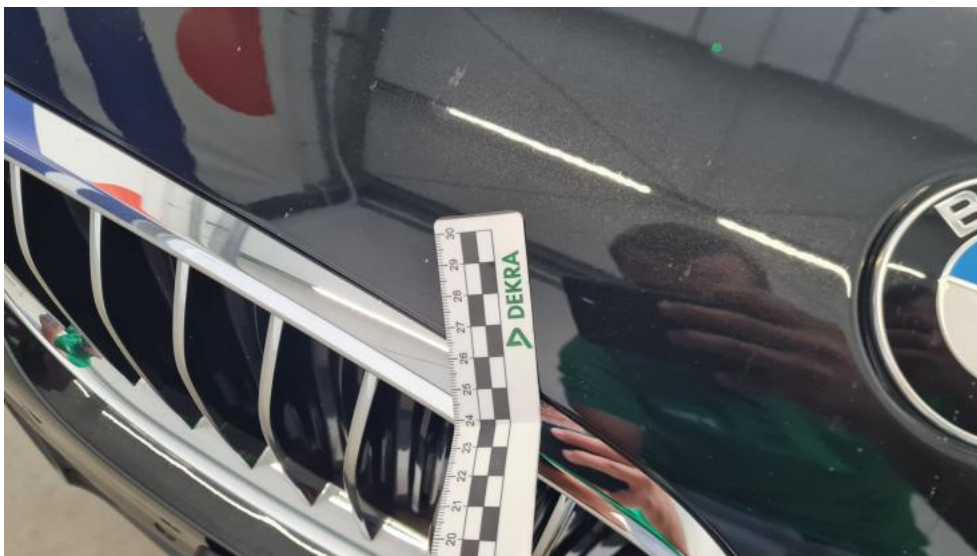
Photo 43. Pokrywa komory silnika - Rysa/odprysk 1
