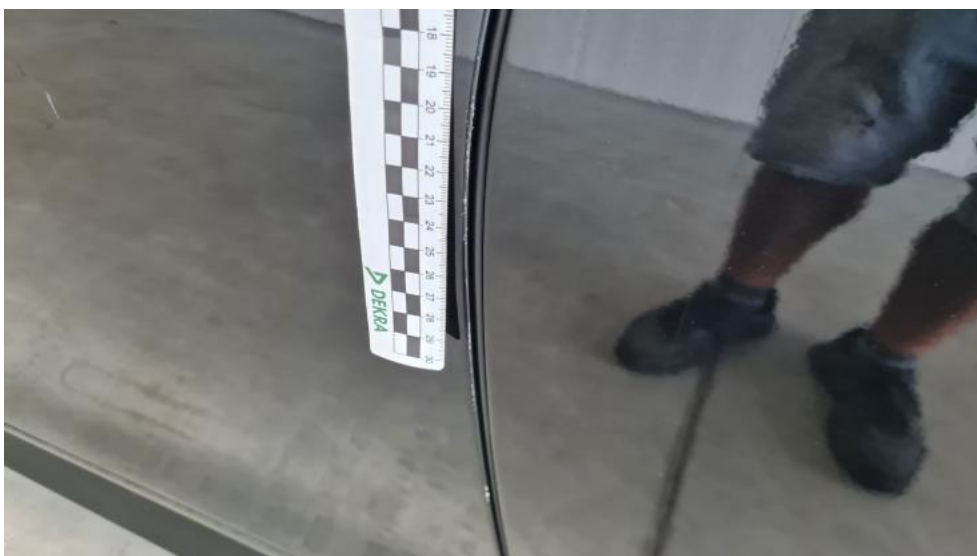
Photo 70. Drzwi przed L - Rysa/odprysk 1
