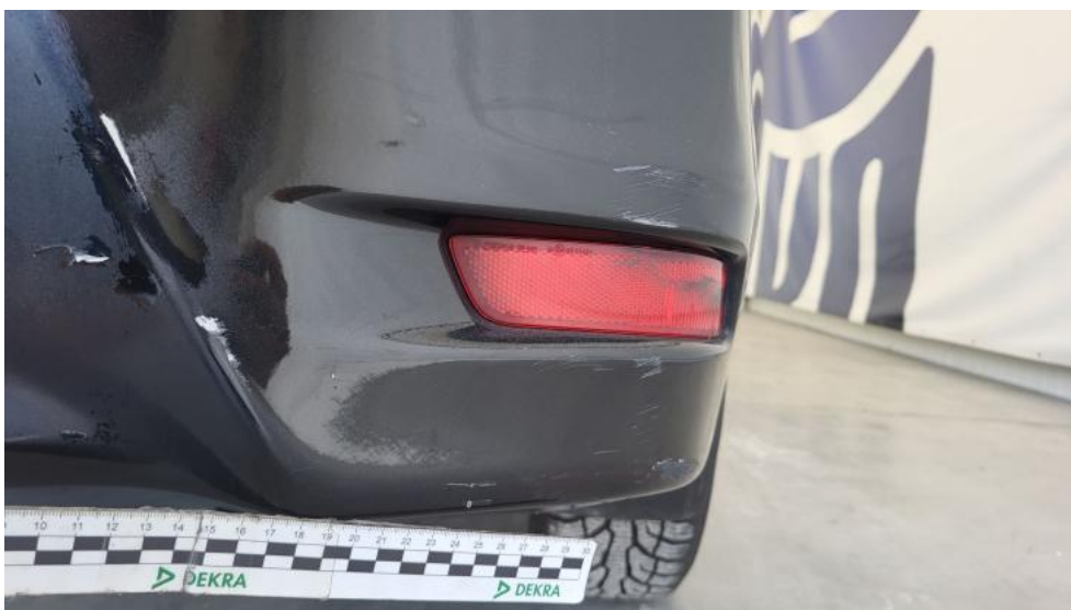
Fot. 84. Zderzak tylny - Rysa/odprysk 1
