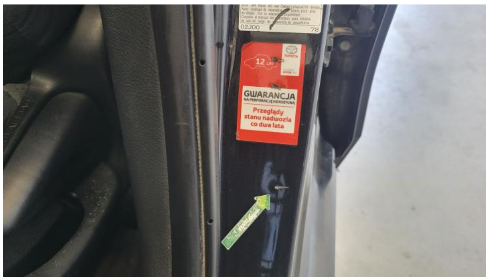
Fot. 105. Słupki środkowy L - Wgniecenie/odkształcenie 1
