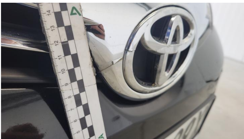
Fot. 42. Atrapa przednia() - Pęknięcie/rozerwanie 3
