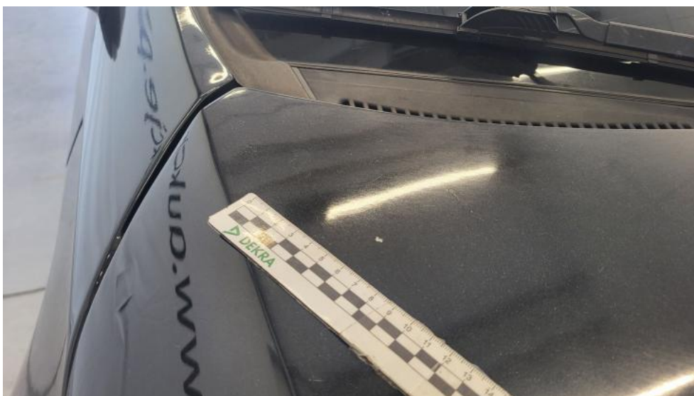
Fot. 48. Pokrywa komory silnika() - Rysa/odprysk 3
