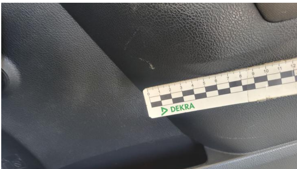
Fot. 124. Tapicerka drzwi tylnych P - Rysa/odprysk 1
