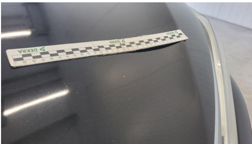
Fot. 47. Pokrywa komory silnika - Rysa/odprysk 2
