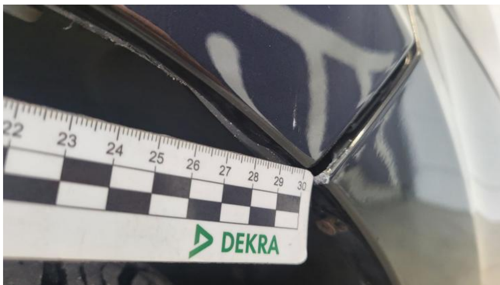
Fot. 60. Błotnik przedni P - Rysa/odprysk 2
