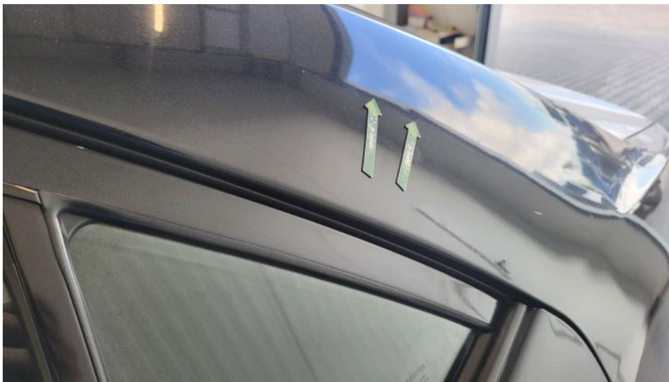
Fot. 93. Błotnik tylny L / Ściana boczna L - Wgniecenie/odkształcenie 1
