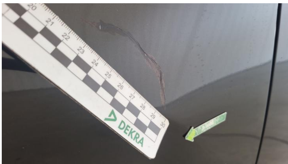
Fot. 106. Błotnik przedni L - Rysa/odprysk 1
