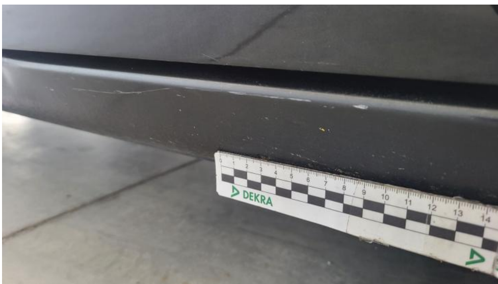
Fot. 68. Próg P - Rysa/odprysk 1
