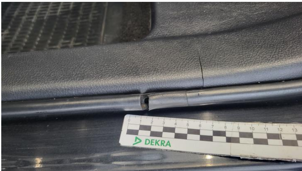
Fot. 127. Uszczelka drzwi tylnych L - Pęknięcie/rozerwanie 1
