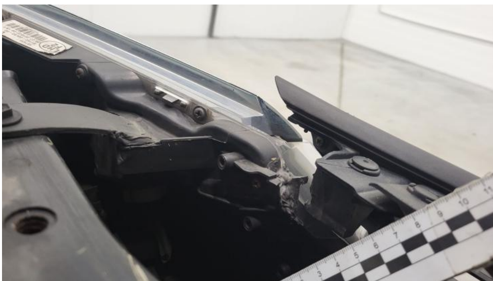
Fot. 40. Atrapa przednia - Pęknięcie/rozerwanie 1
