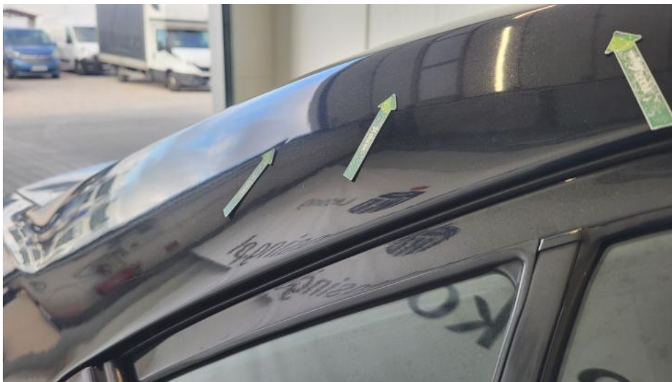
Fot. 75. Błotnik tylny P / Ściana boczna P - Wgniecenie/odkształcenie 1
