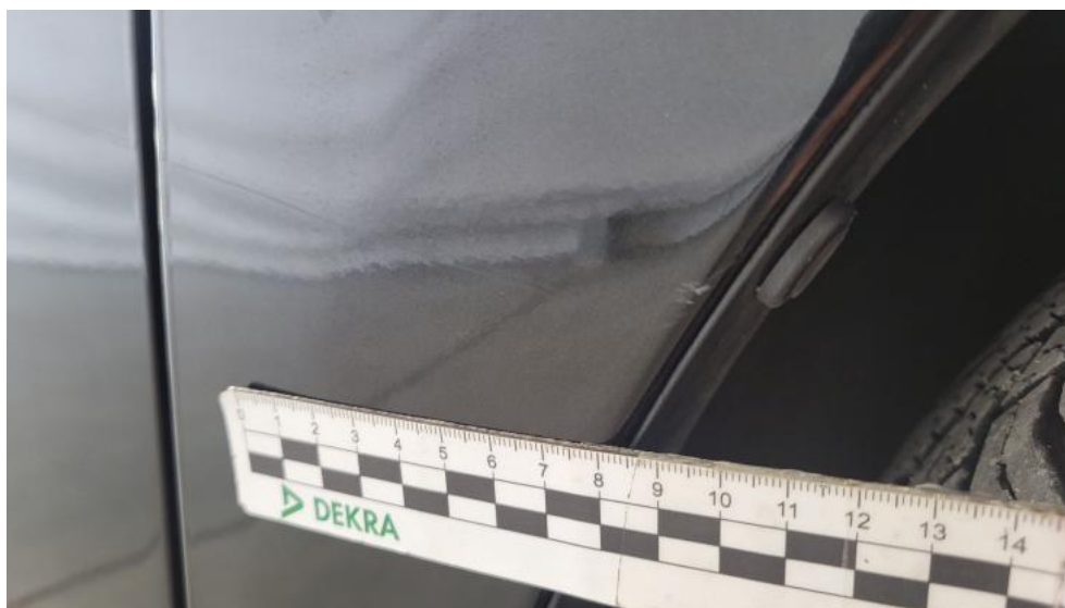
Fot. 59. Błotnik przedni P - Rysa/odprysk 1
