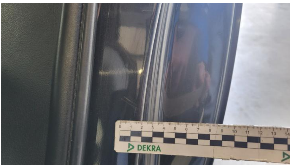
Fot. 92. Błotnik tylny L / Ściana boczna L - Rysa/odprysk 1
