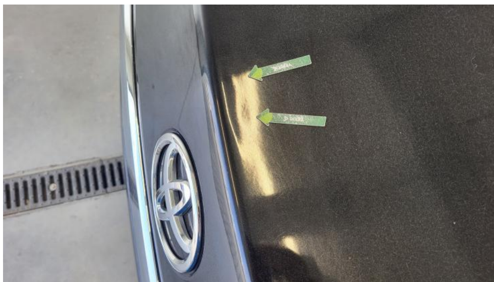
Fot. 81. Pokrywy bagażnika - Wgniecenie/odkształcenie 2
