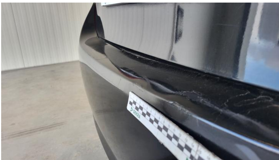
Fot. 87. Zderzak tylny - Wgniecenie/odkształcenie 1
