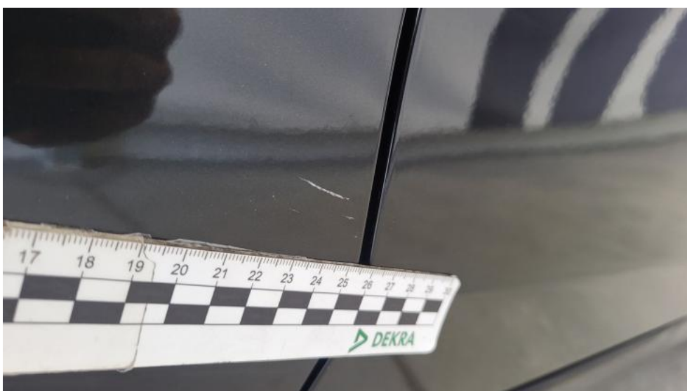
Fot. 64. Drzwi tylne P - Rysa/odprysk 1
