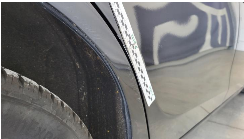
Fot. 73. Błotnik tylny P / Ściana boczna P - Rysa/odprysk 2
