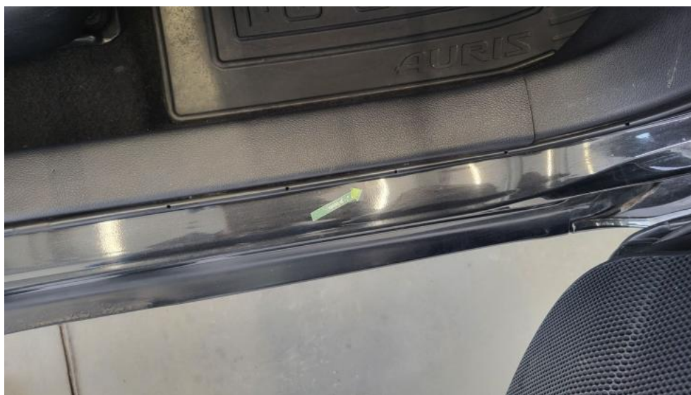
Fot. 69. Próg P - Wgniecenie/odkształcenie 1
