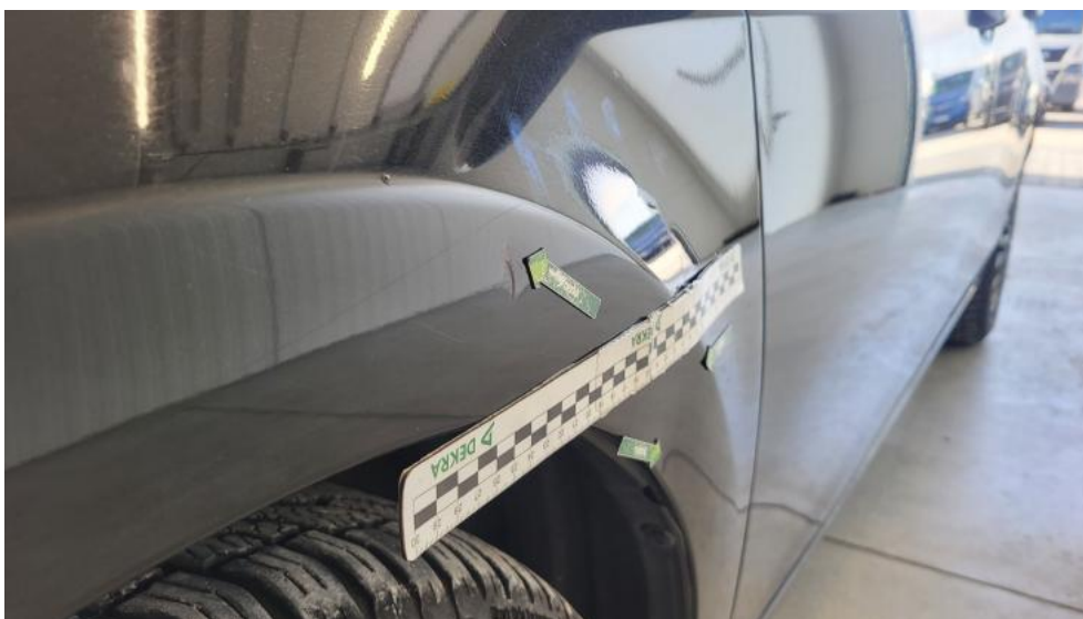
Fot. 109. Błotnik przedni L - Wgniecenie/odkształcenie 2
