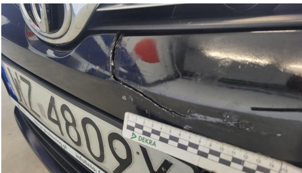
Fot. 56. Zderzak - Pęknięcie/rozerwanie 1
