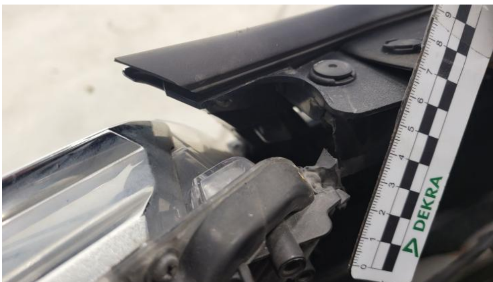
Fot. 41. Atrapa przednia - Pęknięcie/rozerwanie 2
