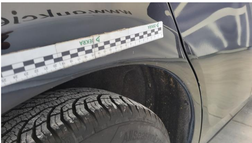
Fot. 74. Błotnik tylny P / Ściana boczna P() - Rysa/odprysk 3
