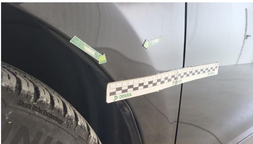
Fot. 110. Błotnik przedni L() - Wgniecenie/odkształcenie 3
