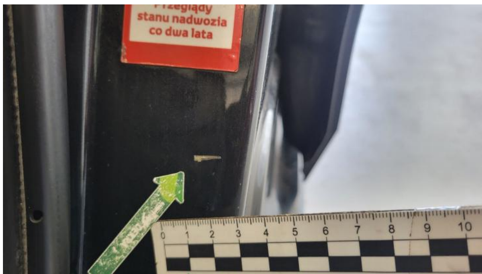
Fot. 104. Śtupek środkowy L - Rysa/odprysk 2
