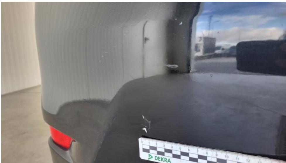
Fot. 85. Zderzak tylny - Rysa/odprysk 2
