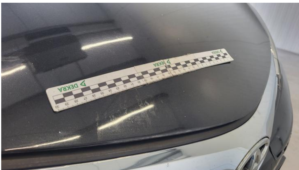
Fot. 46. Pokrywa komory silnika - Rysa/odprysk 1
