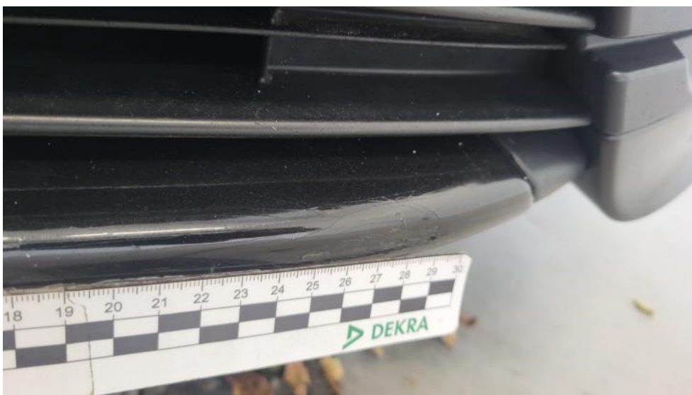
Fot. 58. Zderzak() - Pęknięcie/rozerwanie 3
