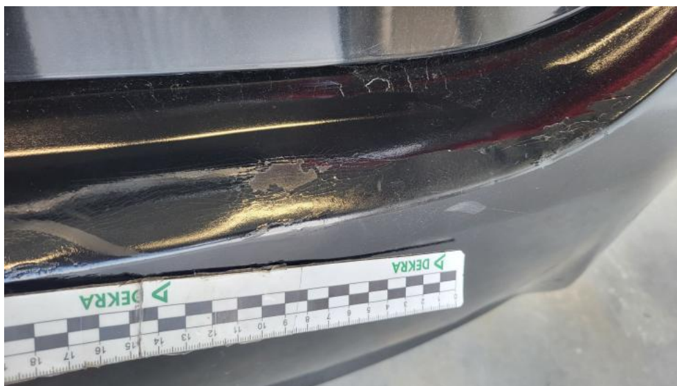
Fot. 89. Zderzak tylny - Pęknięcie/rozerwanie 1
