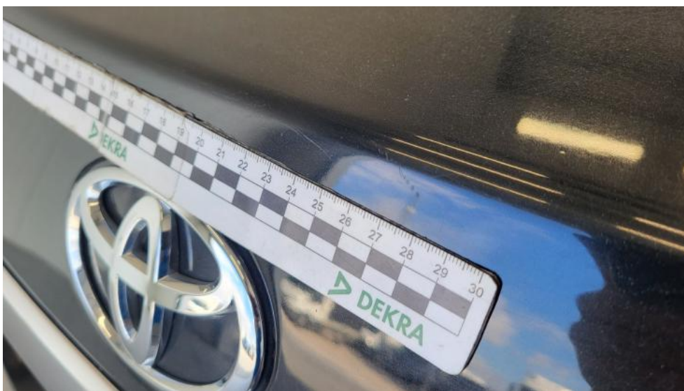
Fot. 79. Pokrywy bagażnika - Rysa/odprysk 2
