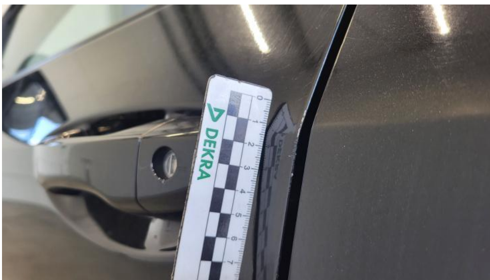
Fot. 97. Drzwi przed L() - Rysa/odprysk 3
