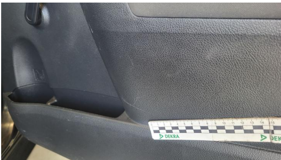
Fot. 125. Tapicerka drzwi tylnych P - Rysa/odprysk 2
