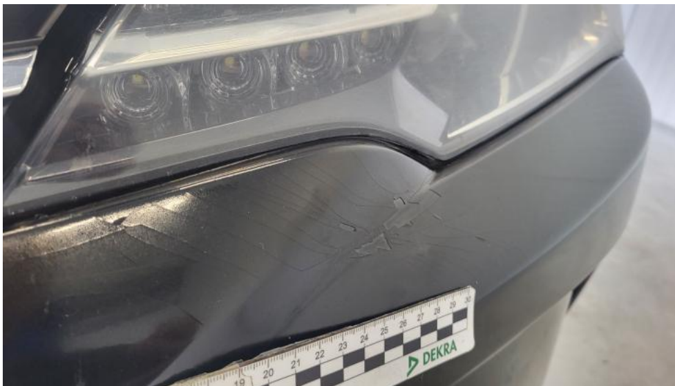
Fot. 57. Zderzak - Pęknięcie/rozerwanie 2
