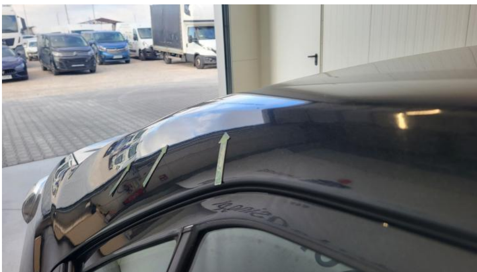
Fot. 76. Błotnik tylny P / Ściana boczna P - Wgniecenie/odkształcenie 2
