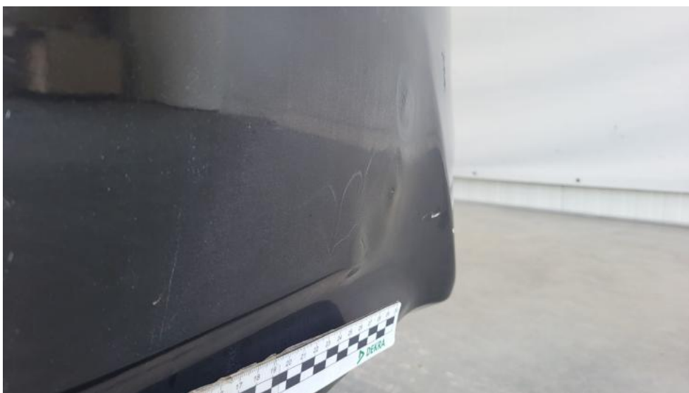
Fot. 88. Zderzak tylny - Wgniecenie/odkształcenie 2
