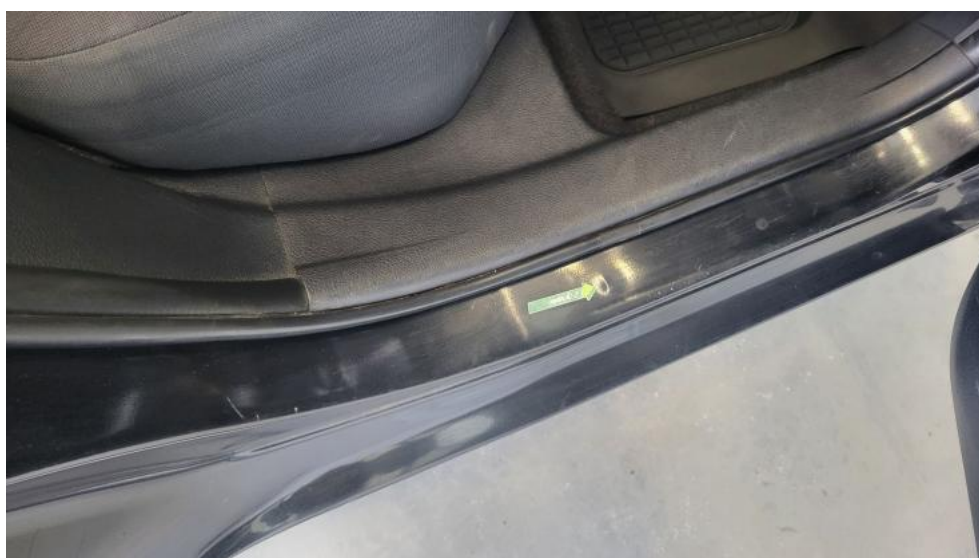
Fot. 70. Próg P - Wgniecenie/odkształcenie 2
