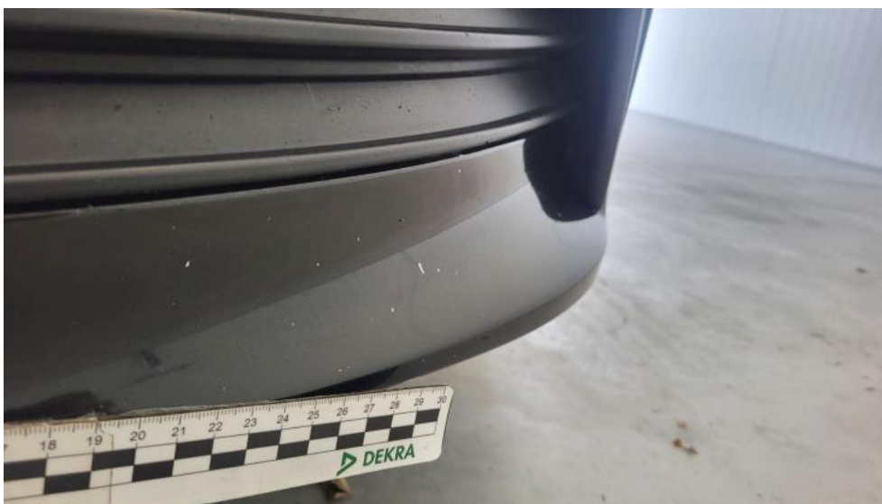
Fot. 54. Zderzak - Rysa/odprysk 2
