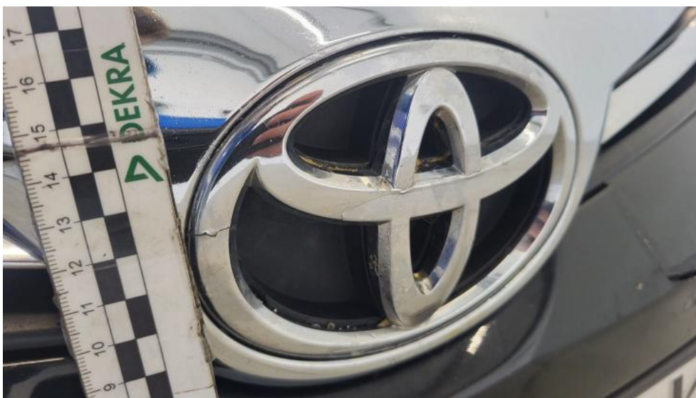
Fot. 43. Emblemat - Pęknięcie/rozerwanie 1
