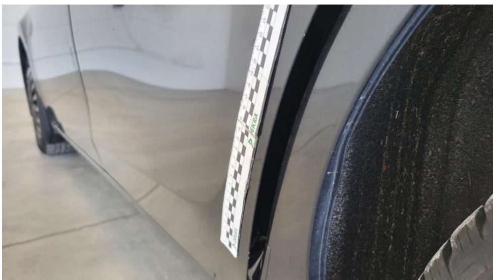
Fot. 100. Drzwi tylne L - Rysa/odprysk 2
