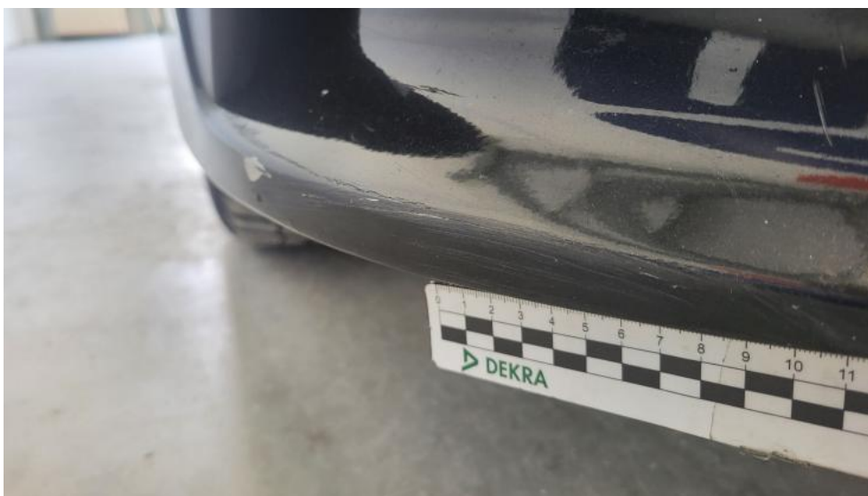
Fot. 55. Zderzak() - Rysa/odprysk 3
