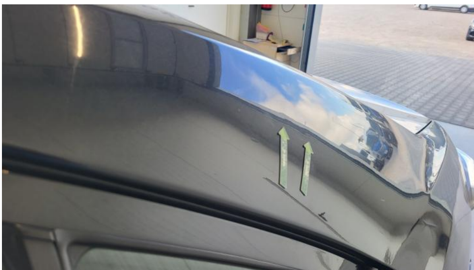
Fot. 94. Błotnik tylny L / Ściana boczna L - Wgniecenie/odkształcenie 2
