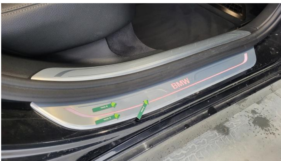
Fot. 50. Próg P - Wgniecenie/odkształcenie 1
