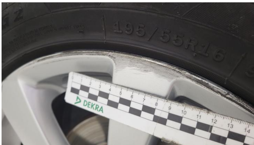
Photo 43. Felga aluminiowa przednia P - Rysa/odprysk 1
