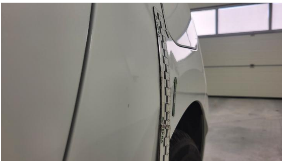
Photo 62. Błotnik tylny L / Ściana boczna L - Wgniecenie/odkształcenie 1
