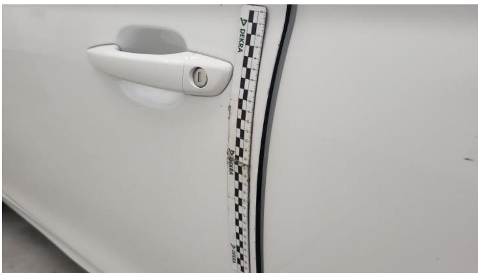
Photo 64. Drzwi przed L - Rysa/odprysk 1
