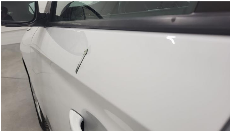
Photo 65. Drzwi przed L - Wgniecenie/odkształcenie 1
