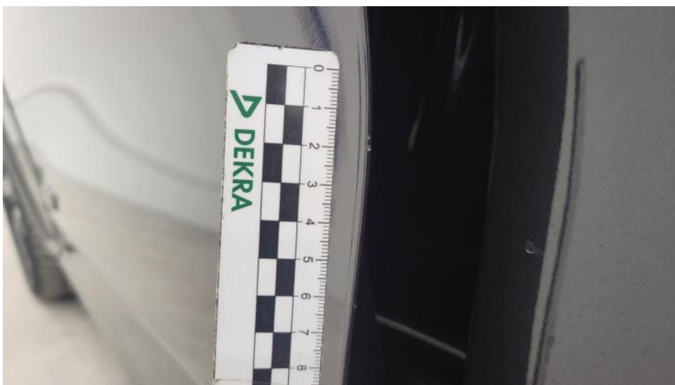
Photo 56. Drzwi przed L - Rysa/odprysk 1
