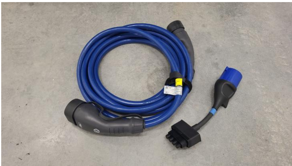
Photo 34. Przewód ładowania baterii trakcyjnej
