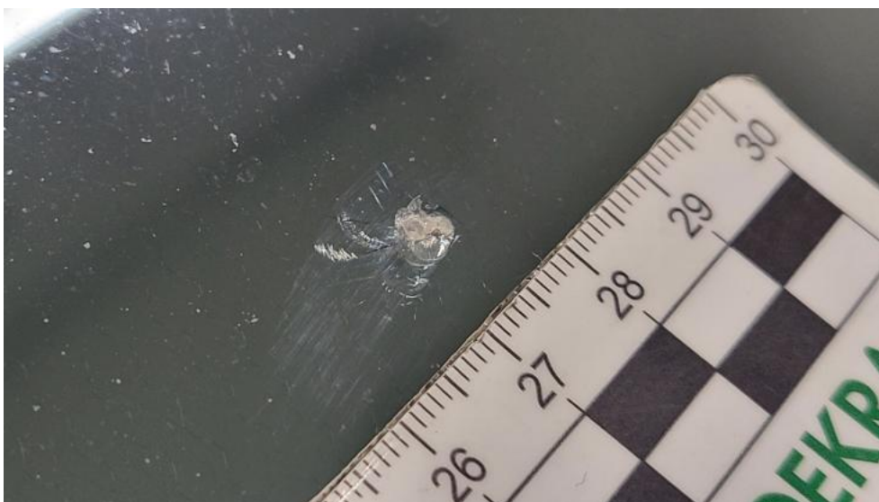
Photo 54. Szyba czołowa ogrzewana - Pęknięcie/rozerwanie 1
