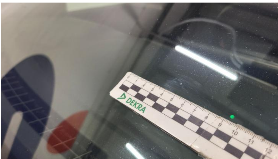
Photo 53. Szyba czołowa ogrzewana - Rysa/odprysk 1
