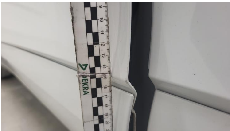
Photo 56. Drzwi przed L - Rysa/odprysk 1
