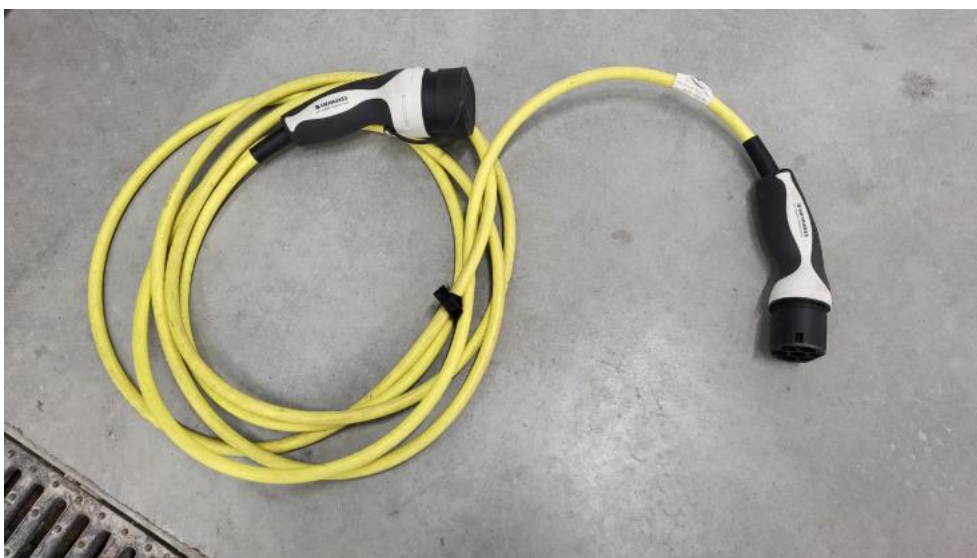
Photo 34. Przewód ładowania baterii trakcyjnej
