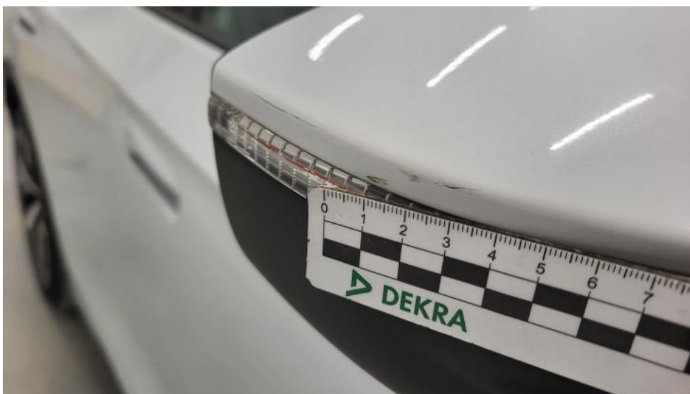
Photo 50. Lusterko zew P - Rysa/odprysk 1
