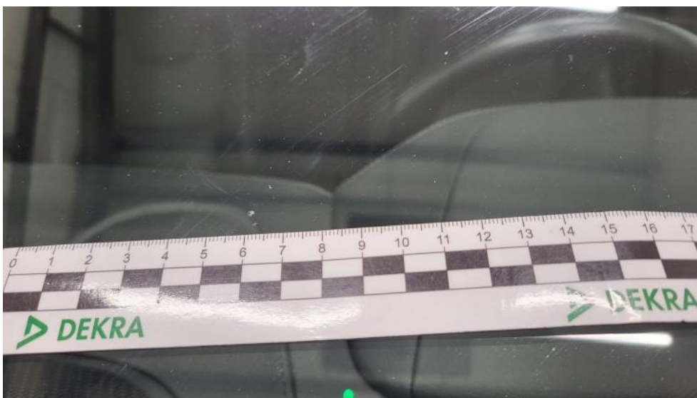
Photo 56. Szyba czołowa - Rysa/odprysk 1
