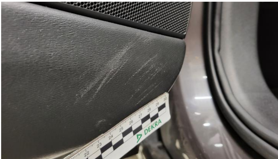
Photo 93. Tapicerka drzwi przednich L - Rysa/odprysk 1
