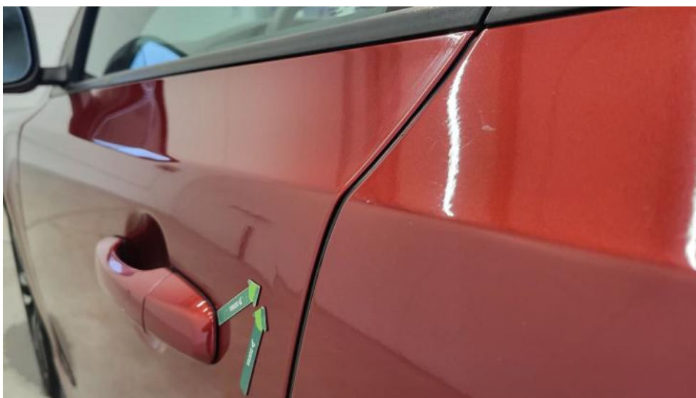
Photo 111. Drzwi przed L - Wgniecenie/odkształcenie 2
