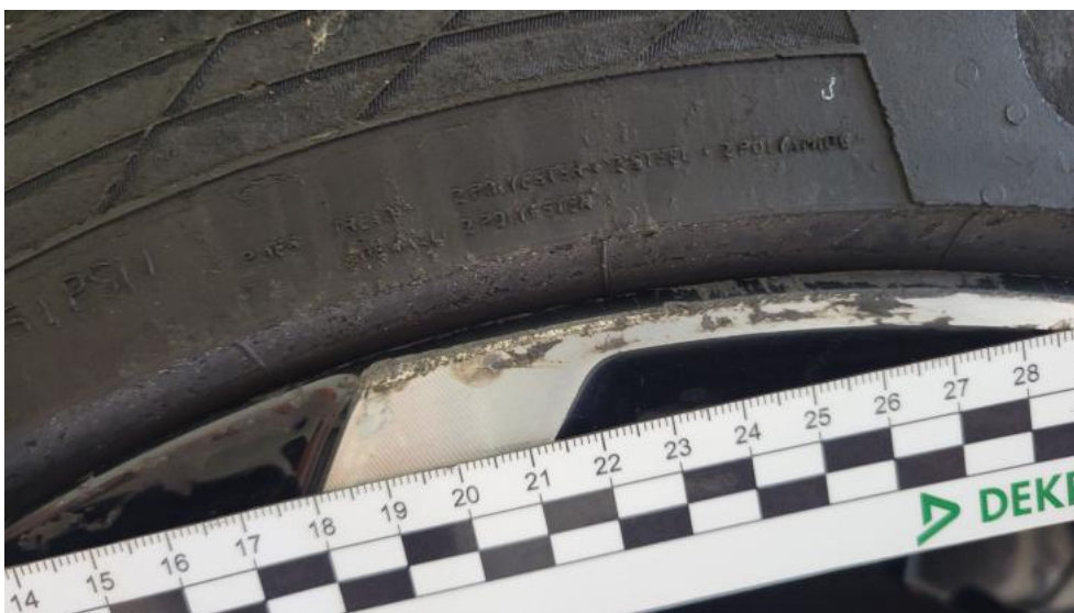
Photo 106. Felga aluminiowa tylna L() - Rysa/odprysk 3
