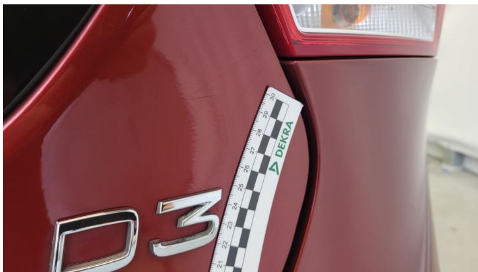
Photo 84. Pokrywy bagażnika - Rysa/odprysk 1
