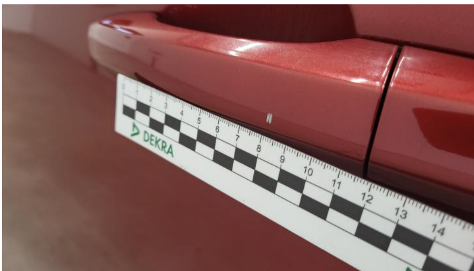
Photo 117. Klamka drzwi prz L - Rysa/odprysk 1
