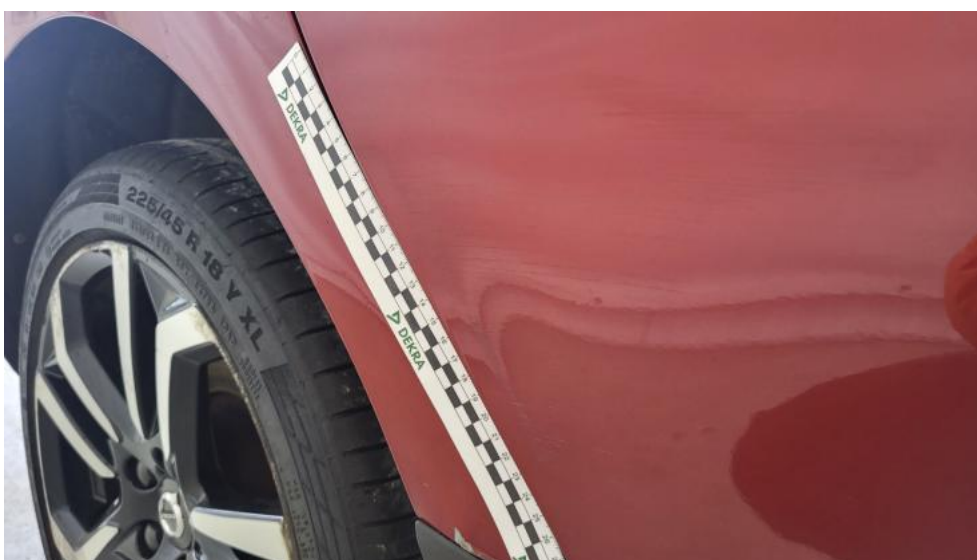
Photo 68. Drzwi tylne P - Rysa/odprysk 1
