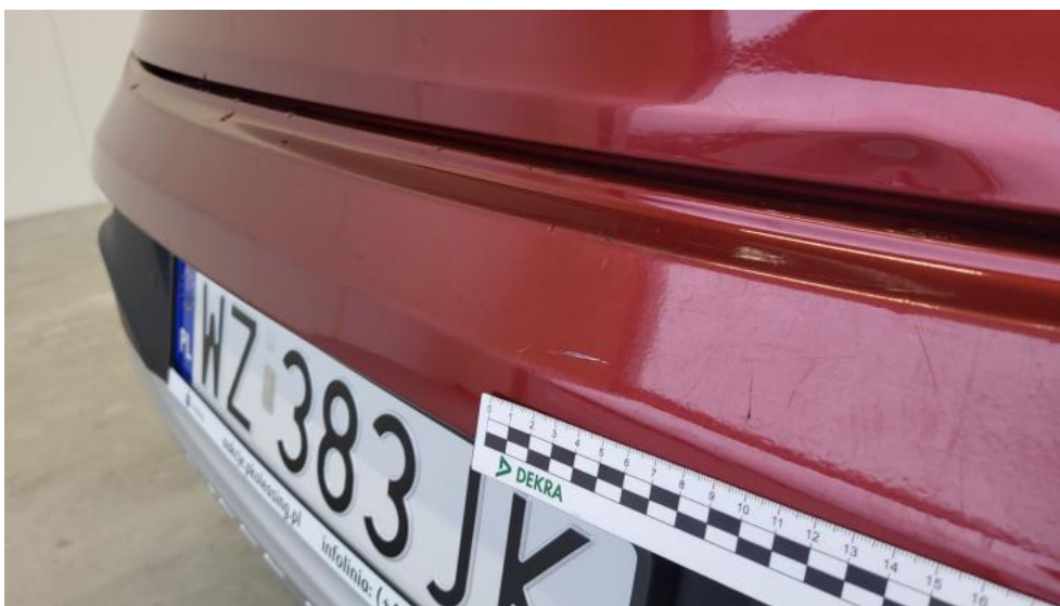
Photo 91. Zderzak tylny - Rysa/odprysk 1
