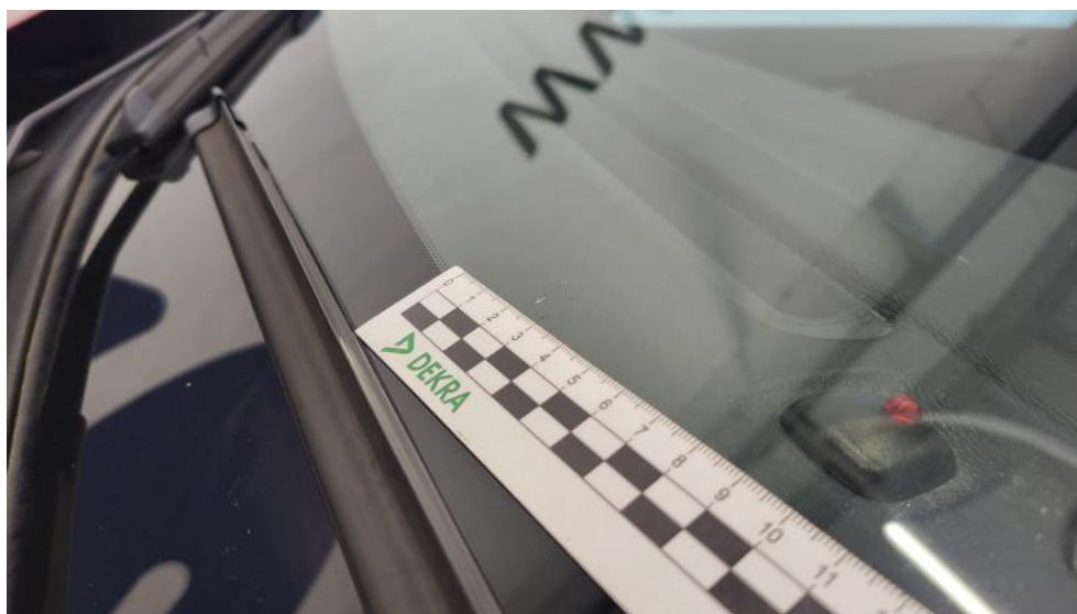
Photo 52. Szyba czołowa - Rysa/odprysk 2
