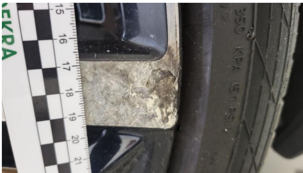
Photo 63. Felga aluminiowa przednia P - Rysa/odprysk 2
