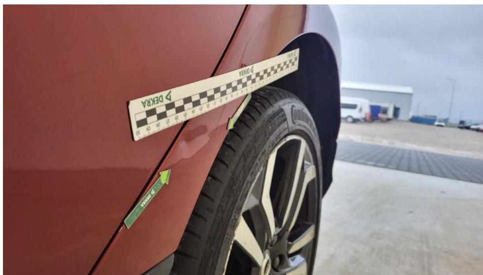
Photo 101. Błotnik tylny L / Ściana boczna L - Wgniecenie/odkształcenie 1
