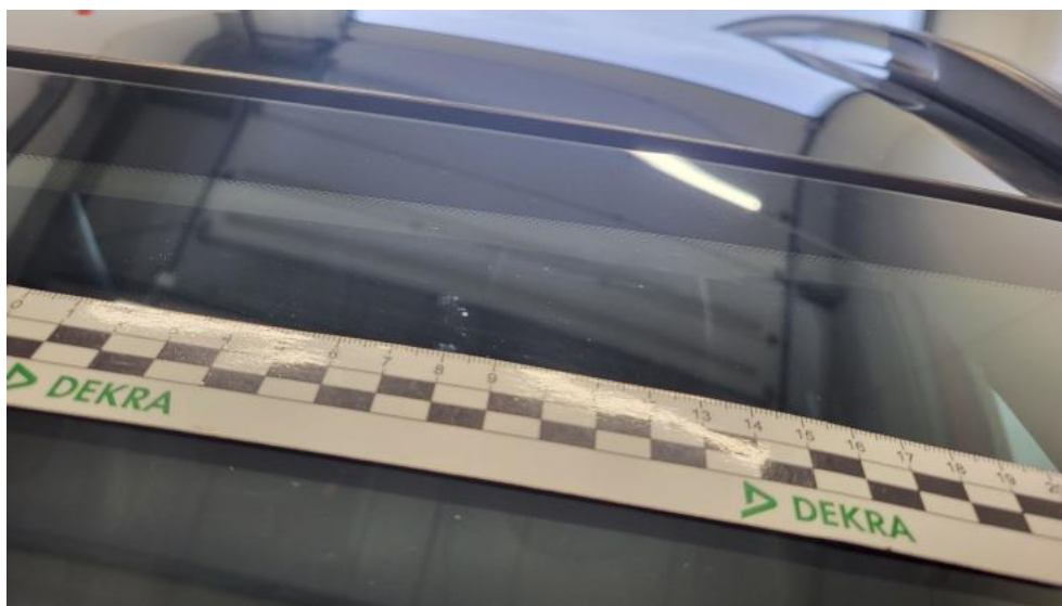
Photo 51. Szyba czołowa - Rysa/odprysk 1
