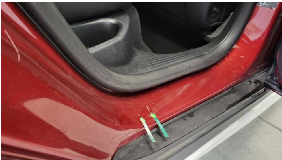
Photo 73. Próg P - Wgniecenie/odkształcenie 1
