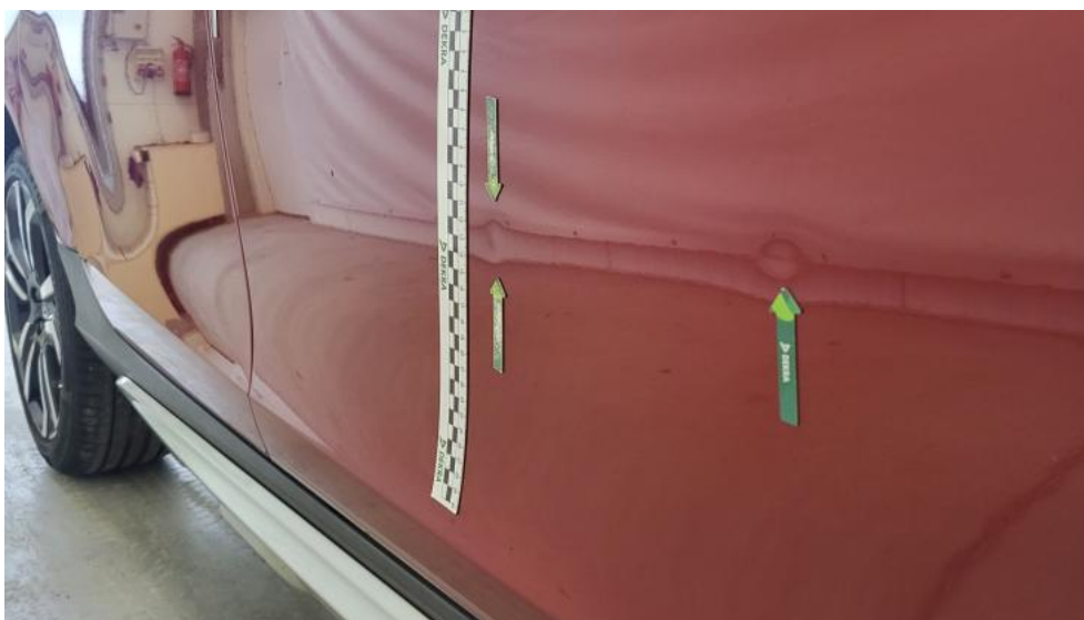
Photo 67. Drzwi przednie P - Wgniecenie/odkształcenie 1
