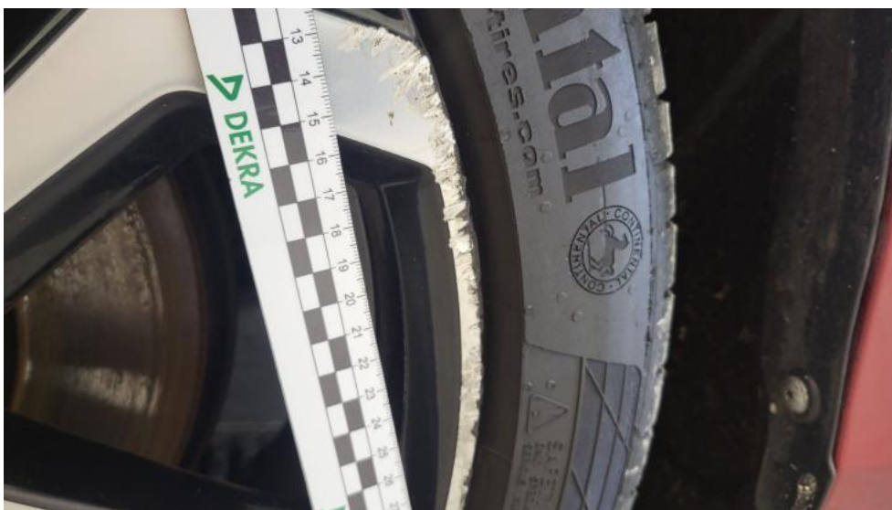
Photo 122. Felga Aluminiowa przednia L() - Rysa/odprysk 3
