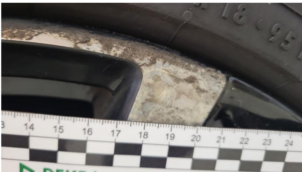
Photo 62. Felga aluminiowa przednia P - Rysa/odprysk 1
