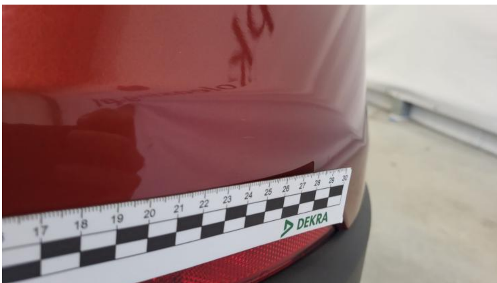
Photo 92. Zderzak tylny - Rysa/odprysk 2
