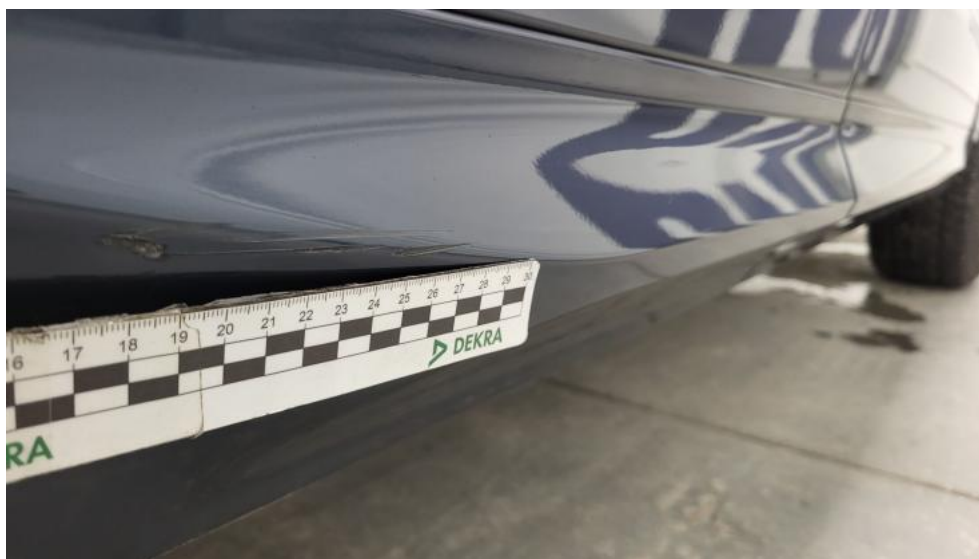
Photo 59. Próg P - Rysa/odprysk 1
