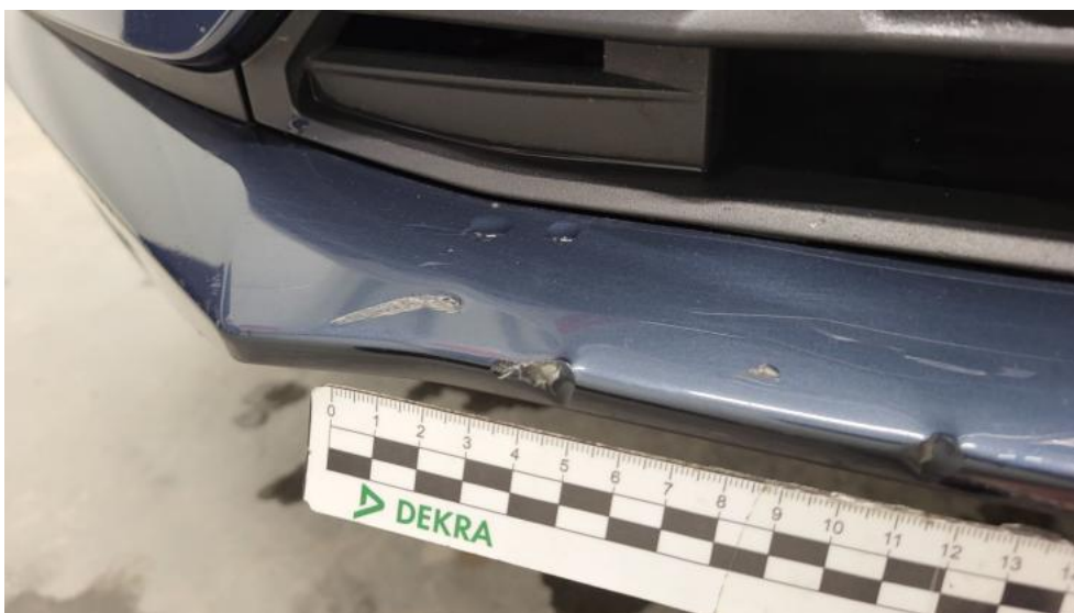
Photo 50. Zderzak przedni cz dolna() - Rysa/odprysk 3
