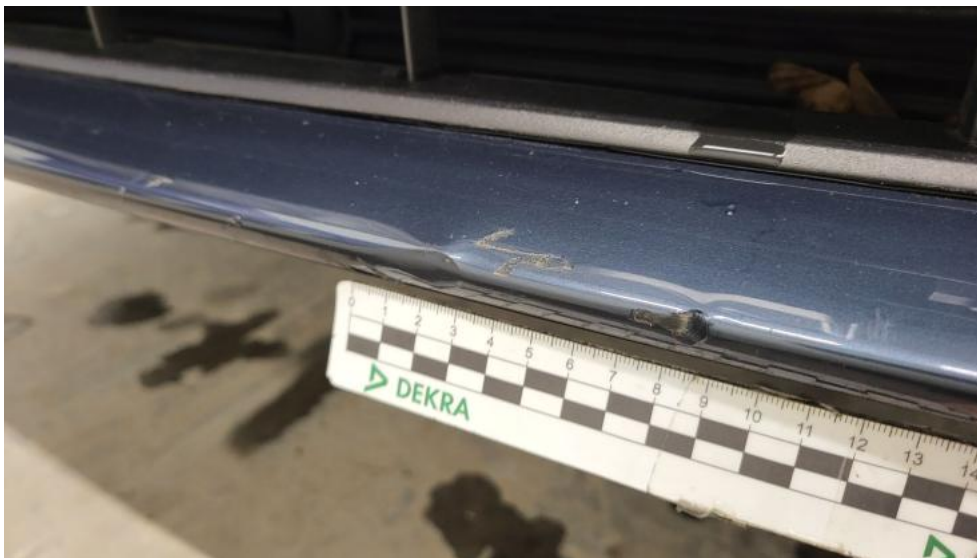
Photo 49. Zderzak przedni cz dolna - Rysa/odprysk 2
