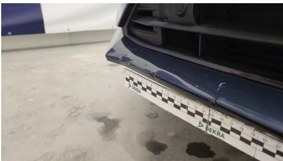
Photo 52. Zderzak przedni cz dolna - Wgniecenie/odkształcenie 2
