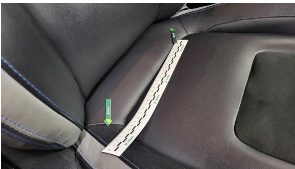
Fot. 70. Fotel prz. praw. - Wgniecenie/odkształcenie 1
