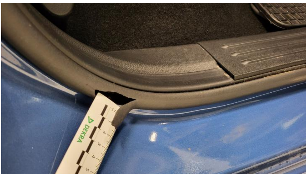
Fot. 72. Uszczelka drzwi tylnych P - Pęknięcie/rozerwanie 1
