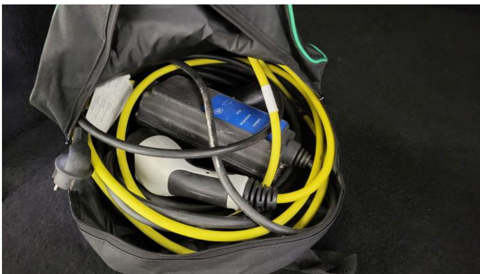
Photo 32. Przewód ładowania baterii trakcyjnej
