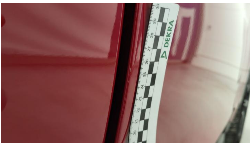
Fot. 48. Drzwi przednie P - Rysa/odprysk 1
