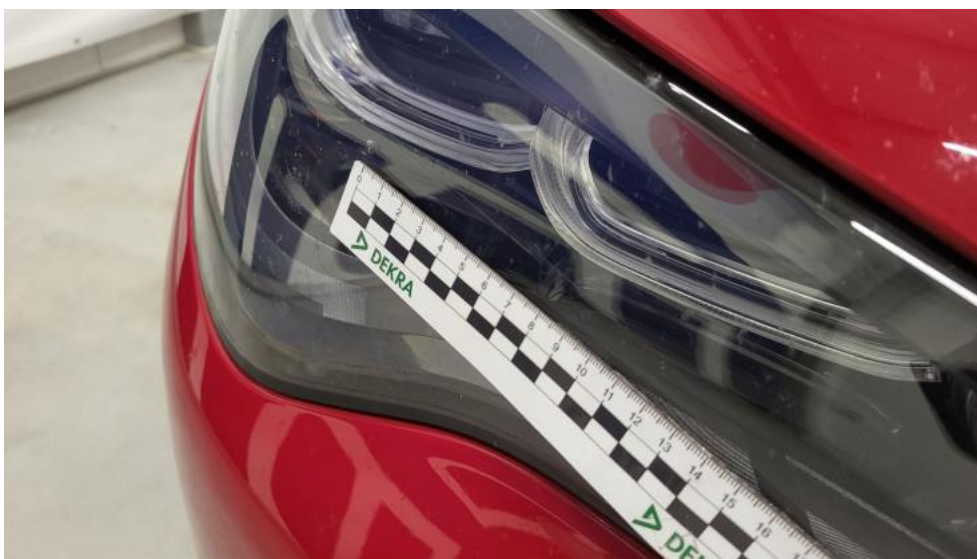
Fot. 47. Reflektor P - Rysa/odprysk 1
