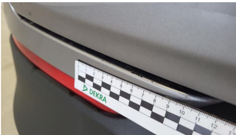
Fot. 55. Zderzak tylny cz L - Rysa/odprysk 2
