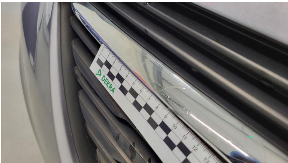
Fot. 38. Atrapa przednia - Rysa/odprysk 1
