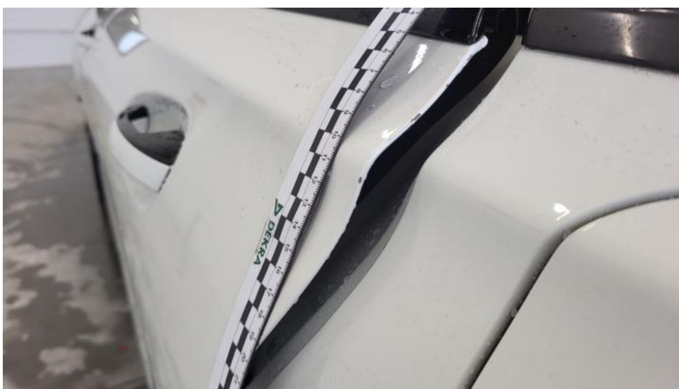
Fot. 74. Drzwi tylne L - Rysa/odprysk 1
