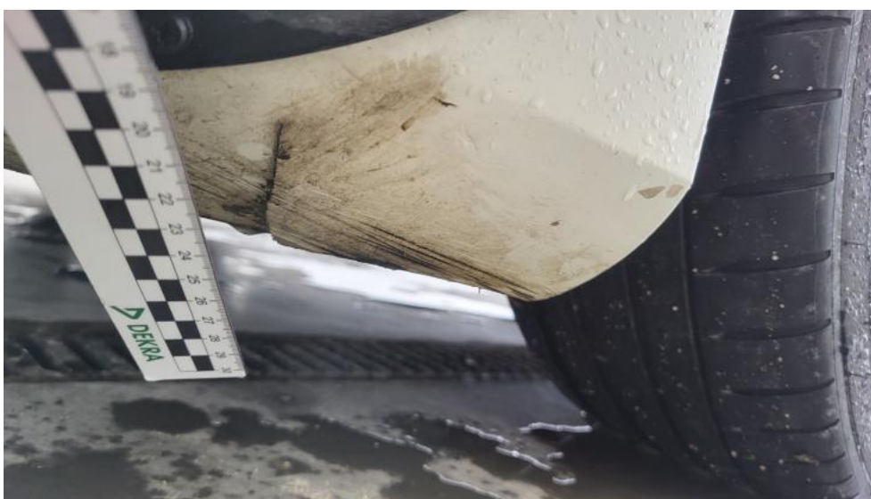
Fot. 50. Zderzak - Pęknięcie/rozerwanie 1
