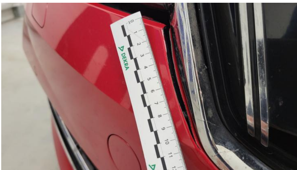
Fot. 59. Zderzak - Pęknięcie/rozerwanie 1
