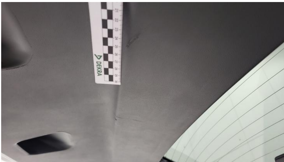
Photo 62. Wykładzina pokrywy tylnej - Rysa/odprysk 1
