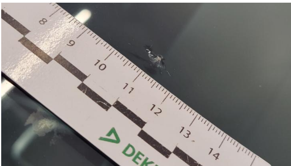
Photo 48. Szyba czołowa - Pęknięcie/rozerwanie 1
