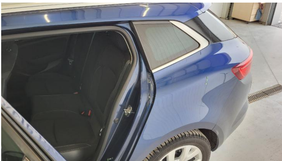
Photo 79. Błotnik tylny L / Ściana boczna L - Wgniecenie/odkształcenie 1
