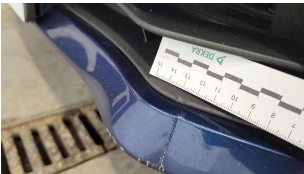
Photo 41. Kratka zderzaka prz. - Rysa/odprysk 1
