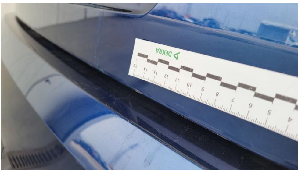
Photo 68. Pokrywy bagażnika - Rysa/odprysk 1
