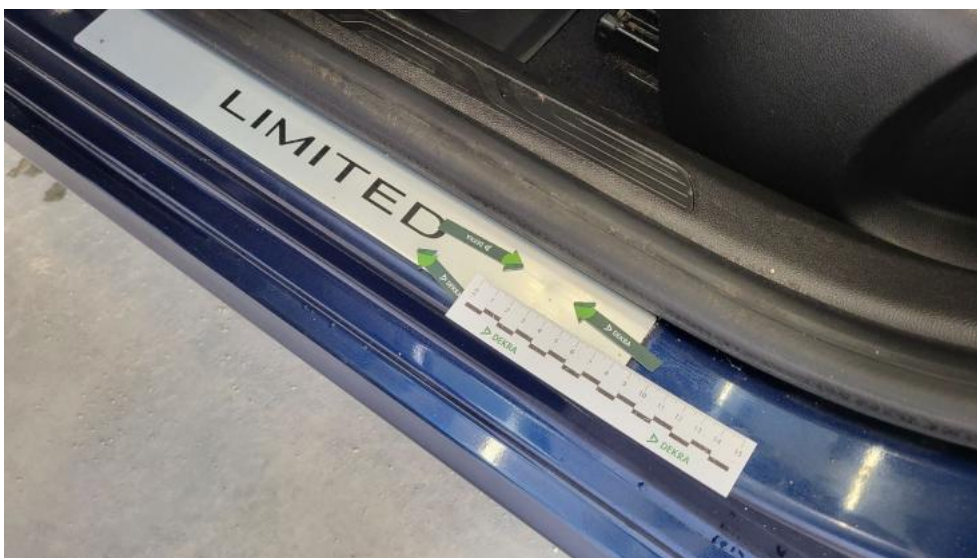
Photo 84. Próg L - Wgniecenie/odkształcenie 1
