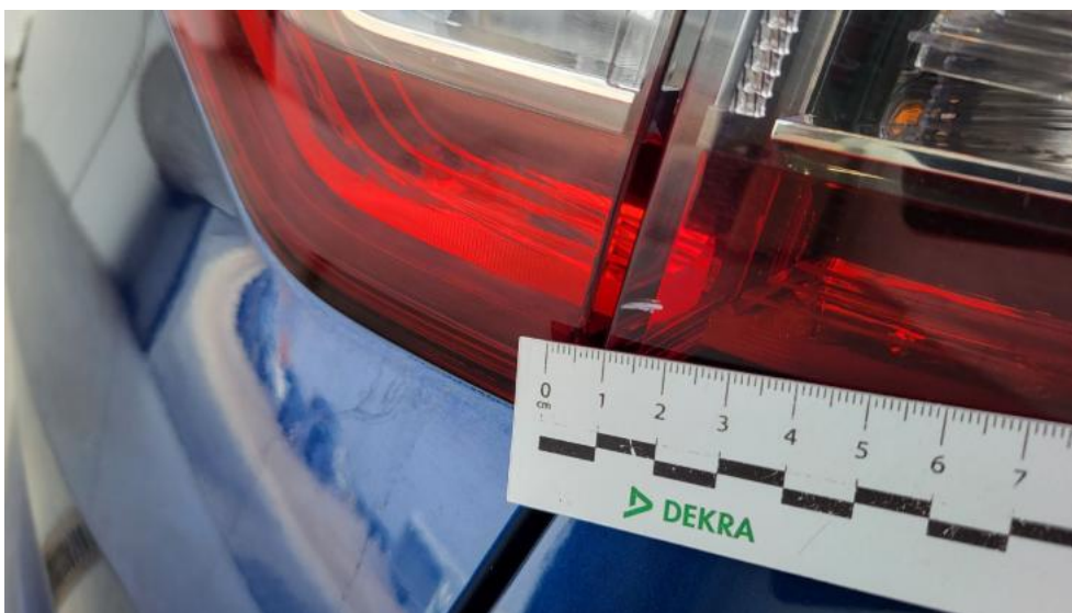
Photo 67. Lampa tylna zew P - Rysa/odprysk 1
