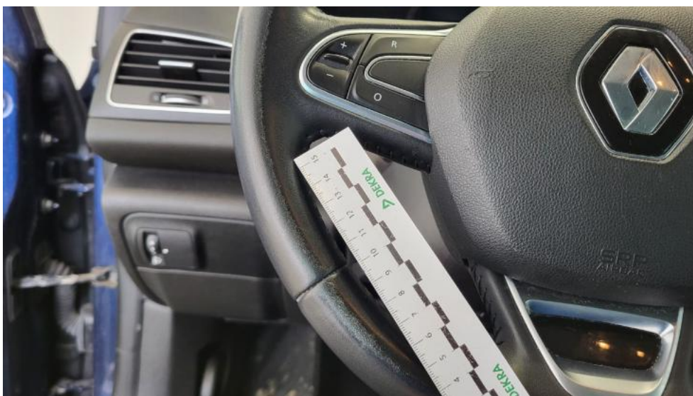
Photo 90. Koło kierownicy - Rysa/odprysk 1
