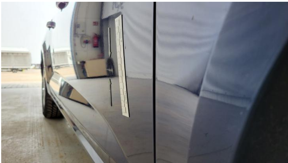
Photo 59. Drzwi przednie P - Wgniecenie/odkształcenie 1
