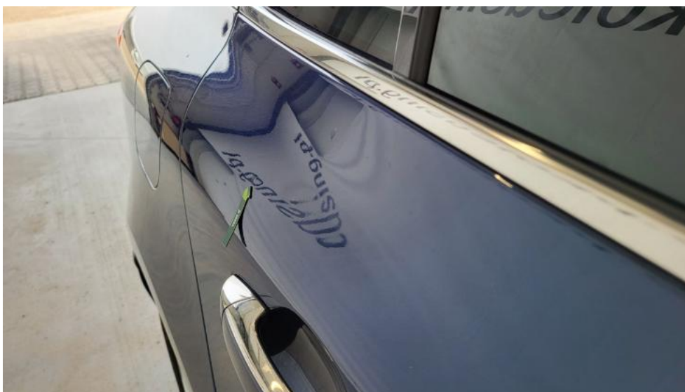
Photo 61. Drzwi tylne P - Wgniecenie/odkształcenie 1
