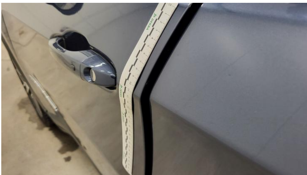
Photo 62. Drzwi przed L - Rysa/odprysk 1
