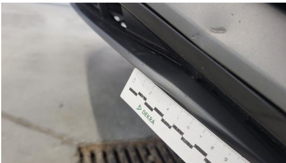
Fot. 48. Spoiler zderzaka przedniego - Pęknięcie/rozerwanie 1
