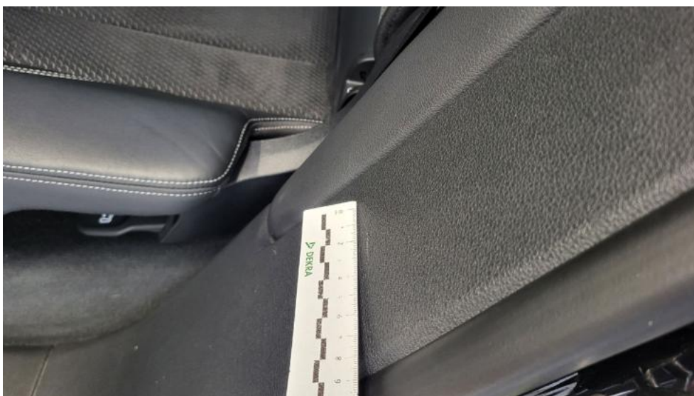
Fot. 68. Wykładzina(y) słupka tylnego L - Rysa/odprysk 1
