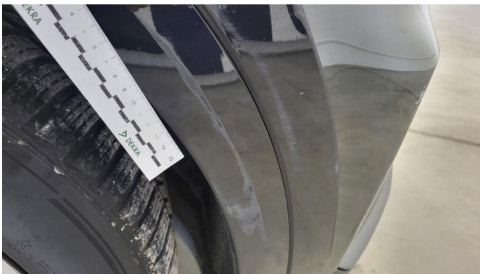
Fot. 55. Listwa krawędzi błotnika prz P - Rysa/odprysk 1
