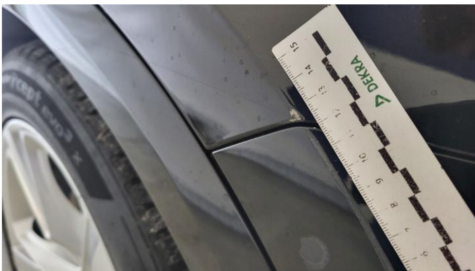
Fot. 54. Błotnik przedni P - Rysa/odprysk 2
