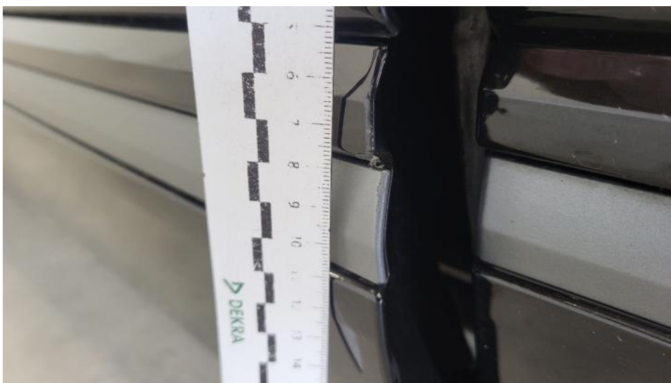
Fot. 62. Listwa drzwi przednich L - Rysa/odprysk 1
