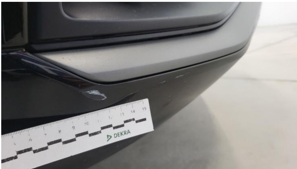
Fot. 49. Zderzak przedni cz dolna - Rysa/odprysk 1
