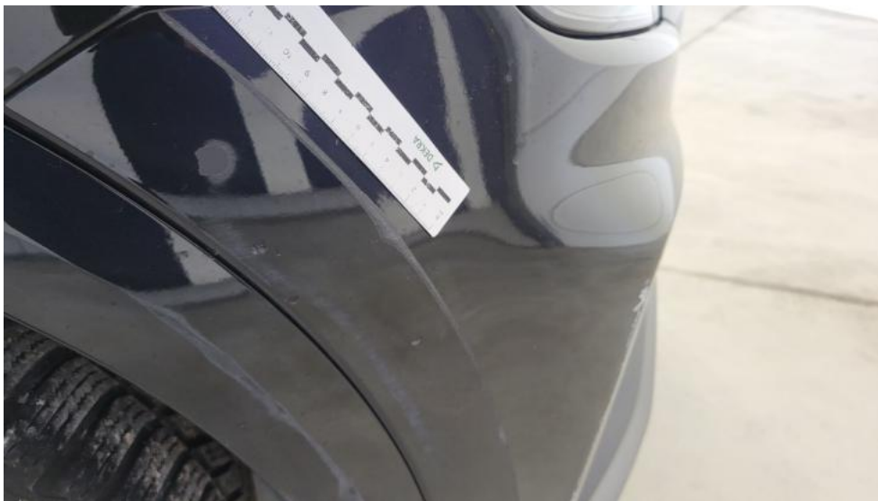
Fot. 51. Zderzak przedni cz L - Rysa/odprysk 1
