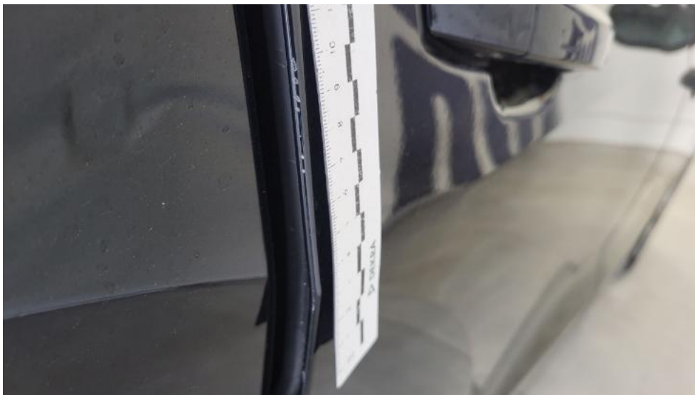
Fot. 57. Drzwi tylne P - Rysa/odprysk 1
