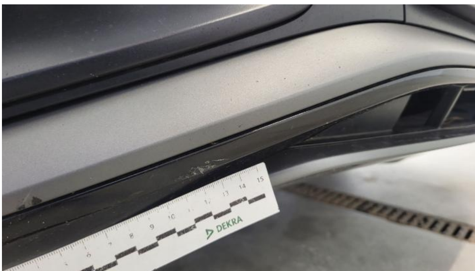
Fot. 50. Zderzak przedni cz dolna - Rysa/odprysk 2
