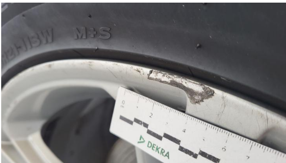
Fot. 58. Felga aluminiowa tylna P - Rysa/odprysk 1
