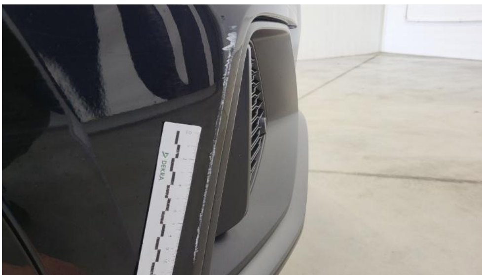
Fot. 52. Zderzak przedni cz L - Rysa/odprysk 2
