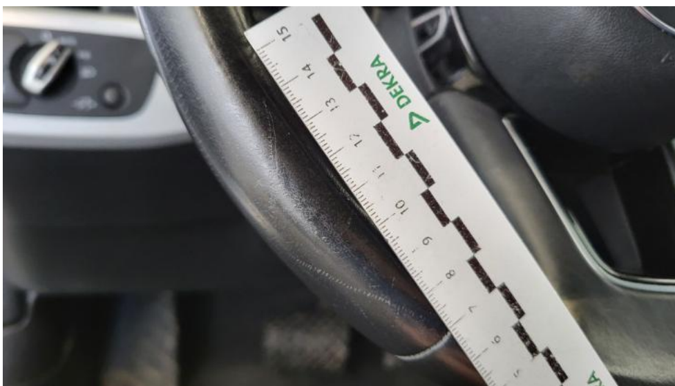
Photo 70. Koło kierownicy - Rysa/odprysk 1
