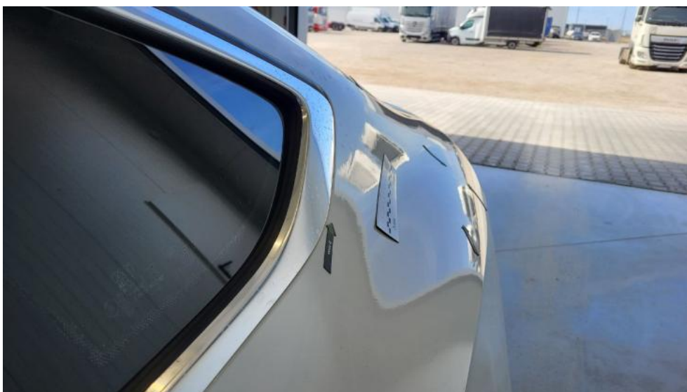
Photo 61. Błotnik tylny L / Ściana boczna L - Wgniecenie/odkształcenie 1
