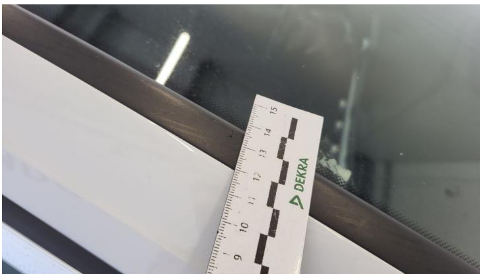
Photo 45. Uszczelka/listwa szyby czołowej - Rysa/odprysk 1
