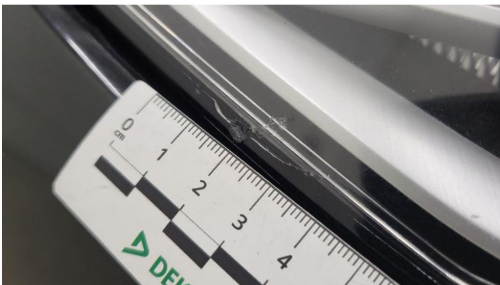
Fot. 86. Reflektor L - Pęknięcie/rozerwanie 1
