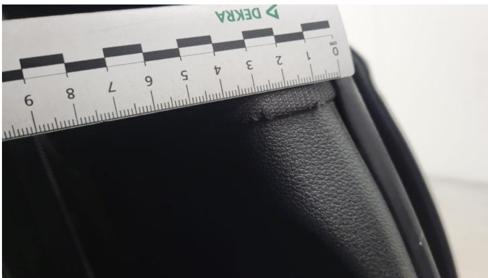
Fot. 90. Wykładzina(y) słupka środkowego P - Pęknięcie/rozerwanie 1
