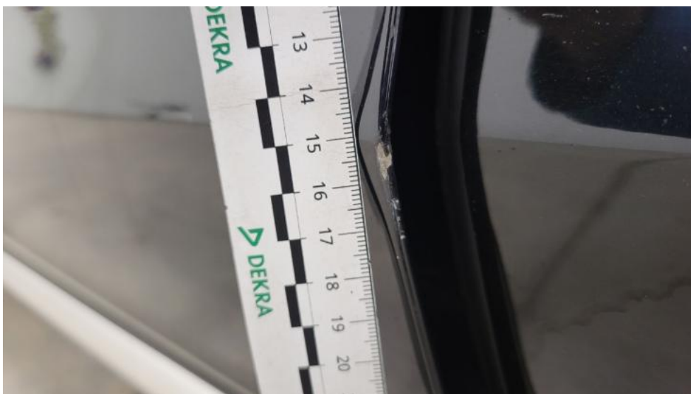
Fot. 80. Drzwi przed L - Rysa/odprysk 1
