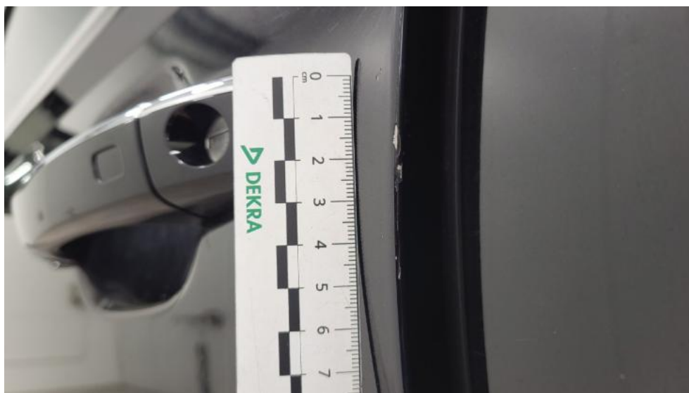
Fot. 81. Drzwi przed L - Rysa/odprysk 2
