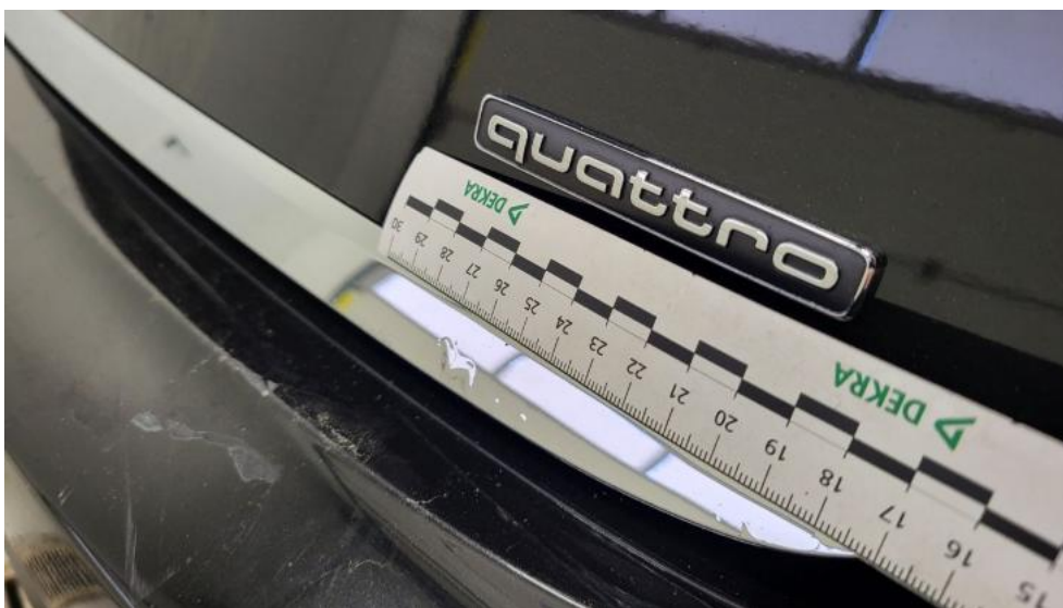
Fot. 73. Pokrywy bagażnika - Wgniecenie/odkształcenie 1
