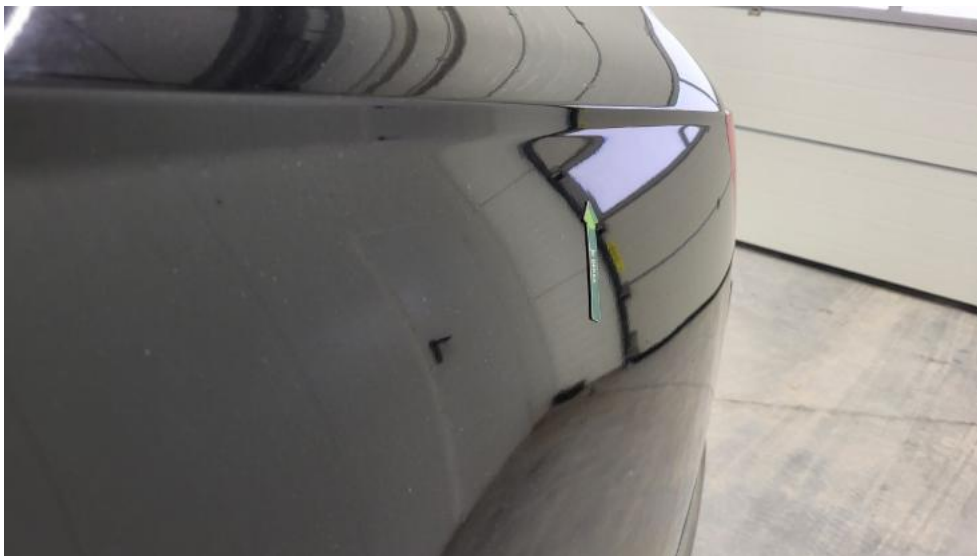
Fot. 79. Błotnik tylny L / Ściana boczna L - Wgniecenie/odkształcenie 1
