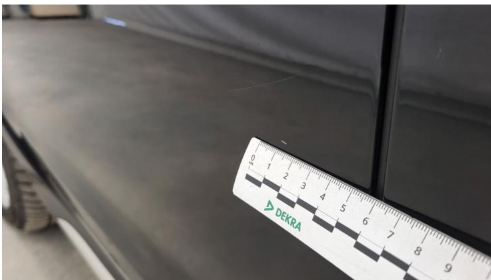
Fot. 66. Drzwi tylne P - Rysa/odprysk 1
