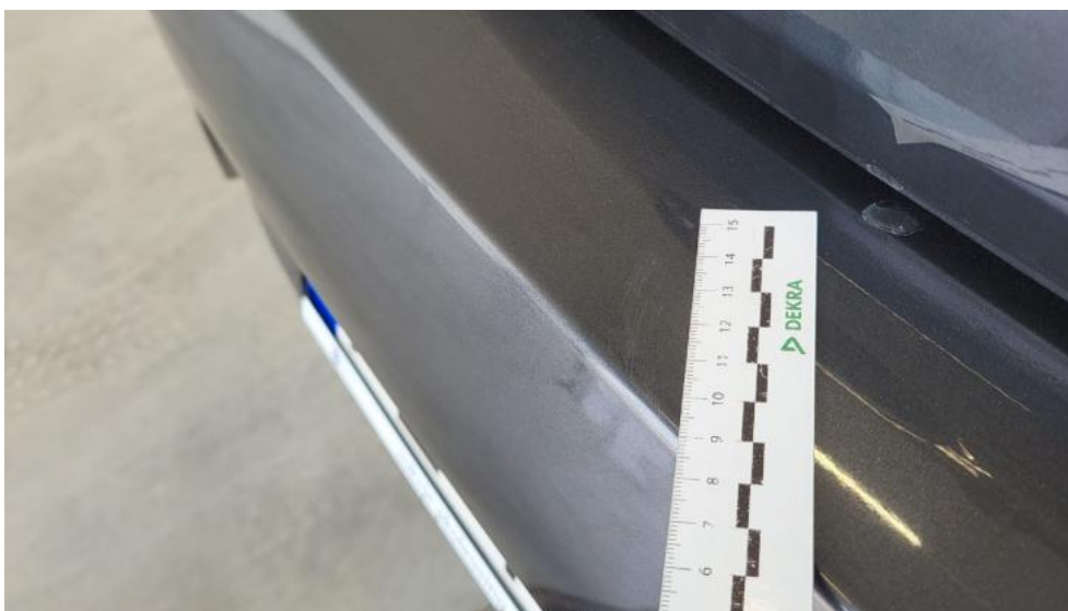
Fot. 49. Zderzak tylny - Rysa/odprysk 1
