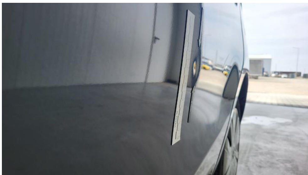
Fot. 57. Drzwi tylne L - Wgniecenie/odkształcenie 1
