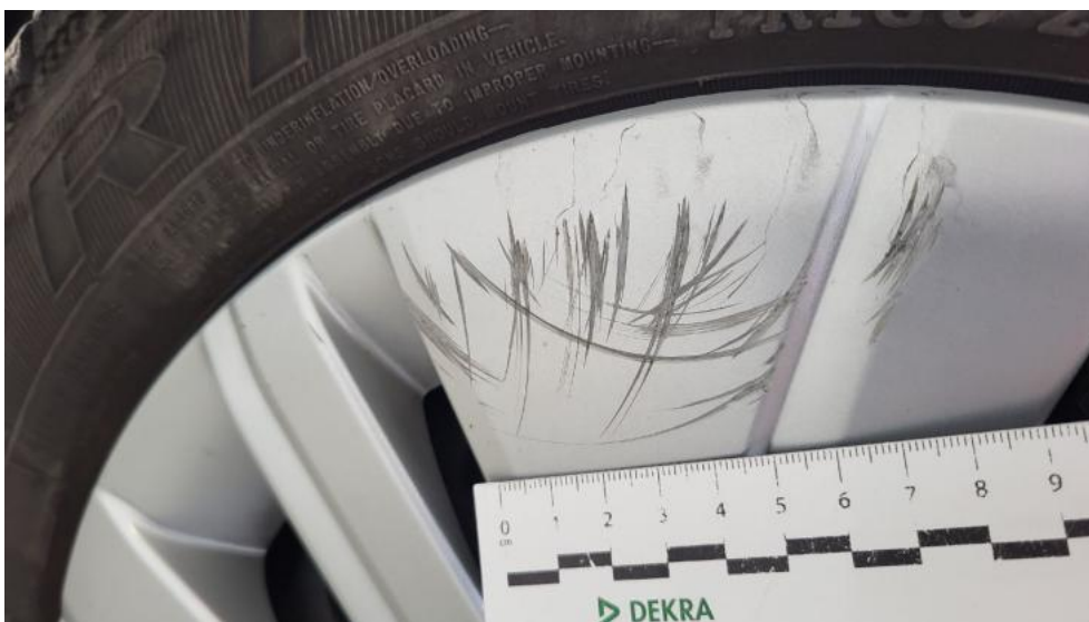
Fot. 62. Kołpak przedni L - Rysa/odprysk 1
