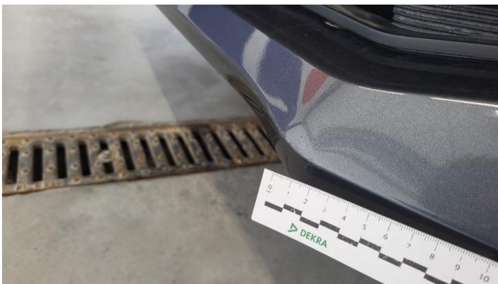
Fot. 38. Zderzak - Wgniecenie/odkształcenie 1
