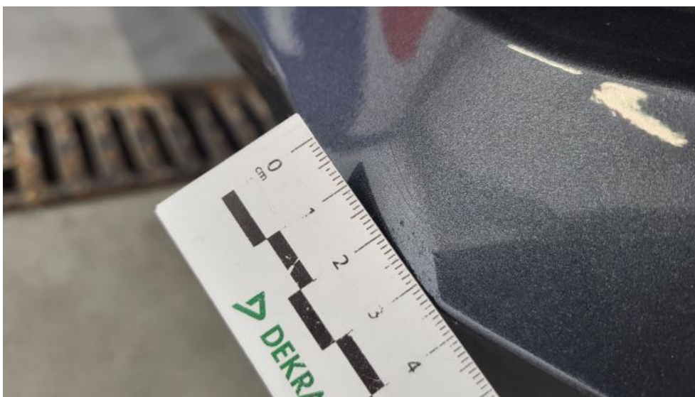
Fot. 39. Zderzak - Pęknięcie/rozerwanie 1
