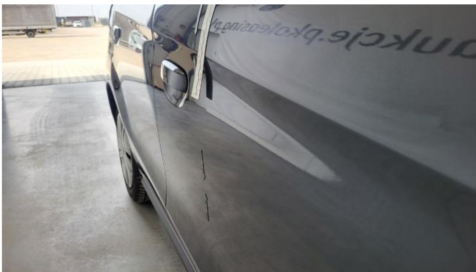
Fot. 43. Drzwi przednie P - Wgniecenie/odkształcenie 1
