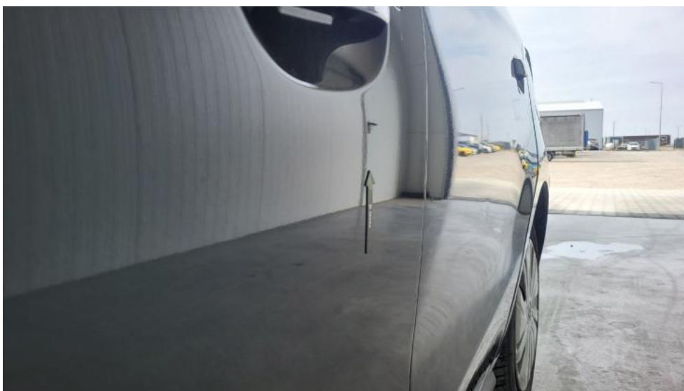
Fot. 54. Drzwi przed L - Wgniecenie/odkształcenie 1
