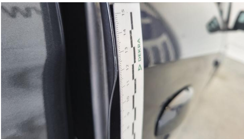
Fot. 44. Drzwi tylne P - Rysa/odprysk 1
