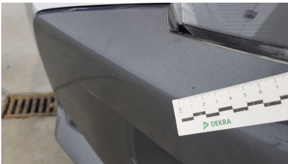
Fot. 37. Zderzak - Rysa/odprysk 1
