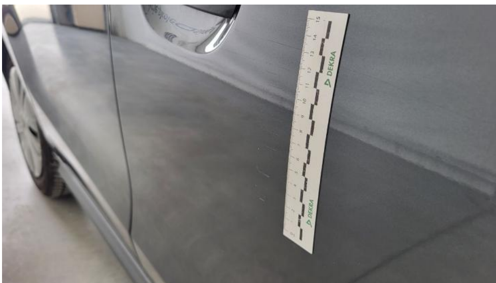
Fot. 42. Drzwi przednie P - Rysa/odprysk 1
