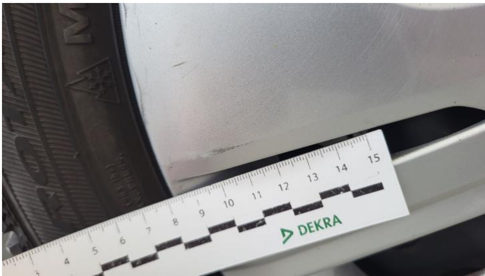
Fot. 41. Kołpak przedni P - Rysa/odprysk 1
