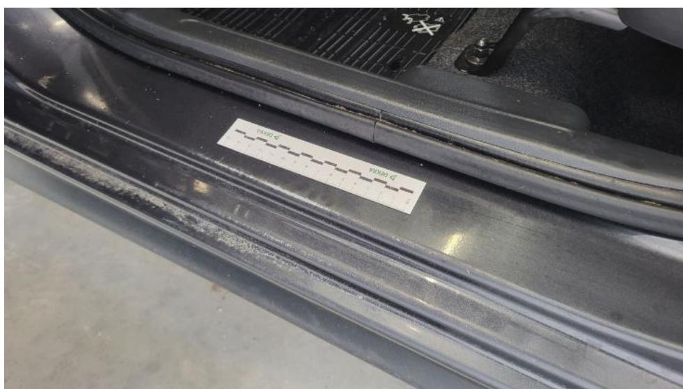
Fot. 58. Próg L - Rysa/odprysk 1
