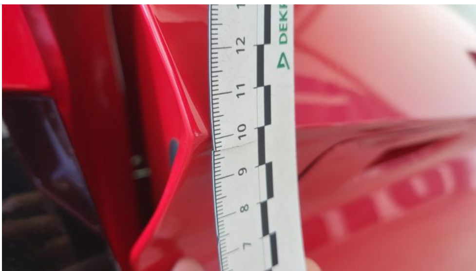
Fot. 62. Drzwi przednie P - Rysa/odprysk 1
