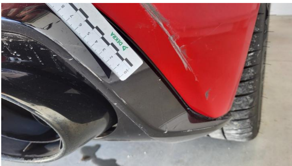
Fot. 69. Zderzak tylny cz P - Rysa/odprysk 1
