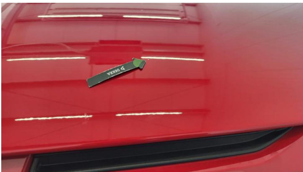
Fot. 58. Pokrywa komory silnika - Wgniecenie/odkształcenie 1
