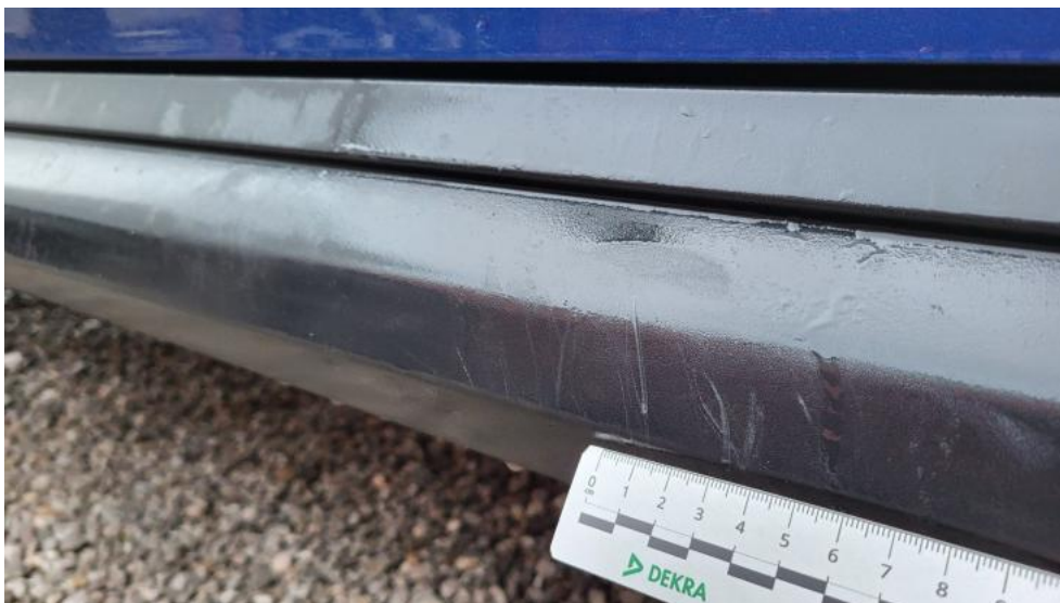
Photo 51. Próg L - Rysa/odprysk 1
