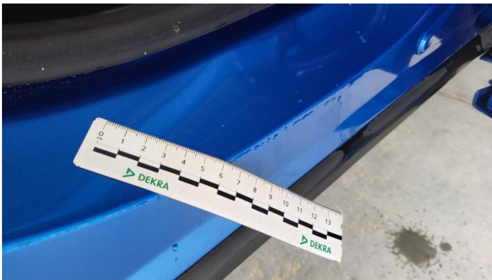
Photo 45. Próg P - Rysa/odprysk 1
