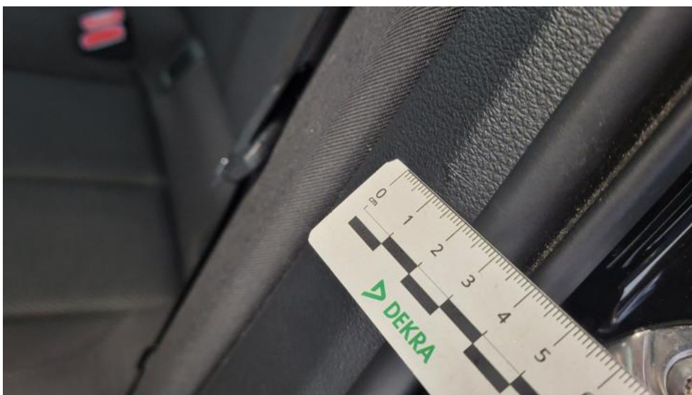
Fot. 68. Wykładzina(y) słupka tylnego L - Rysa/odprysk 1
