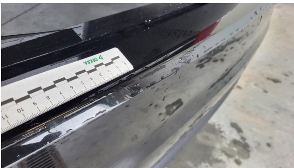
Fot. 52. Zderzak tylny - Rysa/odprysk 2
