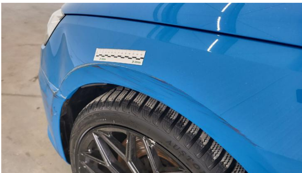
Fot. 92. Błotnik przedni L - Rysa/odprysk 1
