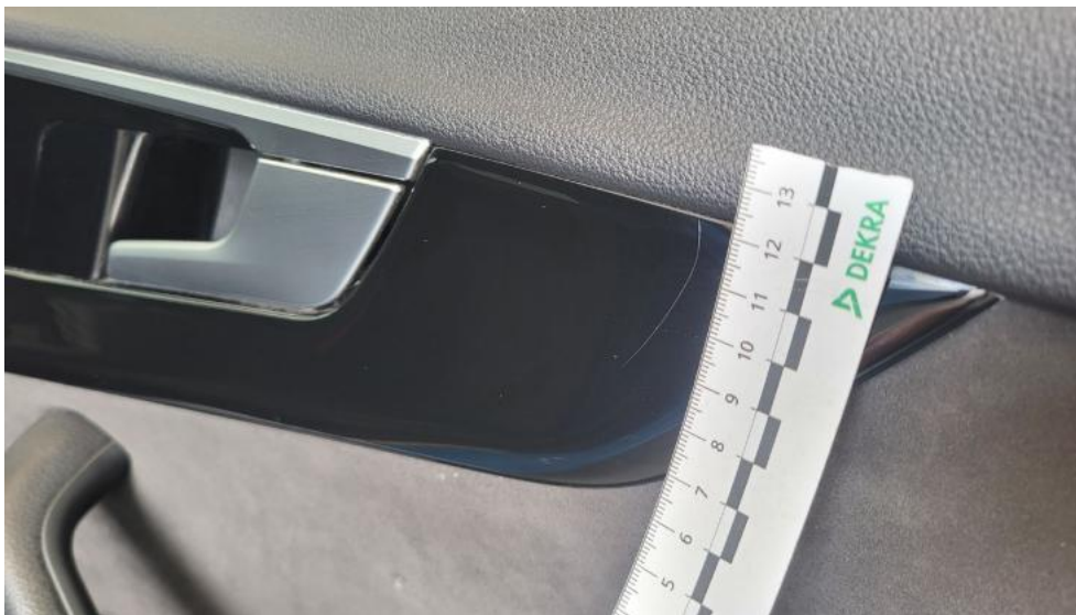
Fot. 99. Tapicerka drzwi przednich P - Rysa/odprysk 1
