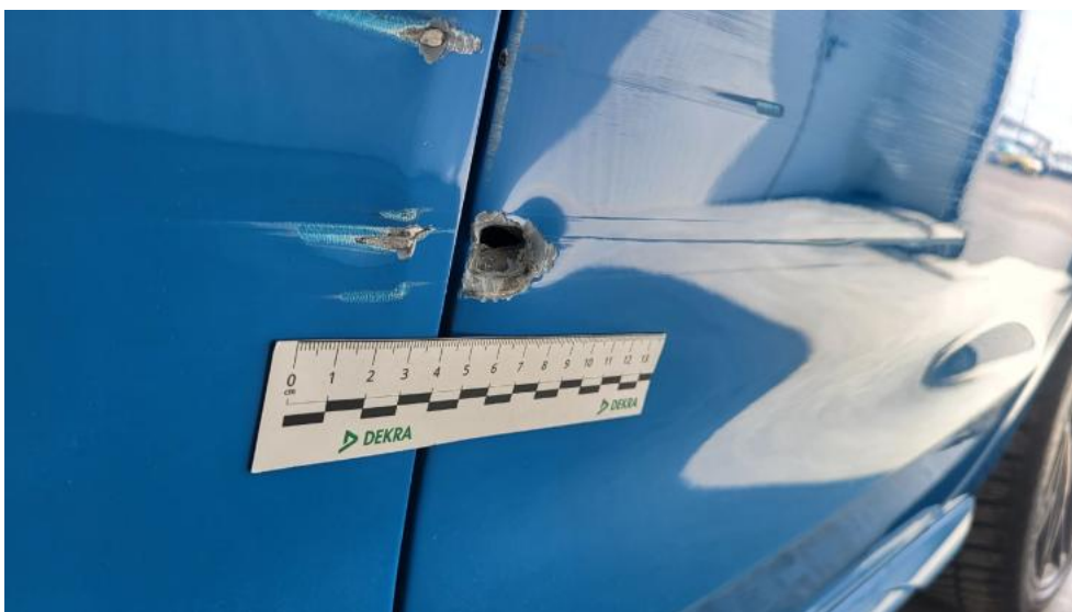
Fot. 84. Drzwi tylne L - Pęknięcie/rozerwanie 1
