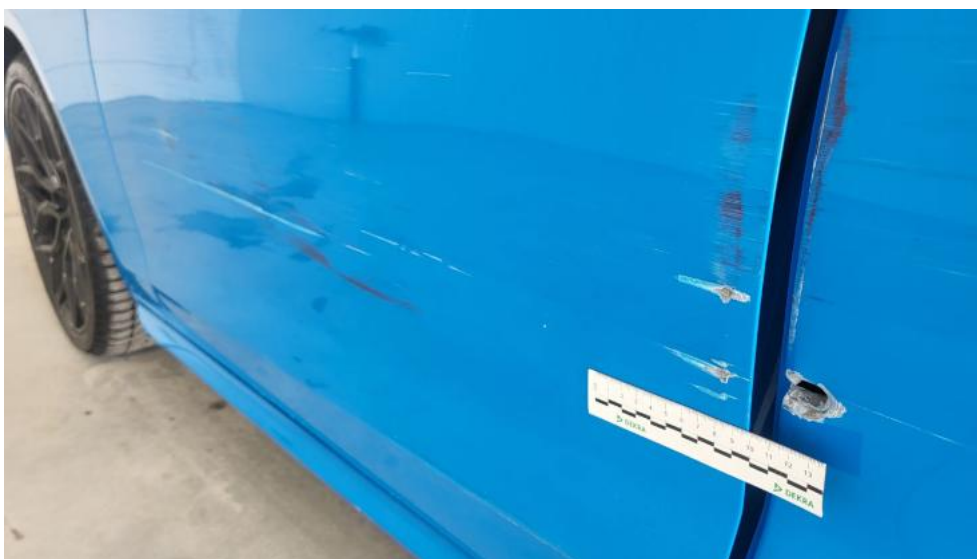
Fot. 79. Drzwi przed L - Rysa/odprysk 1
