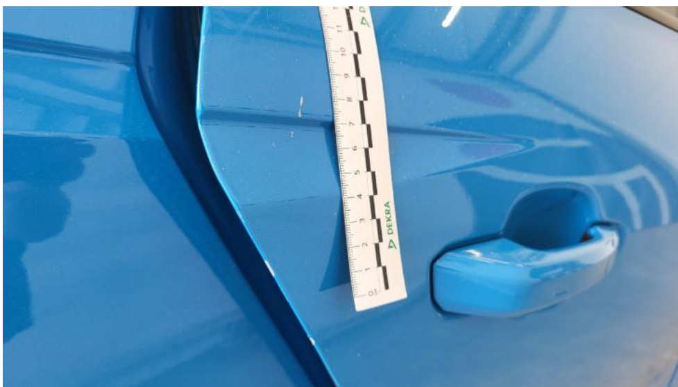
Fot. 60. Drzwi tylne P - Rysa/odprysk 1
