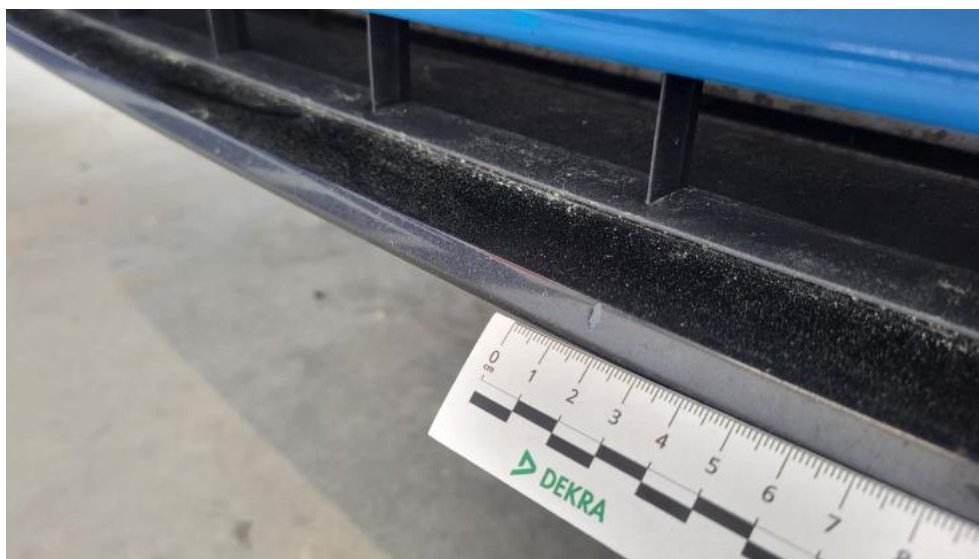
Fot. 47. Spoiler zderzaka przedniego - Rysa/odprysk 1
