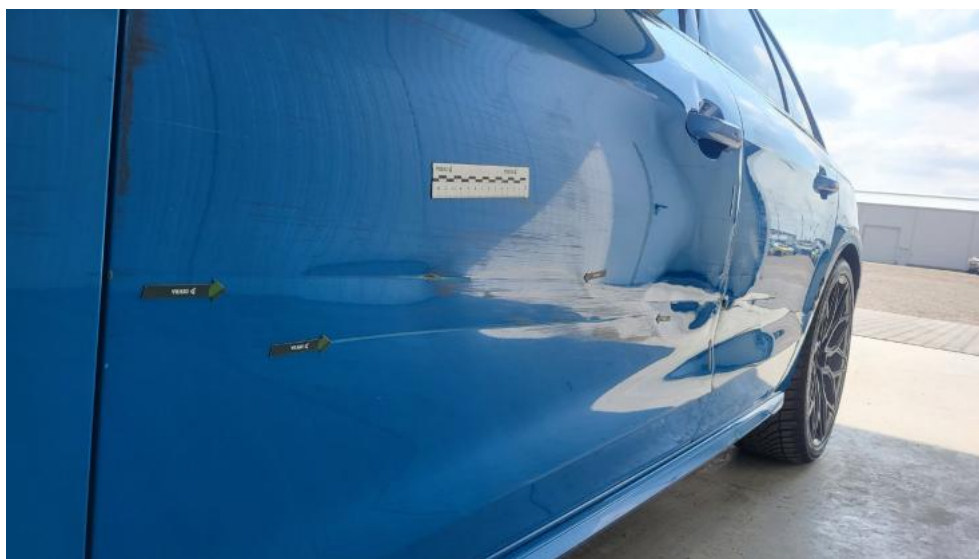
Fot. 81. Drzwi przed L - Wgniecenie/odkształcenie 2
