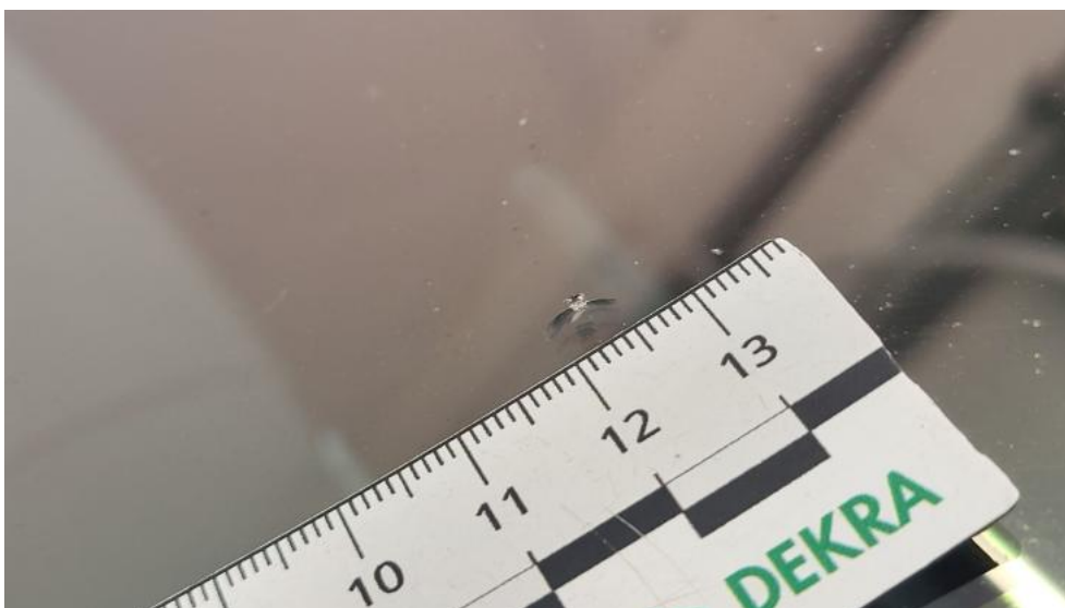
Fot. 50. Szyba czołowa - Pęknięcie/rozerwanie 1
