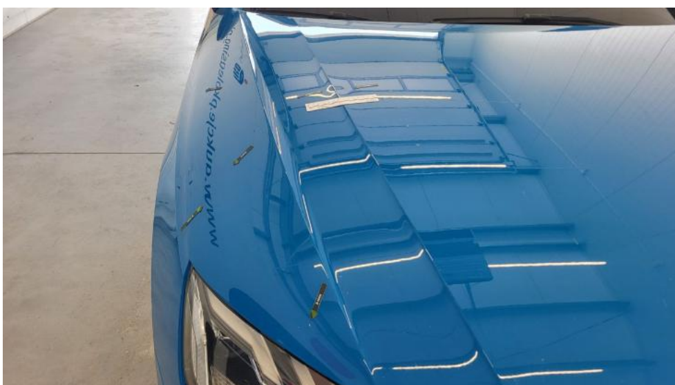
Fot. 44. Pokrywa komory silnika - Wgniecenie/odkształcenie 1
