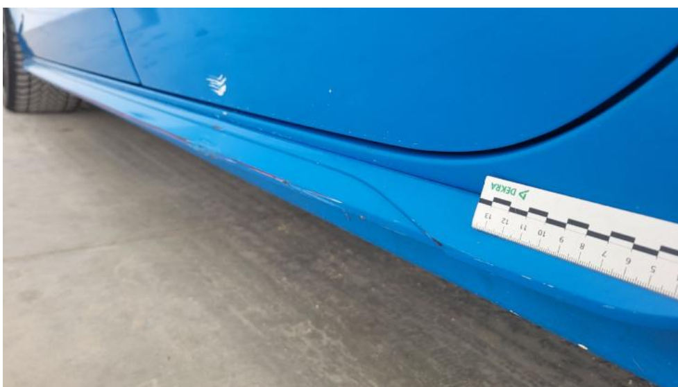
Fot. 88. Próg L - Rysa/odprysk 1
