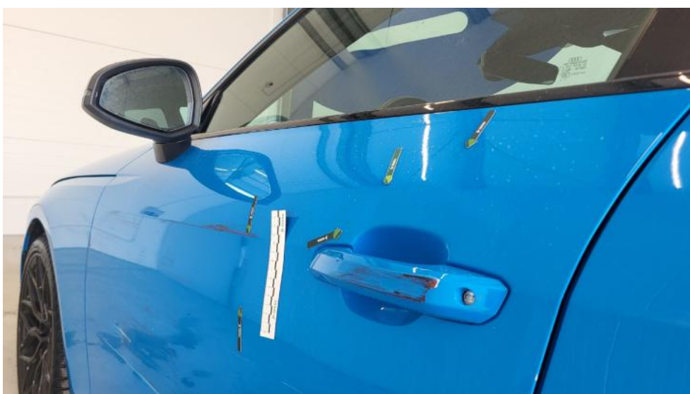
Fot. 80. Drzwi przed L - Wgniecenie/odkształcenie 1
