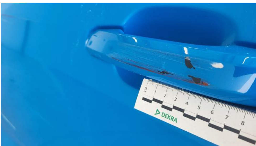
Fot. 86. Klamka drzwi tyl L - Rysa/odprysk 1
