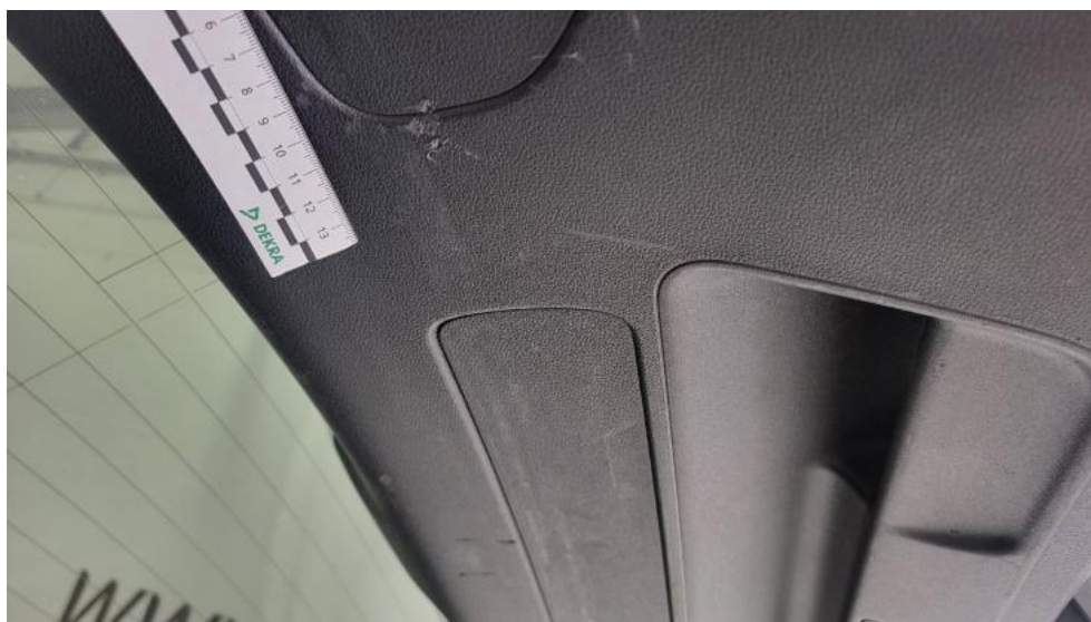
Fot. 104. Wykładzina pokrywy tylnej - Rysa/odprysk 1
