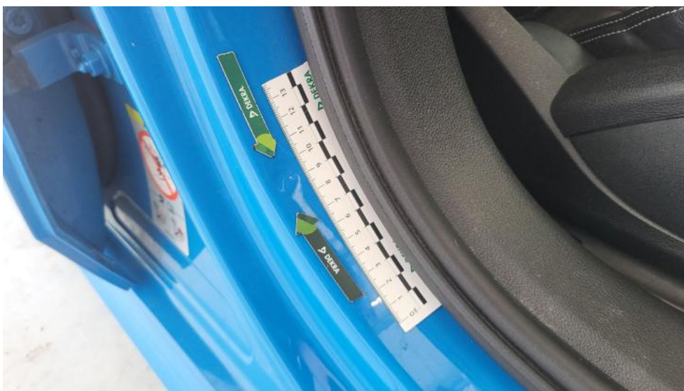
Fot. 63. Stupek środkowy P - Wgniecenie/odkształcenie 1
