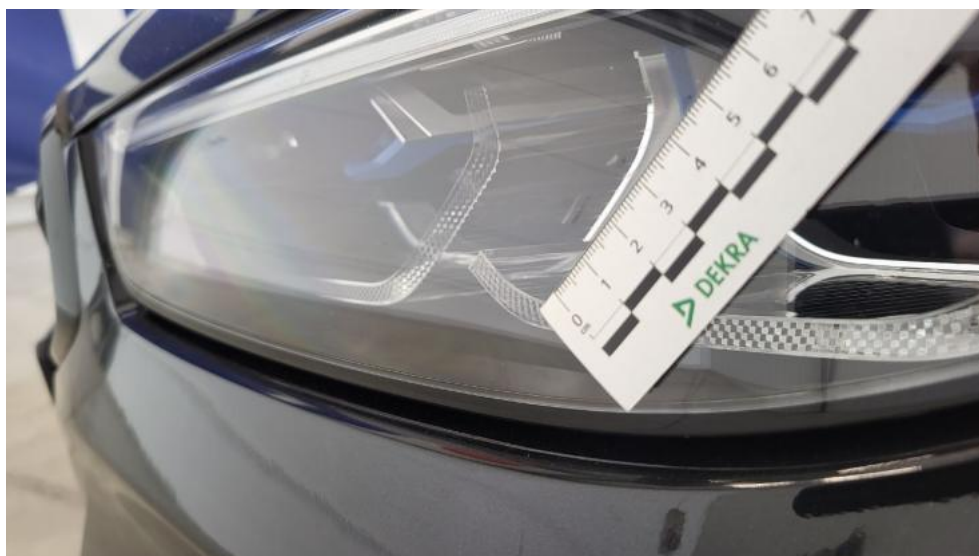
Photo 68. Reflektor L - Rysa/odprysk 1
