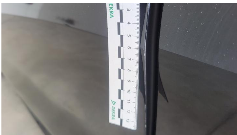
Photo 64. Drzwi przed L - Rysa/odprysk 1
