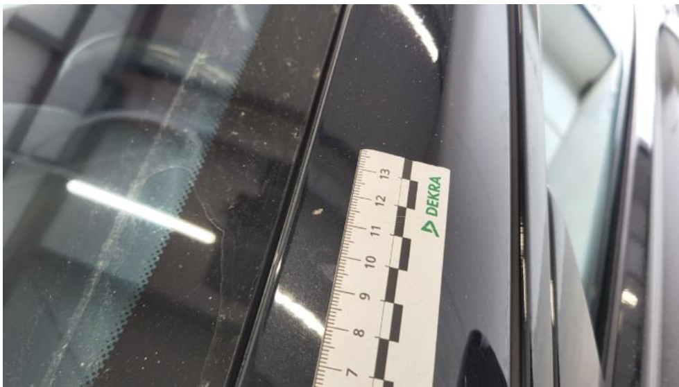
Photo 65. Stupek przedni L - Rysa/odprysk 1
