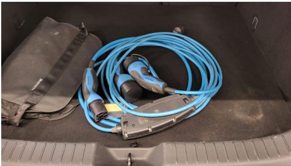
Fot. 35. Przewód ładowania baterii trakcyjnej
