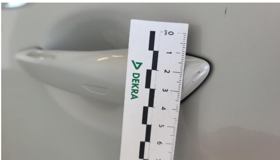
Fot. 67. Klamka drzwi prz L - Rysa/odprysk 1
