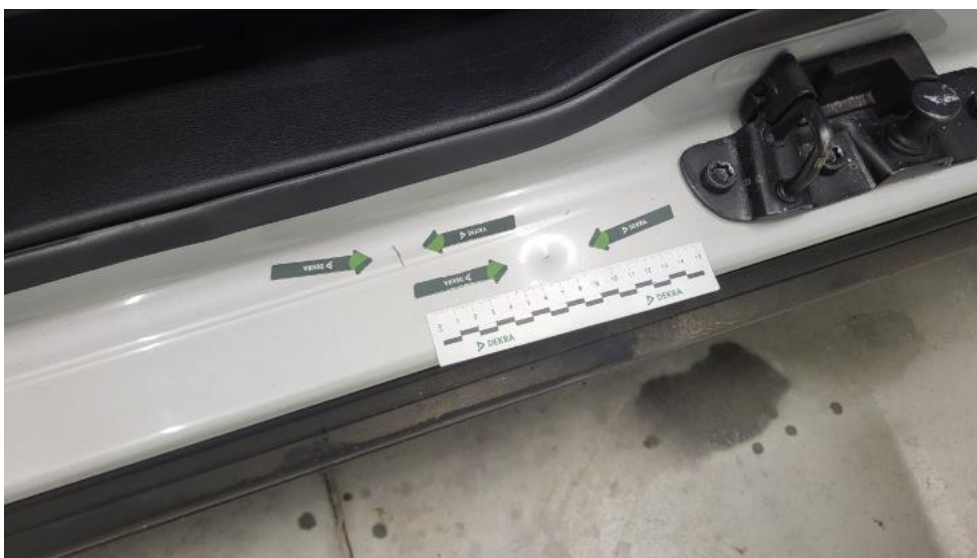
Fot. 70. Próg L - Wgniecenie/odkształcenie 1
