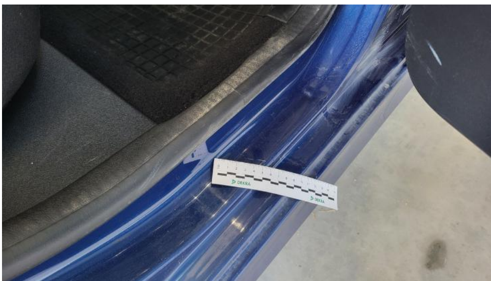
Fot. 51. Próg P - Rysa/odprysk 1
