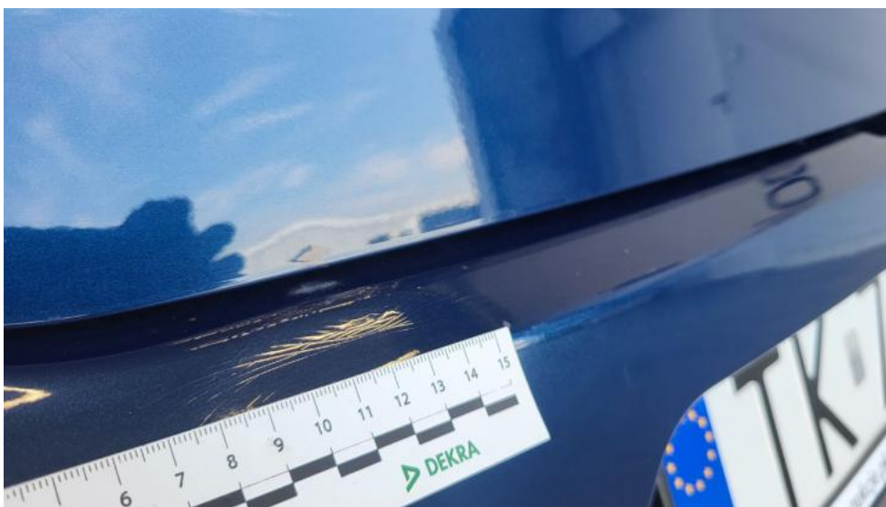
Fot. 61. Zderzak tylny - Pęknięcie/rozerwanie 1
