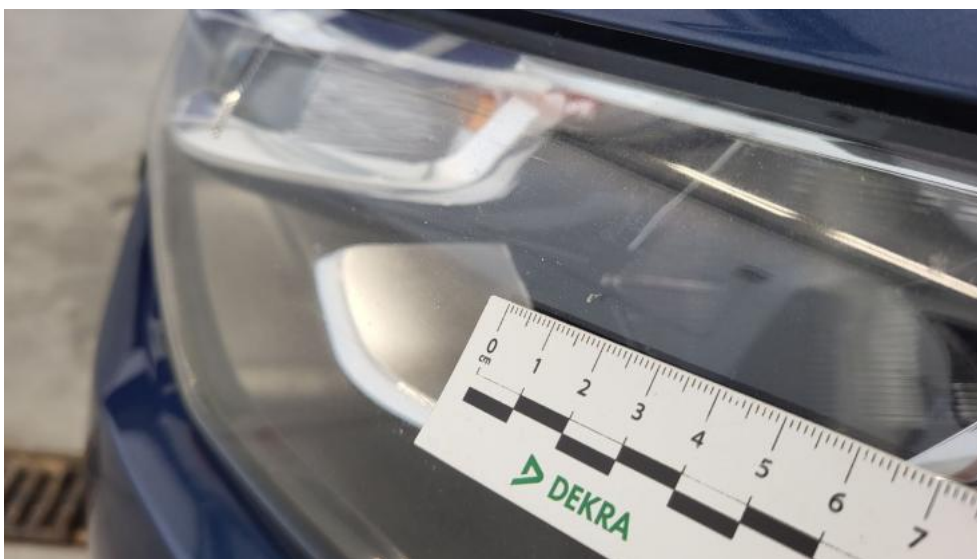
Fot. 77. Reflektor L - Rysa/odprysk 1
