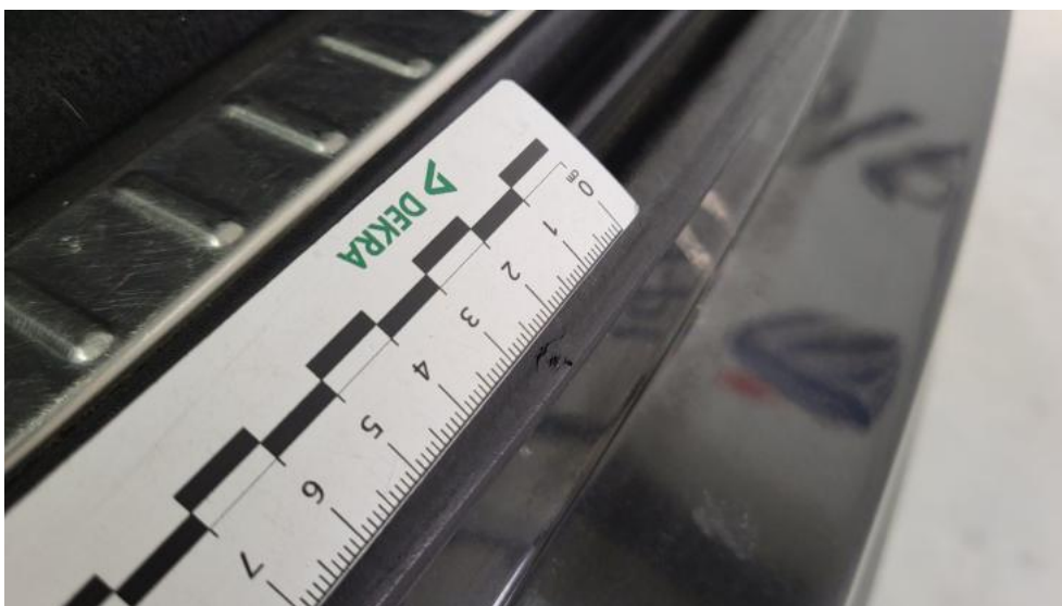
Fot. 134. Uszczelka pokrywy tylnej - Pęknięcie/rozerwanie 1
