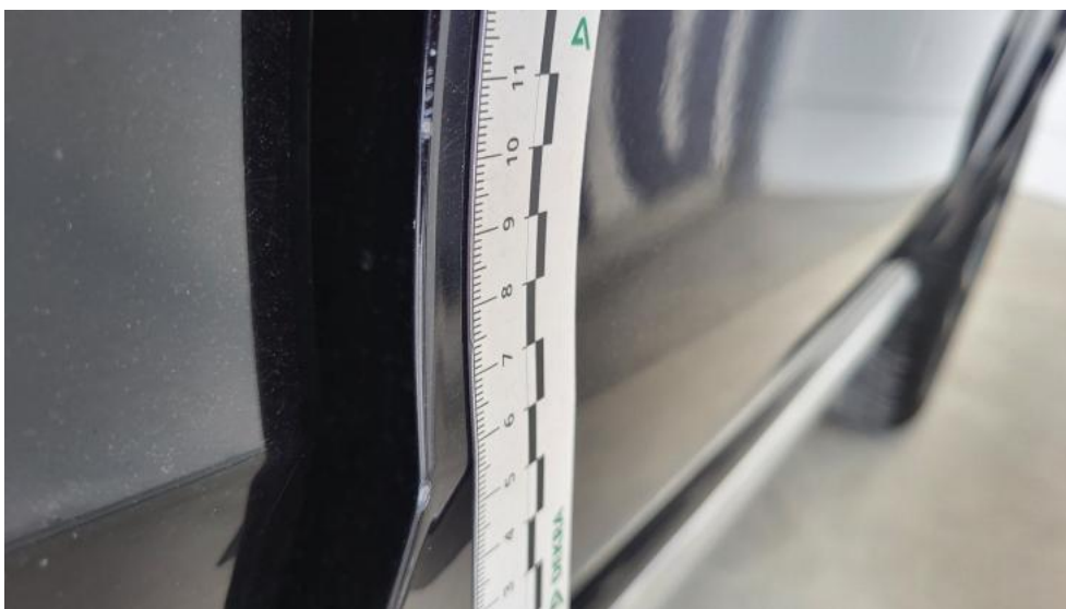
Fot. 64. Drzwi przednie P - Rysa/odprysk 1
