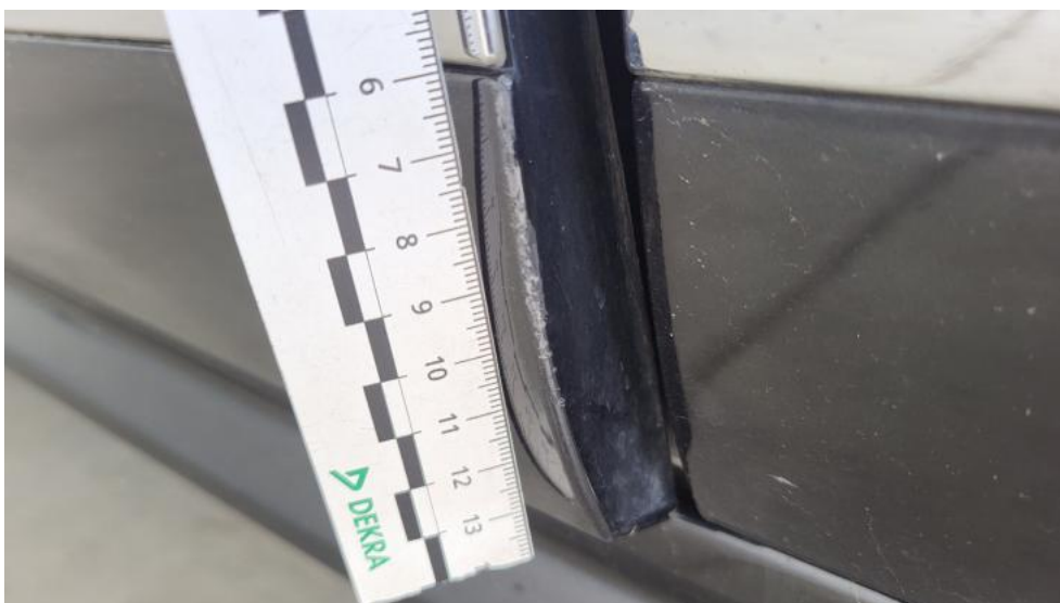
Fot. 112. Listwa drzwi przednich L - Rysa/odprysk 1
