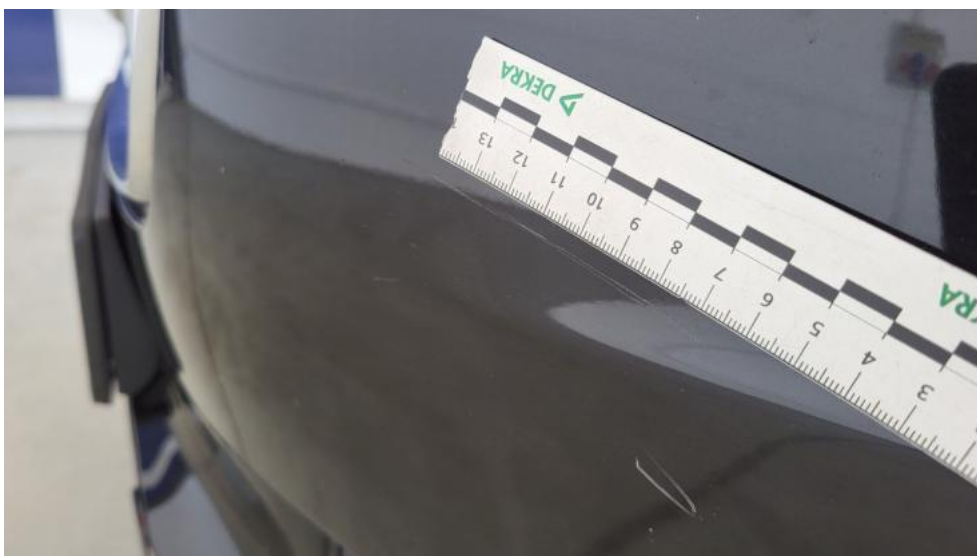
Fot. 50. Zderzak - Rysa/odprysk 1
