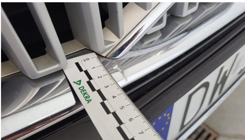
Fot. 44. Atrapa przednia - Pęknięcie/rozerwanie 1
