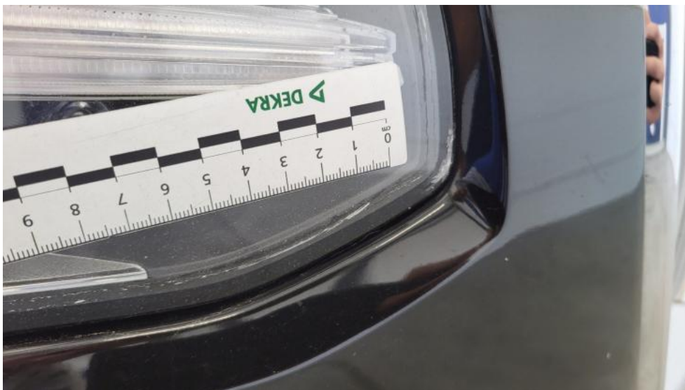
Fot. 63. Reflektor P - Pęknięcie/rozerwanie 1
