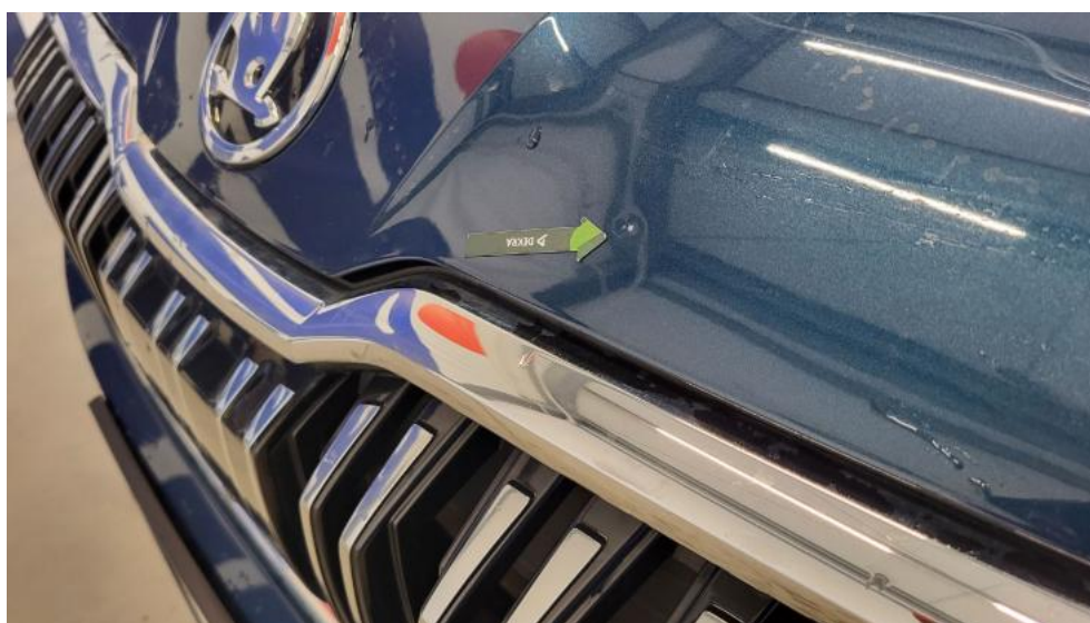
Fot. 44. Pokrywa komory silnika - Wgniecenie/odkształcenie 1
