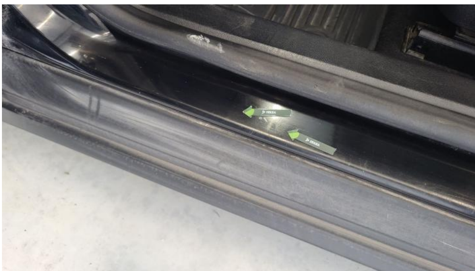
Fot. 90. Próg L - Wgniecenie/odkształcenie 1
