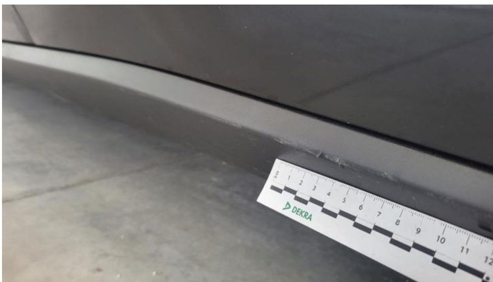
Fot. 89. Próg L - Rysa/odprysk 1
