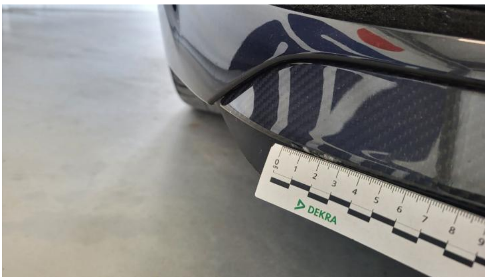
Photo 54. Listwa śr zderzaka przedniego - Rysa/odprysk 1
