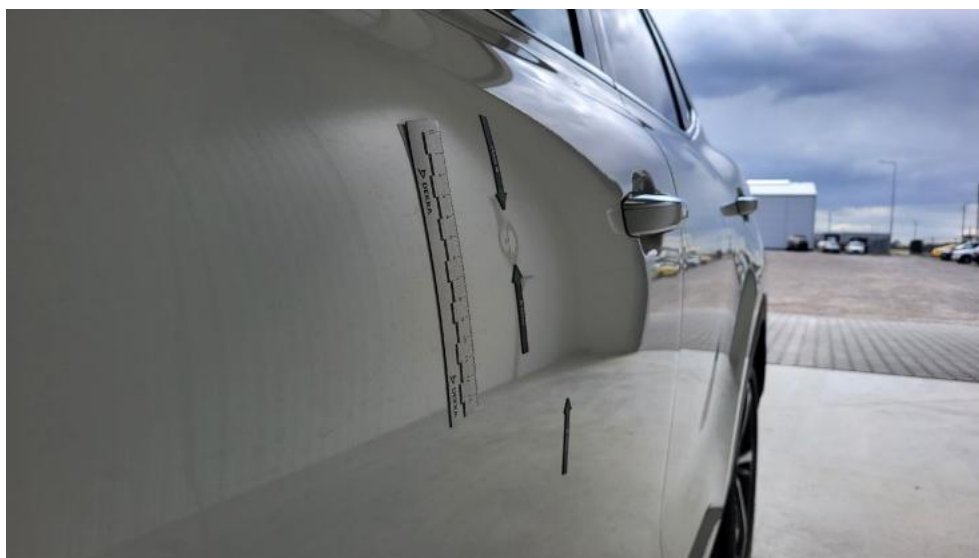
Fot. 50. Drzwi przed L - Wgniecenie/odkształcenie 1
