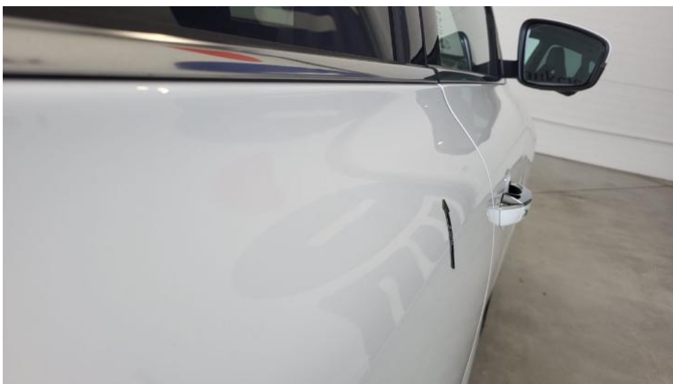
Fot. 44. Drzwi tylne P - Wgniecenie/odkształcenie 1
