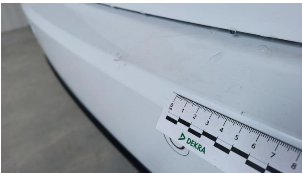
Fot. 46. Zderzak tylny - Rysa/odprysk 1
