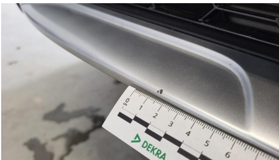
Fot. 40. Spoiler zderzaka przedniego - Rysa/odprysk 1
