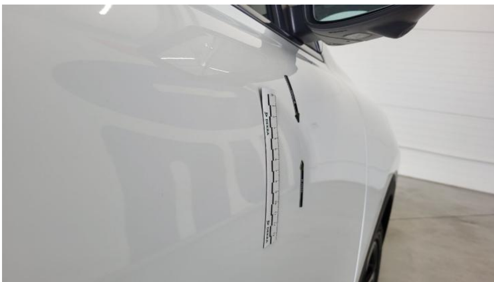
Fot. 42. Drzwi przednie P - Wgniecenie/odkształcenie 1
