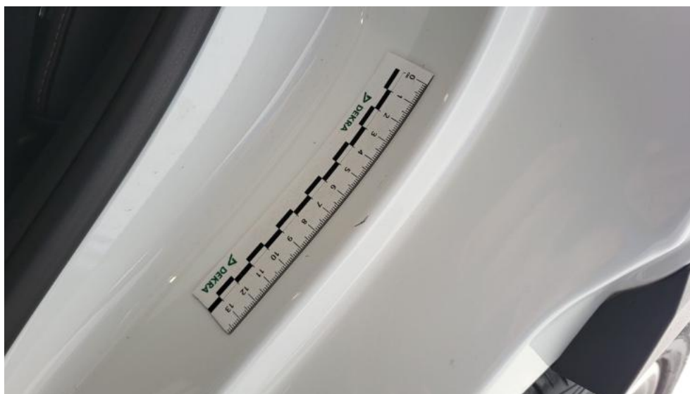
Fot. 47. Błotnik tylny L / Ściana boczna L - Rysa/odprysk 1
