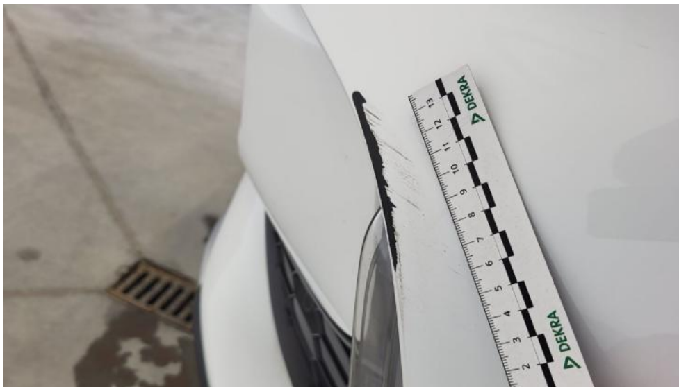
Fot. 41. Zderzak - Rysa/odprysk 1
