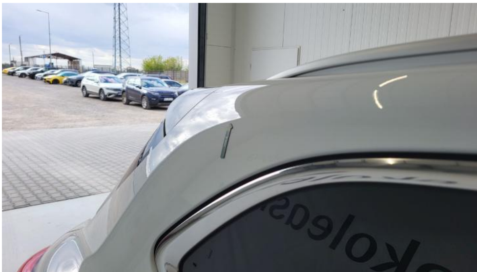
Fot. 45. Błotnik tylny P / Ściana boczna P - Wgniecenie/odkształcenie 1
