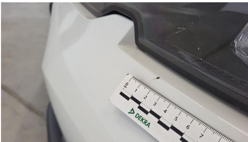
Fot. 41. Zderzak - Rysa/odprysk 1
