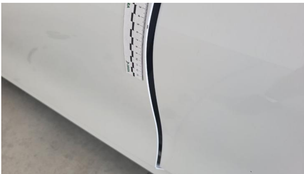
Fot. 53. Drzwi przed L - Rysa/odprysk 1
