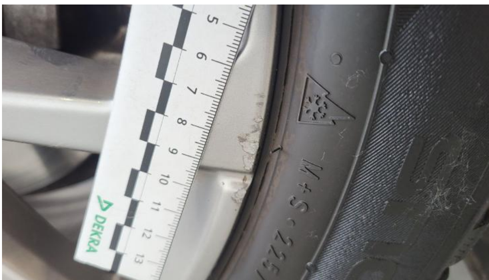
Fot. 49. Felga aluminiowa tylna P - Rysa/odprysk 1
