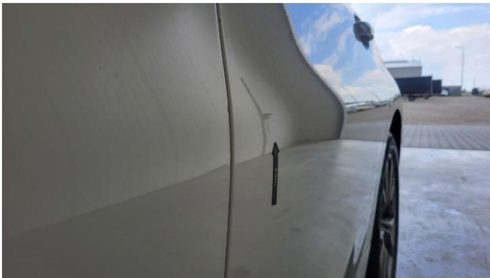
Fot. 55. Drzwi tylne L - Wgniecenie/odkształcenie 1
