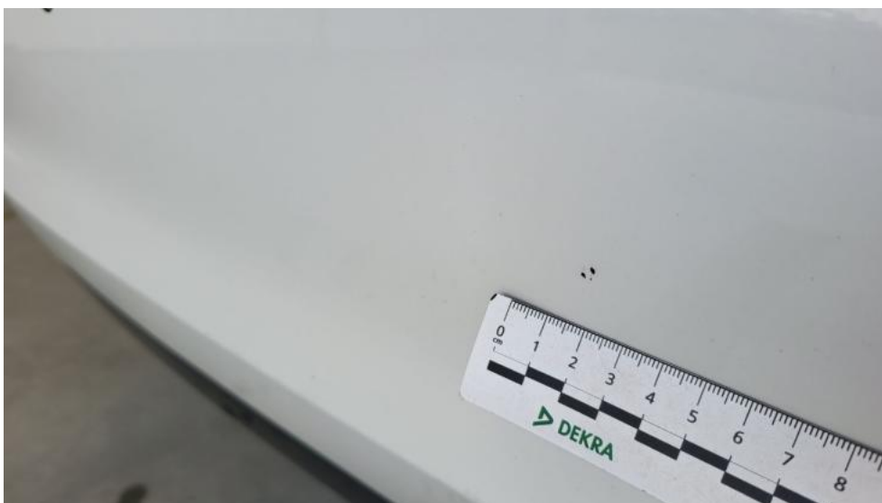
Fot. 50. Zderzak tylny - Rysa/odprysk 1
