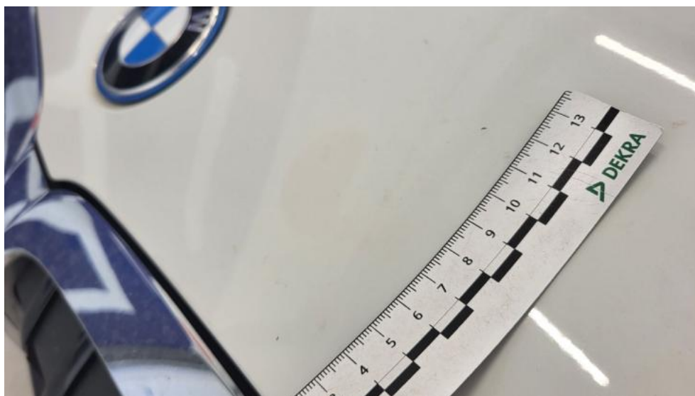
Fot. 40. Pokrywa komory silnika - Rysa/odprysk 1
