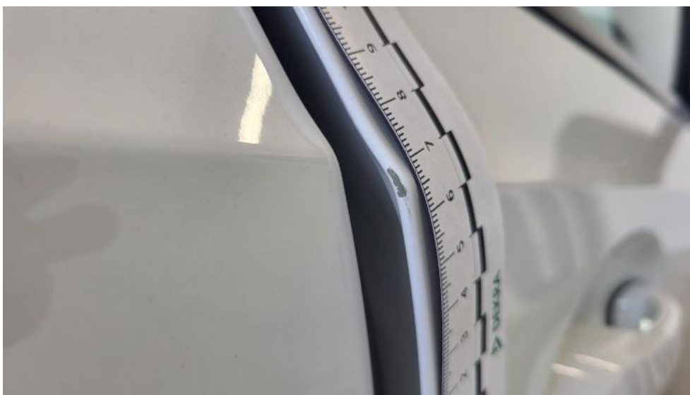
Fot. 43. Drzwi przednie P - Rysa/odprysk 1
