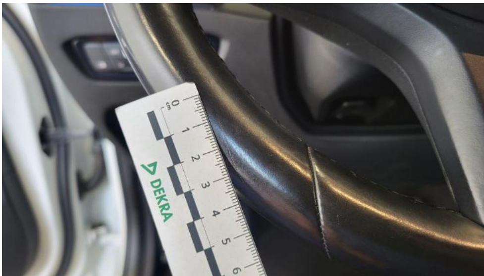
Fot. 59. Koło kierownicy - Rysa/odprysk 1
