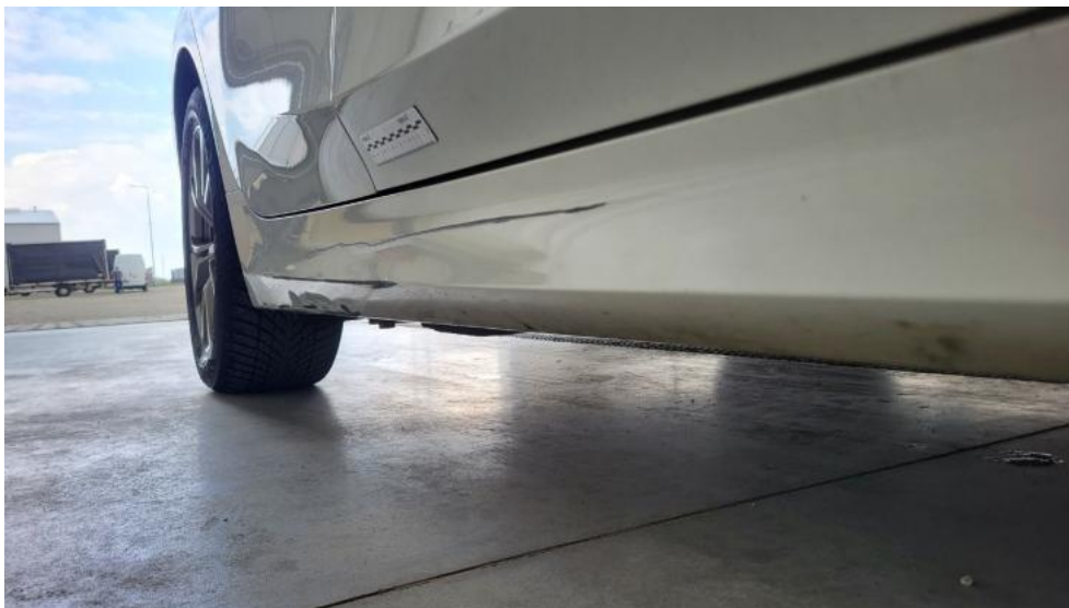
Fot. 47. Próg P - Wgniecenie/odkształcenie 1
