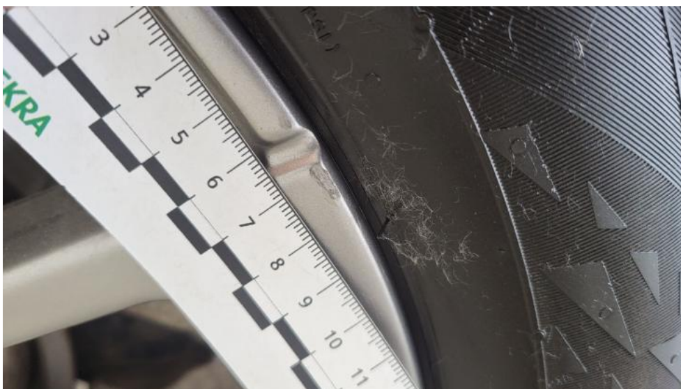
Fot. 58. Felga Aluminiowa przednia L - Rysa/odprysk 1
