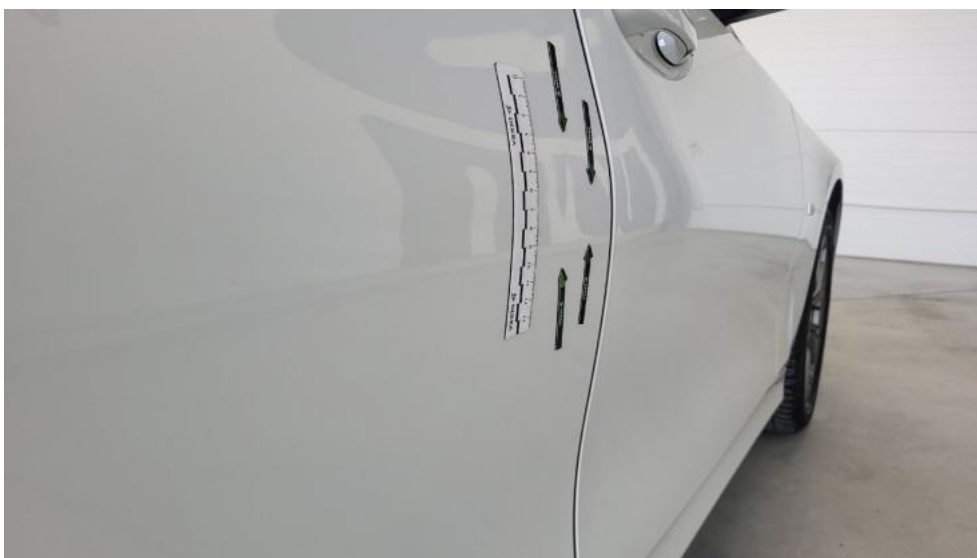
Fot. 44. Drzwi tylne P - Wgniecenie/odkształcenie 1
