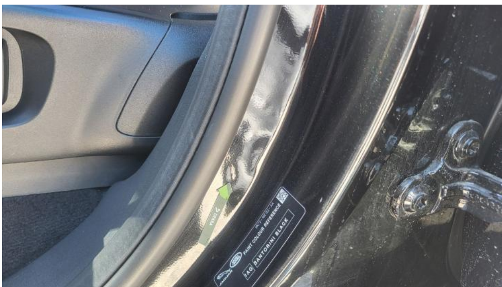
Photo 76. Słupek środkowy L - Wgniecenie/odkształcenie 1
