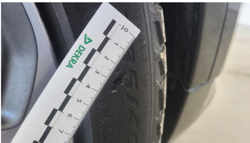
Photo 55. Opona przednia P - Pęknięcie/rozerwanie 1
