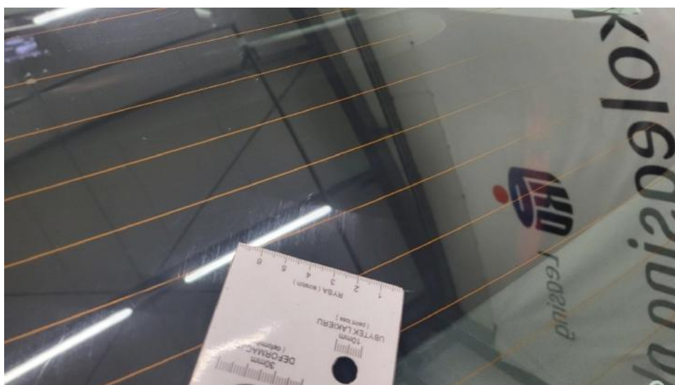
Fot. 38. Szyba tylna (Rysa/Odprysk)
