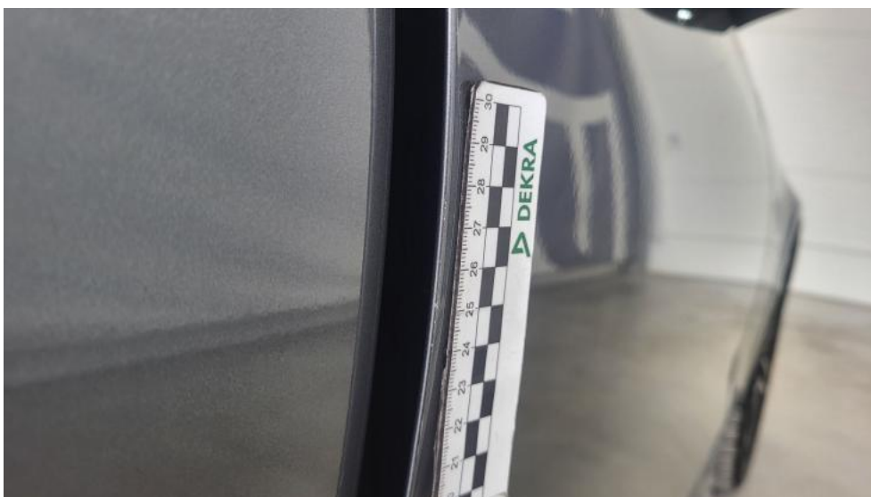
Fot. 42. Drzwi przednie P - Rysa/odprysk 1
