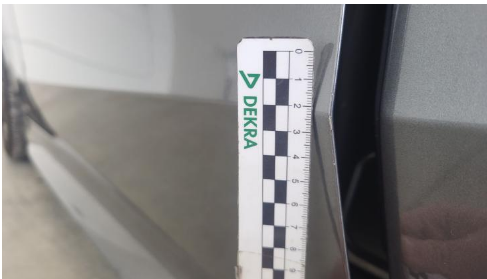
Fot. 45. Drzwi przed L - Rysa/odprysk 1
