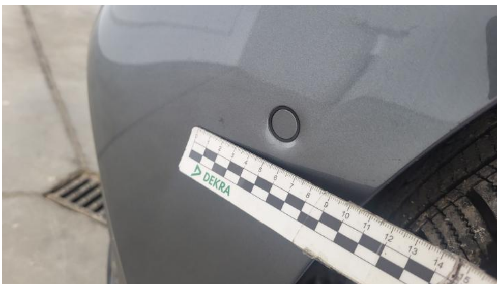
Fot. 41. Zderzak - Rysa/odprysk 1
