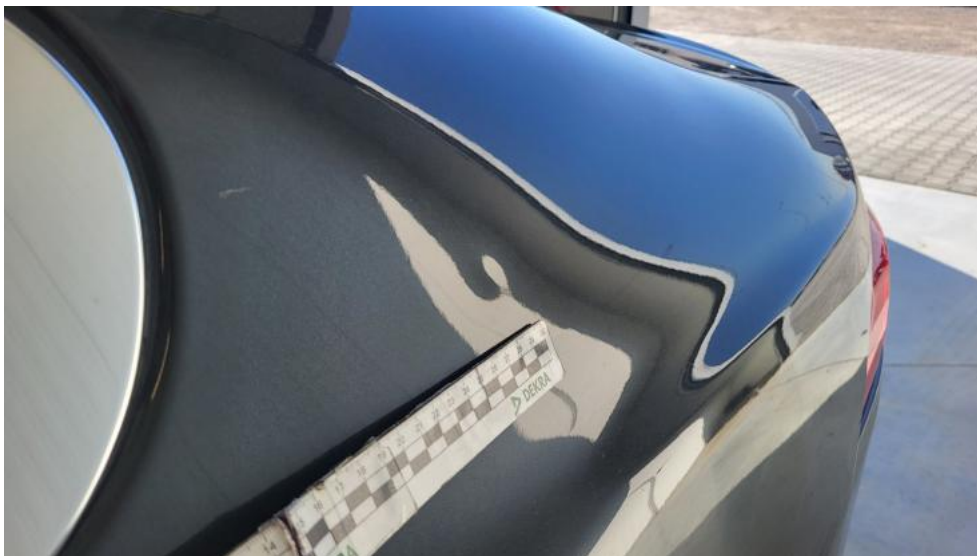
Photo 55. Błotnik tylny L / Ściana boczna L - Wgniecenie/odkształcenie 2
