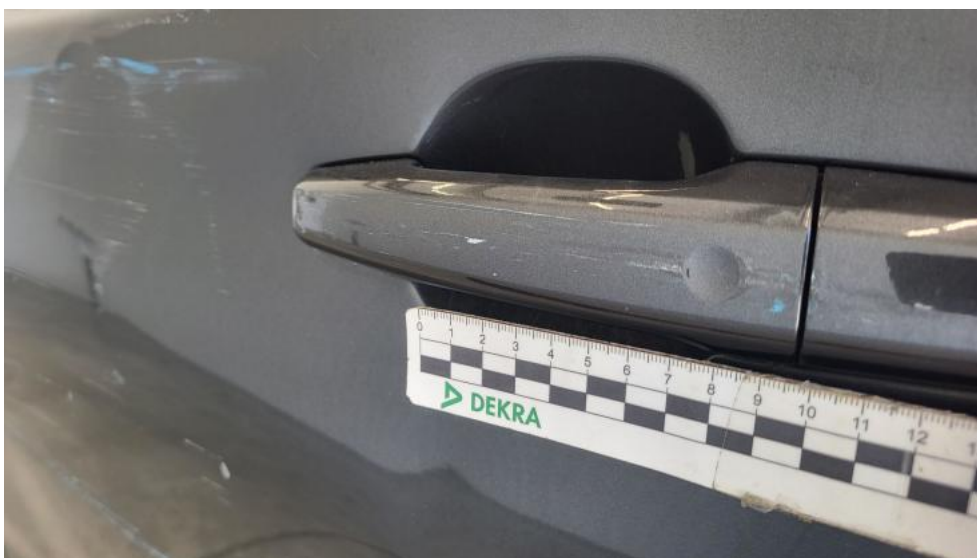
Photo 62. Klamka drzwi tyl L - Rysa/odprysk 1
