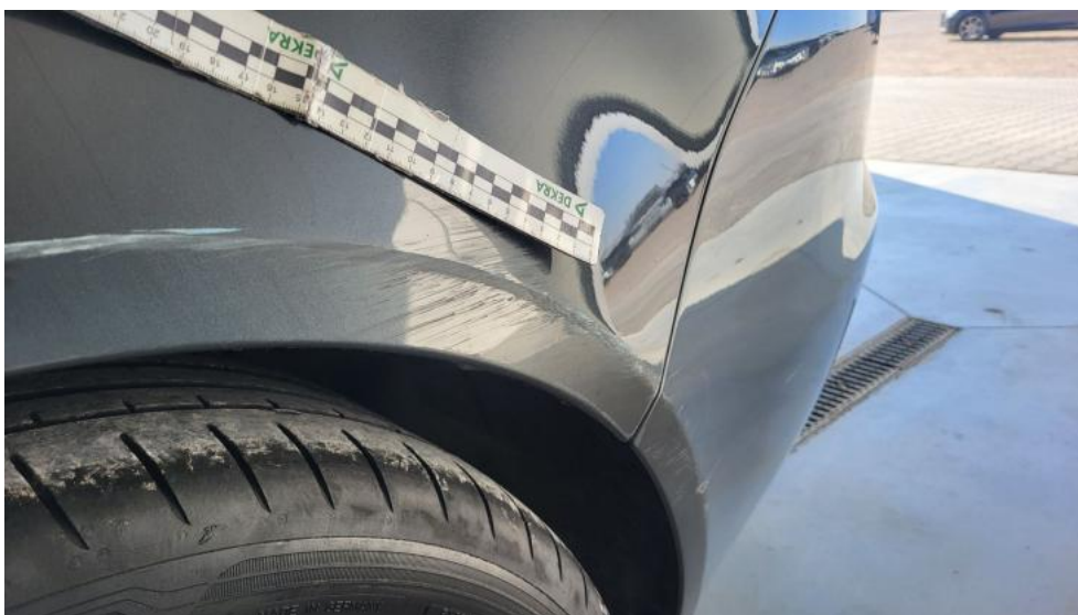
Photo 56. Błotnik tylny L / Ściana boczna L() - Wgniecenie/odkształcenie 3
