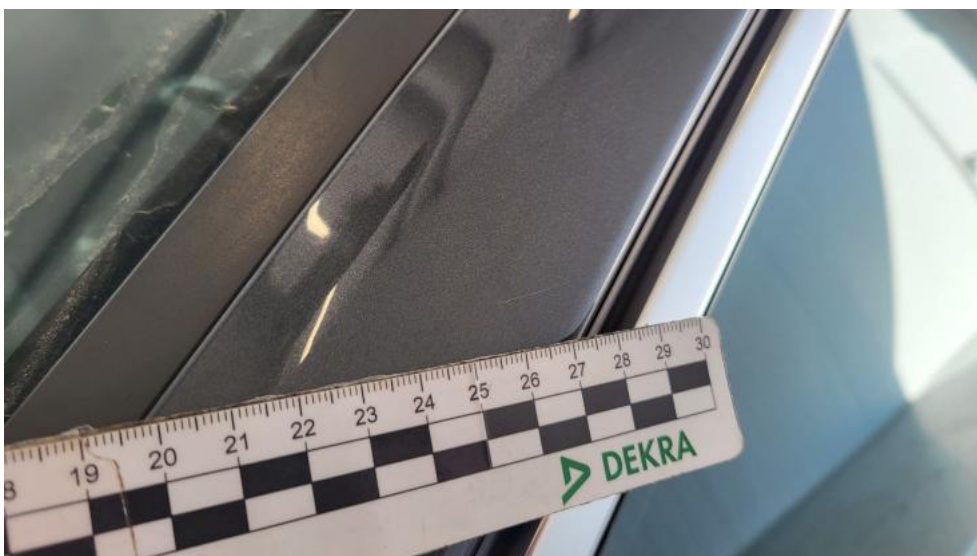
Photo 64. Słupek przedni L - Rysa/odprysk 1
