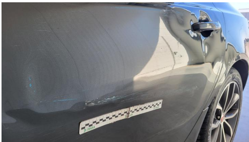
Photo 59. Drzwi tylne L - Rysa/odprysk 1
