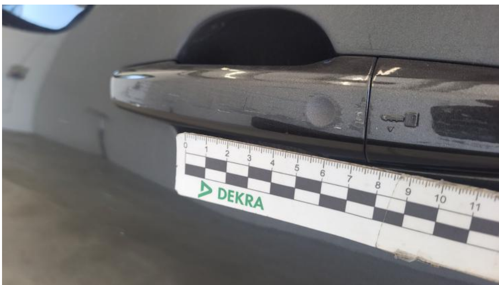
Photo 61. Klamka drzwi prz L - Rysa/odprysk 1
