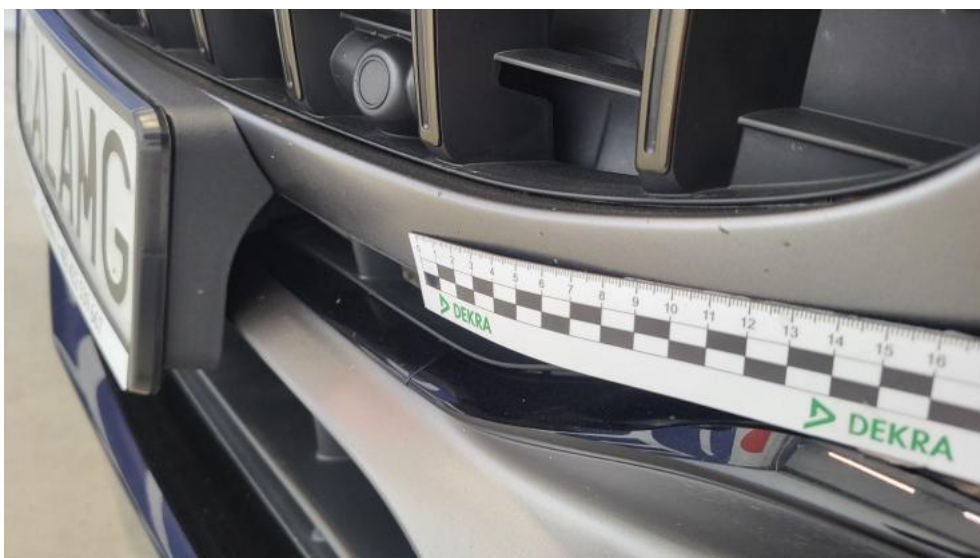
Fot. 48. Zderzak - Rysa/odprysk 1
