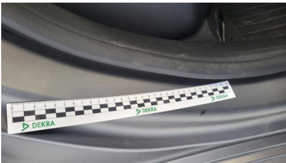
Fot. 51. Próg P - Rysa/odprysk 1
