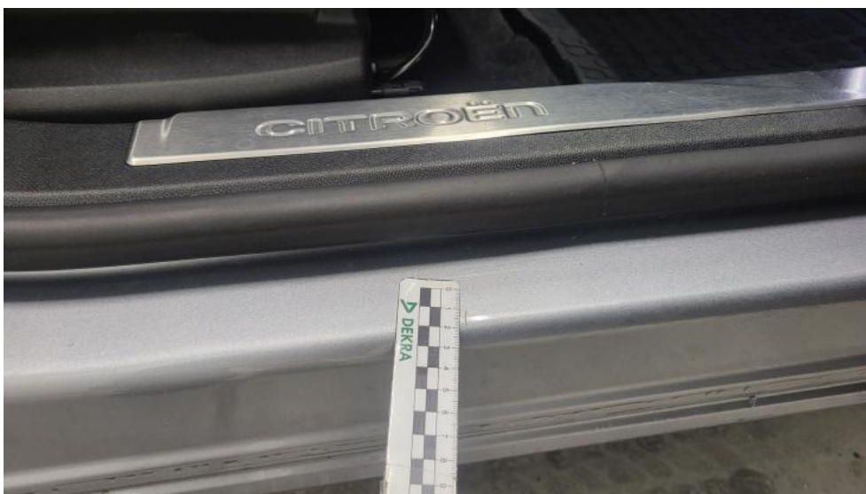
Photo 40. Próg P - Rysa/odprysk 1
