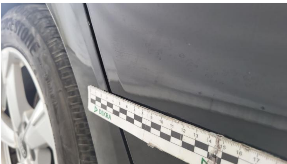
Photo 45. Drzwi tylne P - Rysa/odprysk 1
