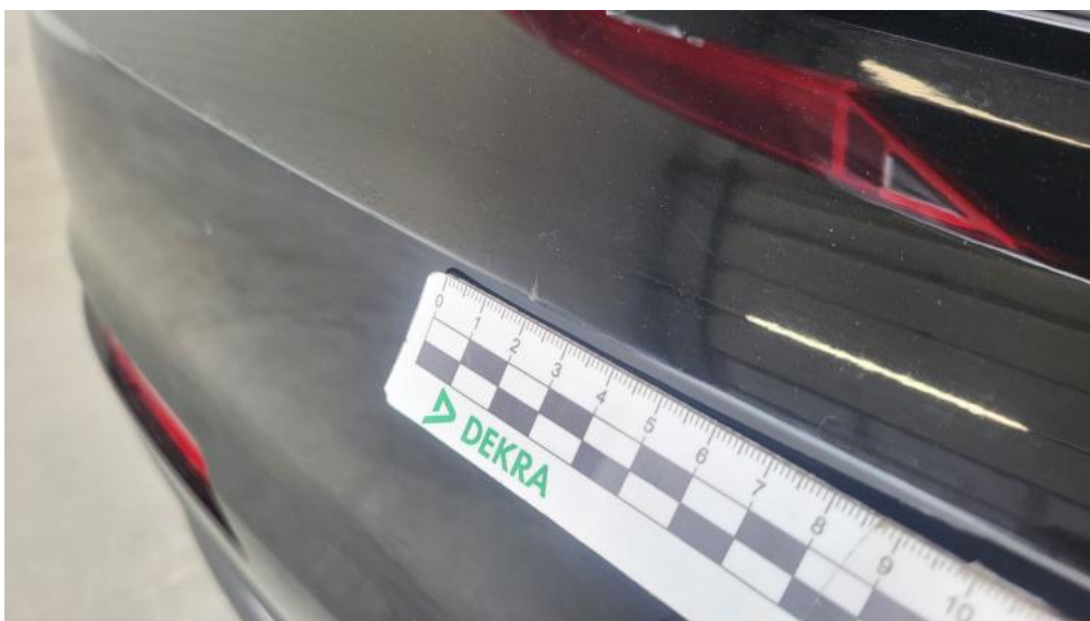
Photo 50. Zderzak tylny - Rysa/odprysk 2
