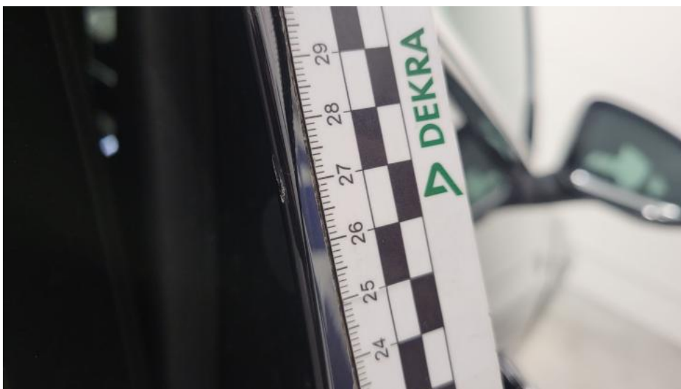
Photo 44. Drzwi przednie P - Rysa/odprysk 1
