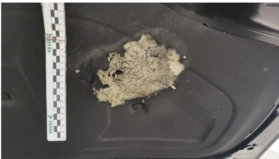
Photo 40. Wykładzina pokrywy komory silnika - Pęknięcie/rozerwanie 1
