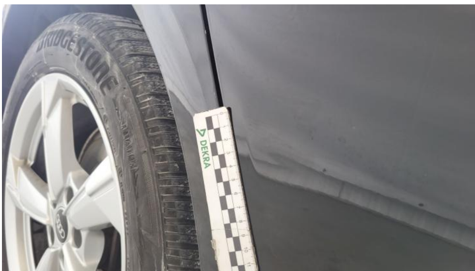
Photo 46. Drzwi tylne P - Wgniecenie/odkształcenie 1
