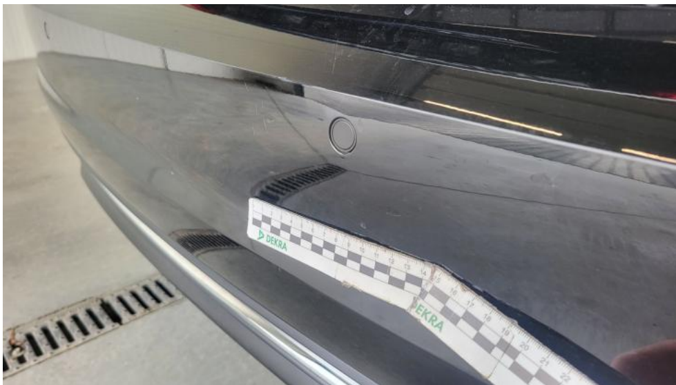
Photo 49. Zderzak tylny - Rysa/odprysk 1
