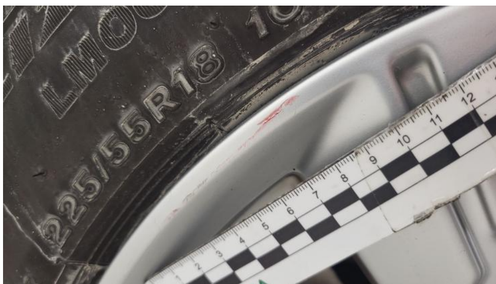
Photo 52. Felga aluminiowa tylna L - Rysa/odprysk 1
