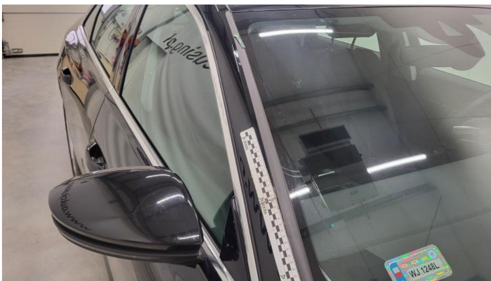
Photo 39. Uszczelka/listwa szyby czołowej - Rysa/odprysk 1
