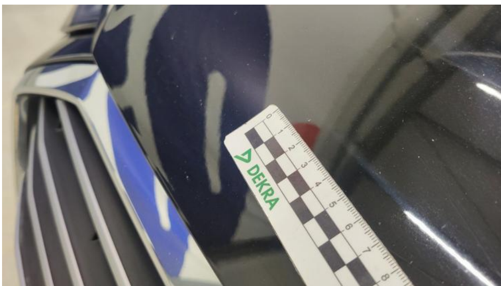
Photo 38. Pokrywa komory silnika - Rysa/odprysk 1
